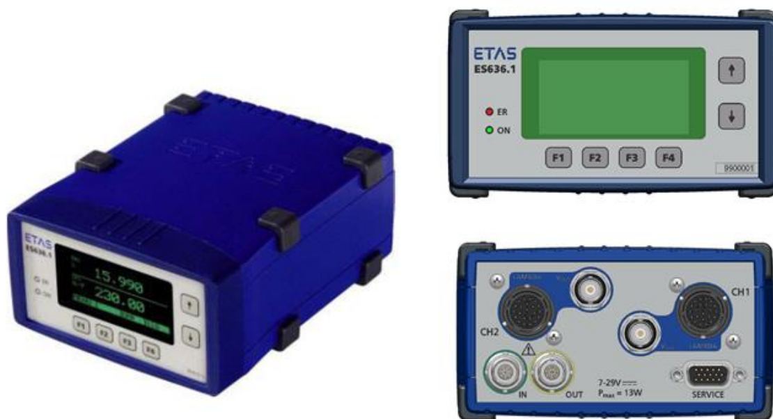
Abbildung 3.19: Allgemeine Darstellung und Frontansicht ETAS ES63x.1 (beispielhaft das ES636.1) mit Rückansicht ETAS ES631.1 [21]
