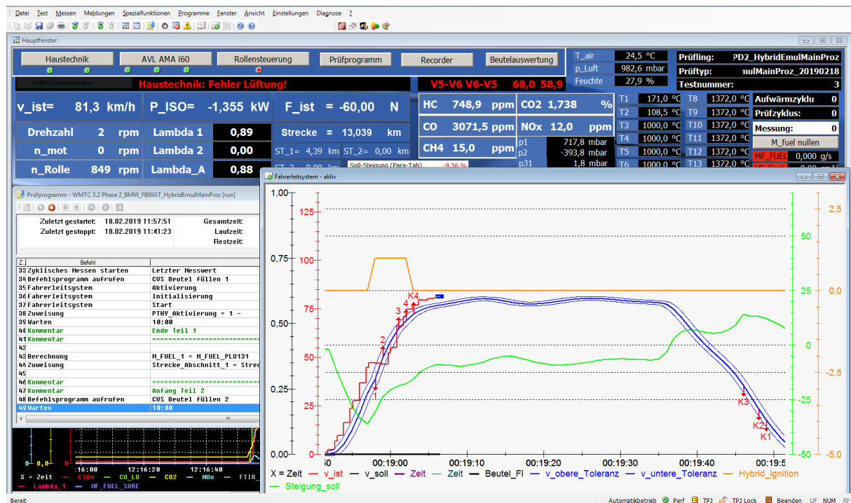
Abbildung 3.21: Konfiguration Tornado Runtime für die Hybrid-Emulation während einer Messfahrt.
