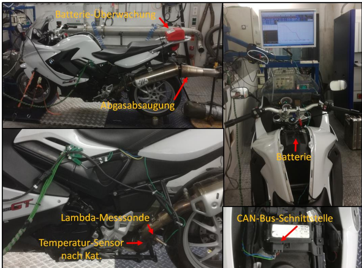
Abbildung 4.1: Prüfstandaufbau des Versuchsfahrzeugs und der verbauten Messtechnik
