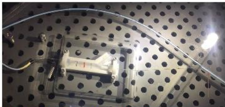
Abb. 5: Darstellung der Platzierung des Führungsdrahts
