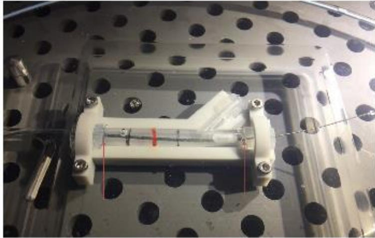
Abb. 6: Darstellung der Platzierung des Delivery Systems im Gefäßmodell
