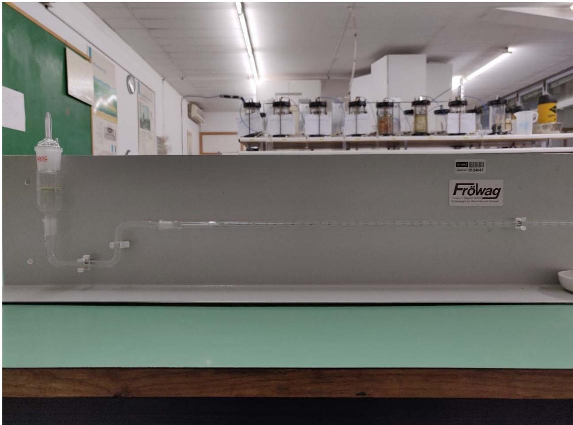
**Abb. 26:** Verwendetes Gerät – Enslin-Neff (DIN 18132)
