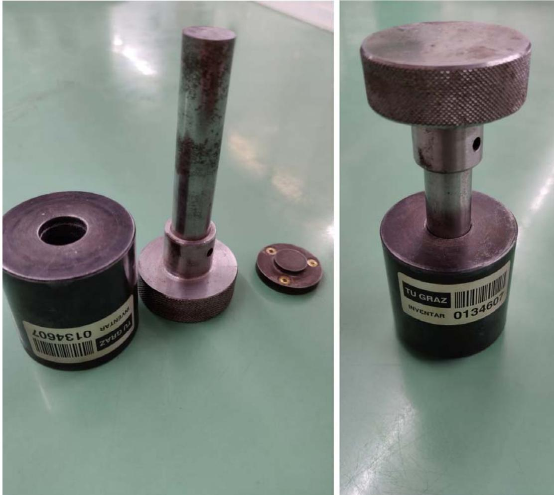
**Abb. 39:** Presswerkzeug TU Graz –von Firma Klement hergestellt
