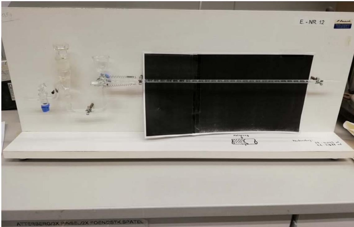
**Abb. 13:** Verwendetes Gerät – Enslin (RVS 11.062)
