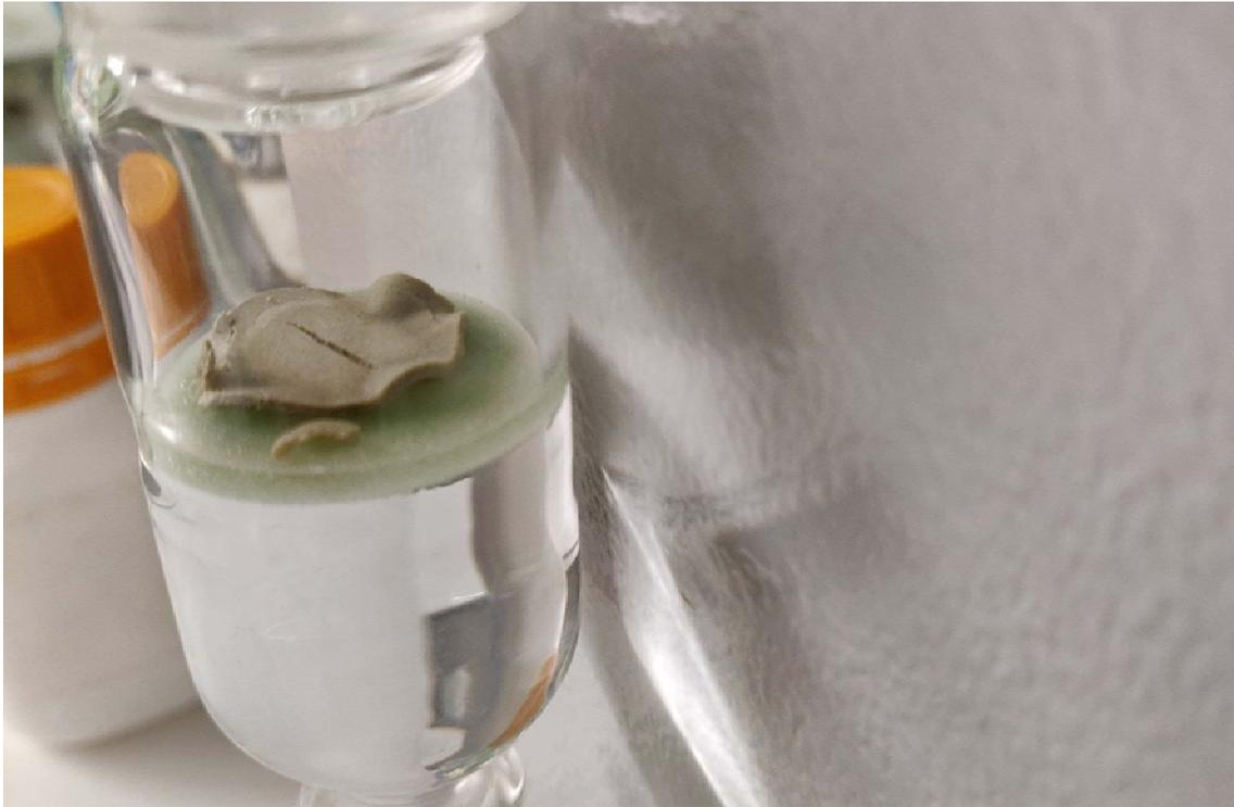
**Abb. 41:** Durchfeuchtete Bentonit Presspille
