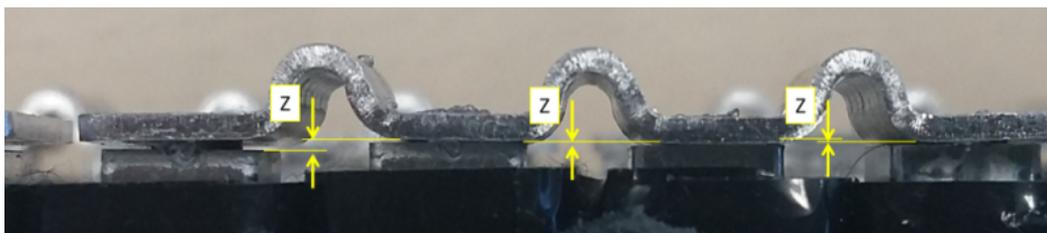
Abbildung 2-28: Maximale Höhendifferenz  $Z_{\max}$  zwischen den Zellpolen, [SDIBS, confidential]
