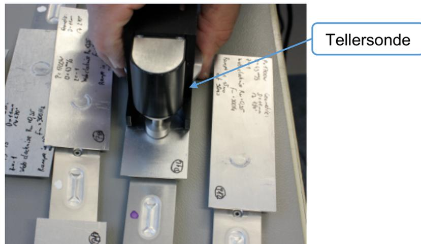
Abbildung 4-8: Rotierende Tellersonde
