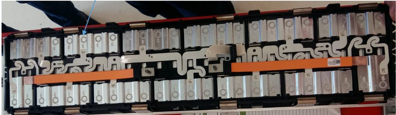
Abbildung 2-5: Zellen mit Zellverbindern verbunden (Batteriemodul) [SDIBS, confidential]
