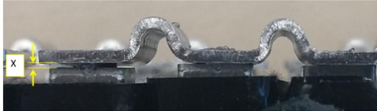
Abbildung 2-26: Maximalabstand  $X_{\max}$  zwischen Zellpol und Zellverbinder, [SDIBS, confidential]
