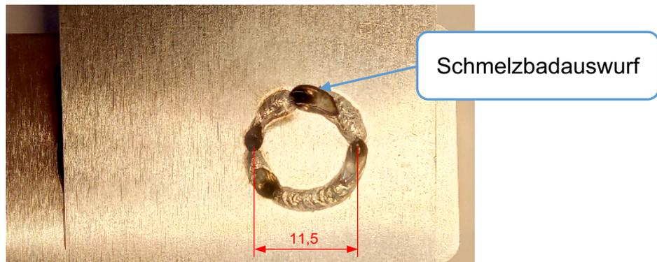
Abbildung 4-52: Probe 14; Oberflächenporen
