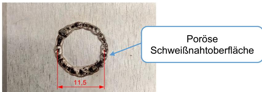
Abbildung 4-35: Probe 7; Poröse Schweißnaht infolge des Klebers
