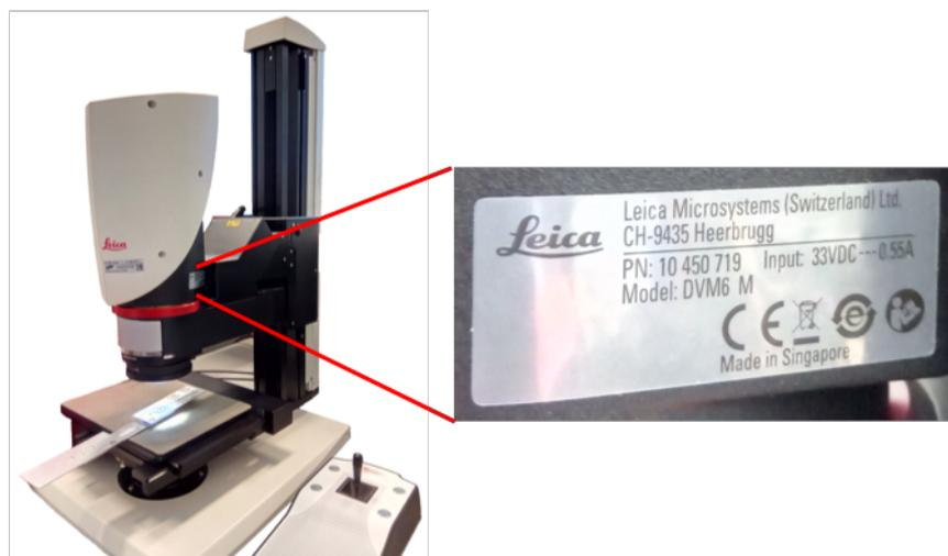
Abbildung 4-2: Digitalmikroskop Leica DVM6 M bei Samsung SDIBS GmbH
