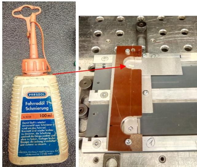
Abbildung 4-43: Probe 10; Verunreinigung der Busbaroberfläche durch Fahrradöl
