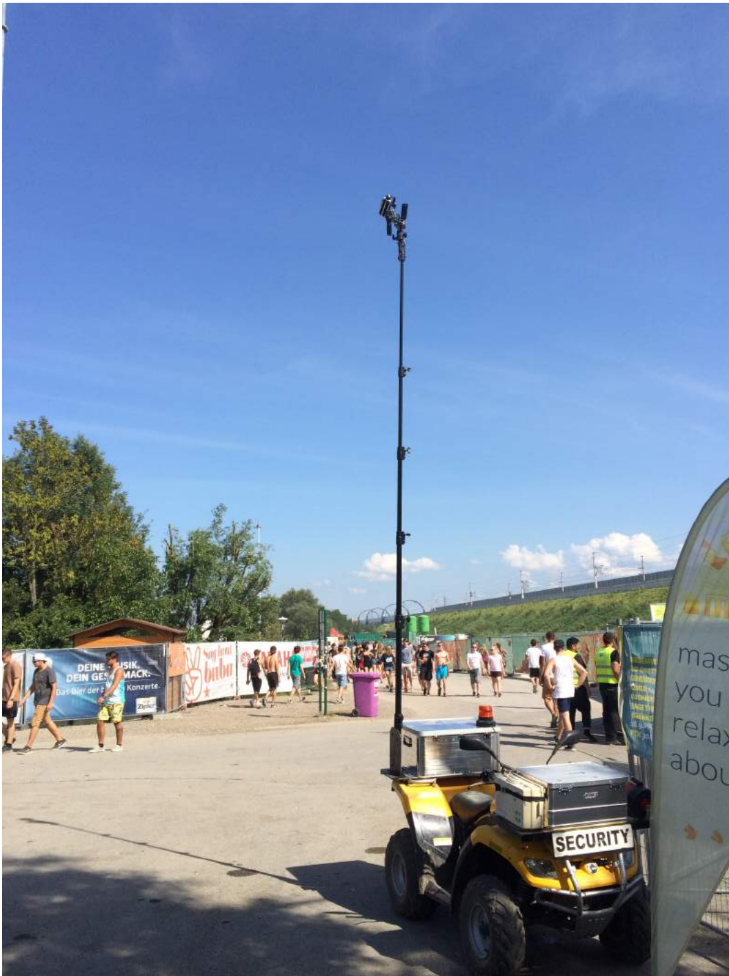
Abbildung 4.20: Im stehenden Betrieb, kann der Masten aber bis zu sieben Metern ausgezogen werden und bekommt dadurch einen sehr guten Blick vom gesamten Bereich, wie man in der Abbildung erkennen kann.
