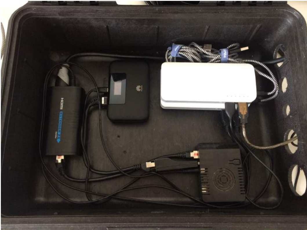
Abbildung 4.19: Damit die benötigte Hardware auch kompakt und übersichtlich mitgenommen werden kann und während der Fahrt mit dem Quad auch nicht auseinander fällt beziehungsweise die einzelnen Hardwarekomponenten sich im kompletten Koffer verteilen, wurden die einzelnen Teile mit einem Klettband zum Aufkleben befestigt. Dadurch ist die Hardware im Koffer gut befestigt, die Komponenten können aber auch wieder einfach entfernt werden beziehungsweise auch wieder sehr einfach befestigt werden.
