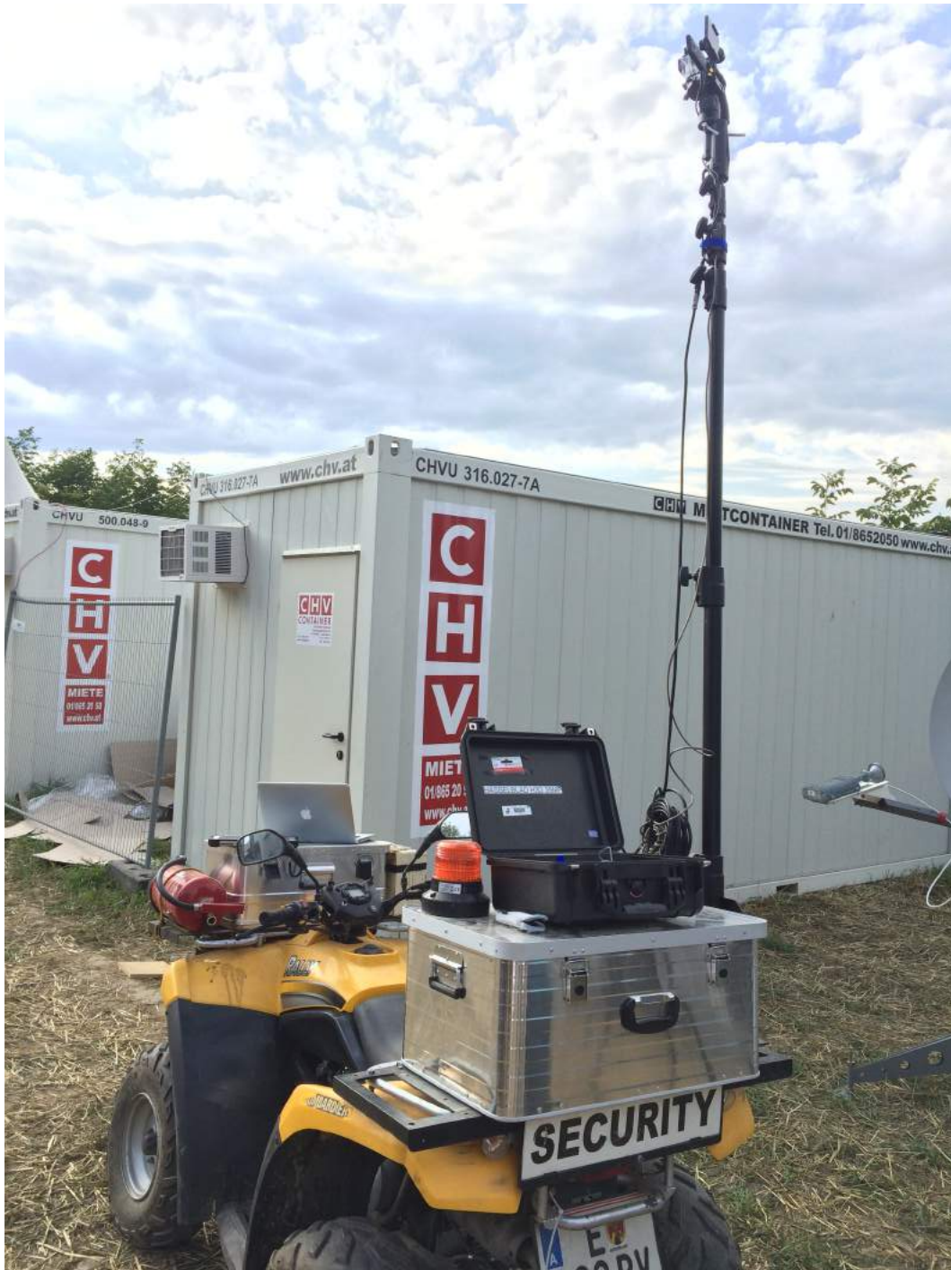
Abbildung 4.18: Damit der Masten auch gut und vor allem sicher auf dem Quad montiert werden kann, wurde uns von der Securityfirma ein Quad zur Verfügung gestellt, bei der eine zusätzliche Vorrichtung installiert wurde, in dem wir den Masten problemlos betätigen konnten.
