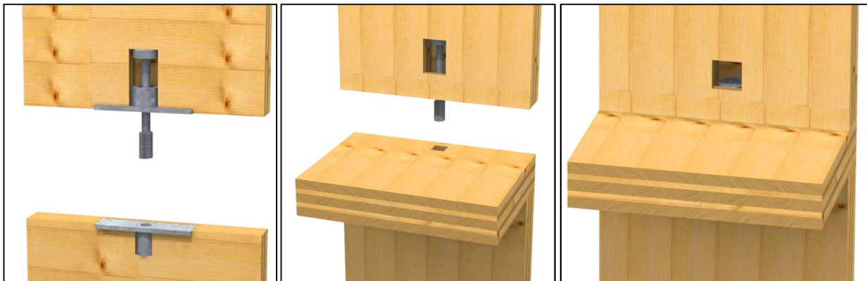
Abbildung 5-1: Anschlussituation vom „Universal Zuganker“ in der „Plattform“-Bauweise – (links) vormontierte Verbindungshälften in den Wänden (Grafik ohne Decklage), (Mitte) Einbau der darüber liegenden Wand mit vormontiertem Zuganker Teil B, (rechts) eingebauter Zustand mit Montageöffnung an der Rauminnenseite
