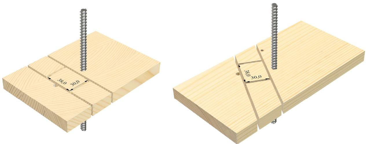
**Abbildung 3-37** Entnahmestelle der Darrprobe bei unterschiedlichen Prüfserien
