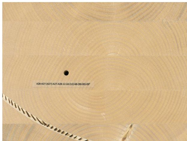
**Abbildung 3-16** „Kratzen“ des Sägeblatts während des Rohzuschnitt des Probekörpers
