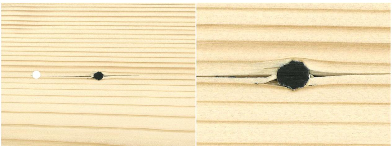
**Abbildung 3-4** Auftretende Rissbildung während der Schraubenapplikation
