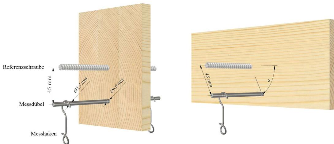
**Abbildung 3-26** Darstellung der lokalen Wegmessung mit gesetztem Messdübel und Verbindungshaken (links Prüfkörper der Prüferie {90-00}; rechts: Prüfkörper der Serie {90-90})
