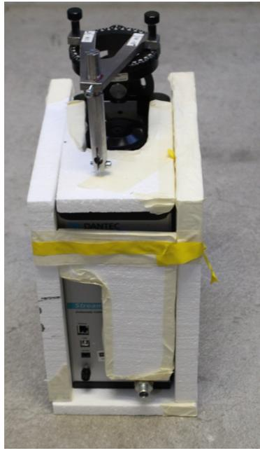
Abbildung 3.14: Kalibriereinheit mit Wärmedämmplatten isoliert
