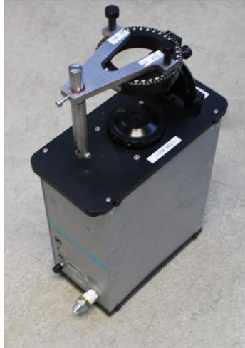
Abbildung 3.5: Kalibriereinheit von Dantec Dynamics mit Pitch-Yaw Manipulator und Sondenhalterung
