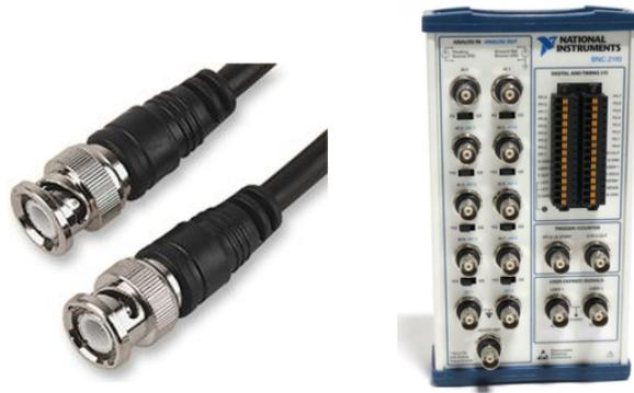
Abbildung 3.4: links: BNC-Kabel [Farnell, 2019], rechts: BNC-Anschlussblock [National Instruments, 2019]
