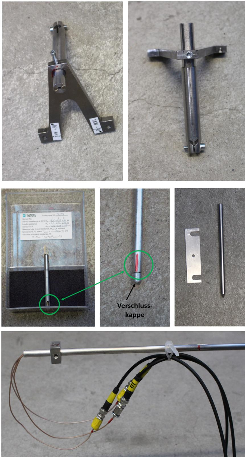
Abbildung 3.10: oben: Sondenhalterung, mitte: Sensor, Verschlusskappe, Lochblende und Sondendummy, unten: Zugentlastung
