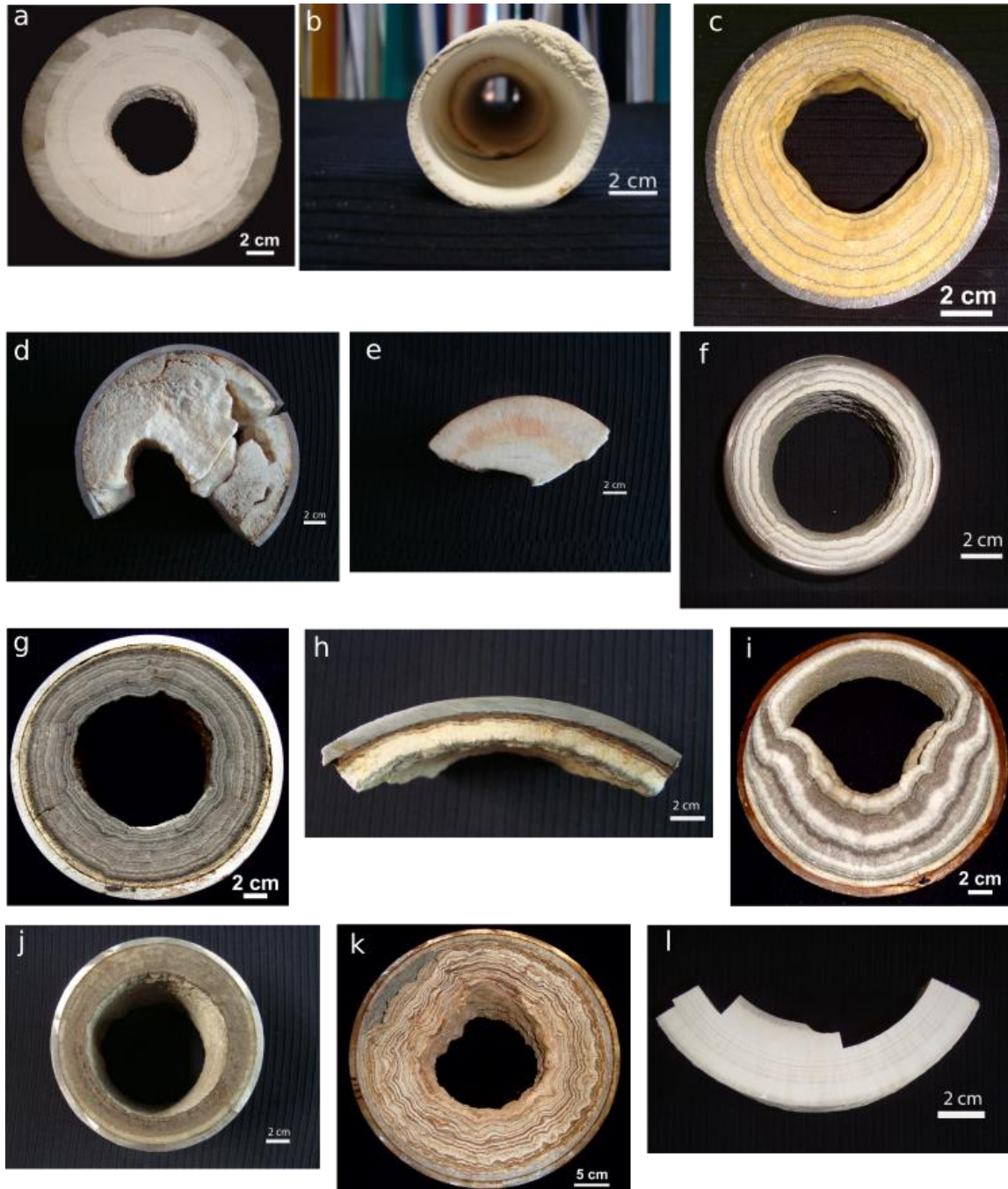
Abbildung 5: Karbonatscales aus unterschiedlichen Geothermieranlagen mit unterschiedlichem Erscheinungsbild. a. BUK-1 (Bükkfürdő), b. BUK-2 (Bükkfürdő), c. BEK-1 (Békéscsaba), d. FAS-1 (Fábiánsebestyén), e. FAS-2 (Fábiánsebestyén), f. SZE-1 (Szentés), g. SZE-2 (Szentés), h. SZE-3 (Szentés), i. KAK-1 (Kakasszék), j. SGD-5 (Szeged), k. SZI-1 (Széchenyi), l. GYR-1 (Győr)
