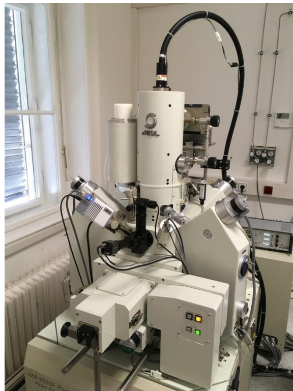
Abbildung 8: JEOL JXA-8530 Mikrosonde am Institut für Erdwissenschaften, Bereich Mineralogie und Petrologie an der Karl-Franzens-Universität Graz.
