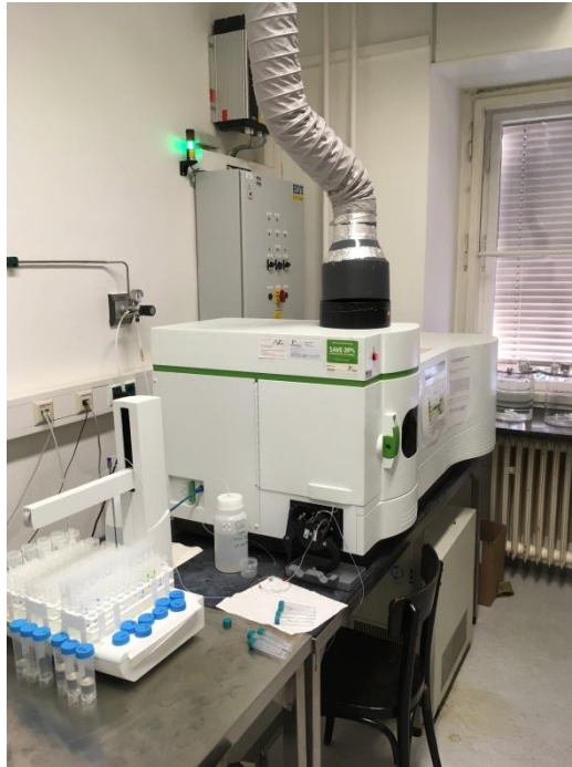
Abbildung 9: Perkin Elmer Optima 8300 DV Spektrometer am Institut für Angewandte Geowissenschaften TU Graz.
