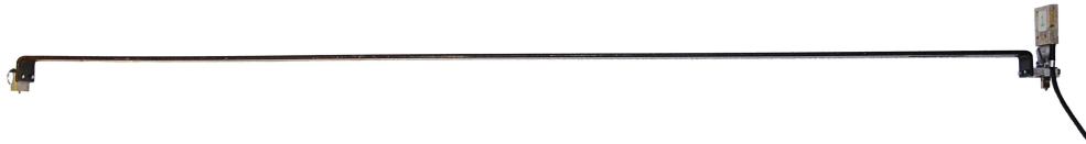
Abb. 4.12: Messvorrichtung mit HBM DD1 Dehnungsaufnehmer mit 80 cm langer Messbasis
