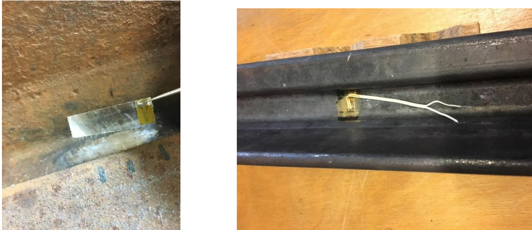
Abbildung 3.1: Applikation der DMS (Foto: Zauchner, Jänner 2019)
