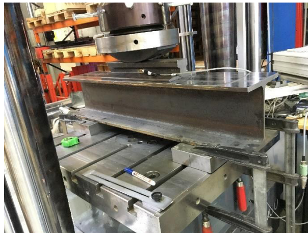
Abbildung 3.6: Versuchsaufbau für auf Walzprofil gebettete Schiene
