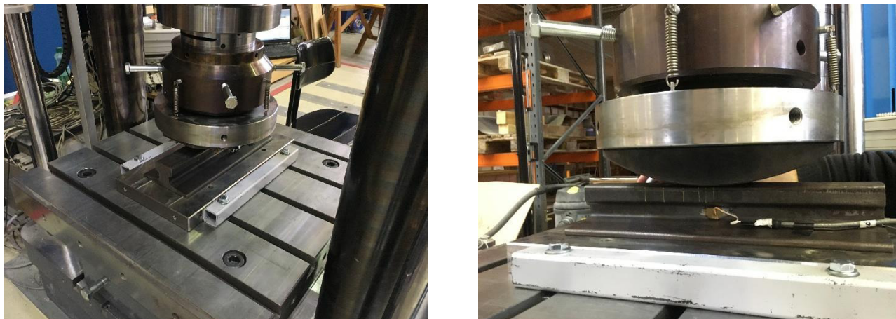
Abbildung 3.3: Versuchsaufbau für eine starr gebettete Schiene auf starrer Unterlage
