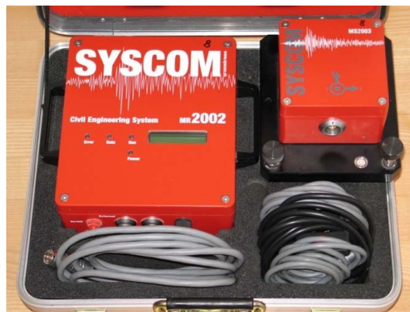
Abbildung 5-1 Messgerät MR 2002 von SYSCOM mit Schwinggeschwindigkeitssensor MS 2003
