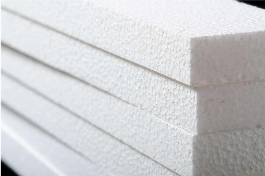
**Abbildung 66: EPS Dämmplatten**<sup>191</sup>
