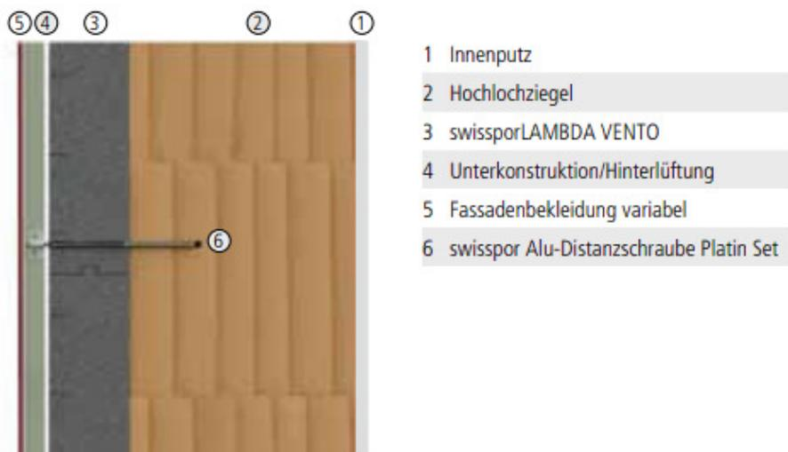
Abbildung 102: VHF drucksteifer Dämmstoff<sup>276</sup>
