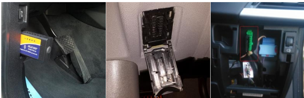
Abbildung 40: Bild 1: frei zugänglicher Anschluss, Bild 2: Anschluss mit Staubschutz, Bild 3: Anschluss unter Abdeckung
