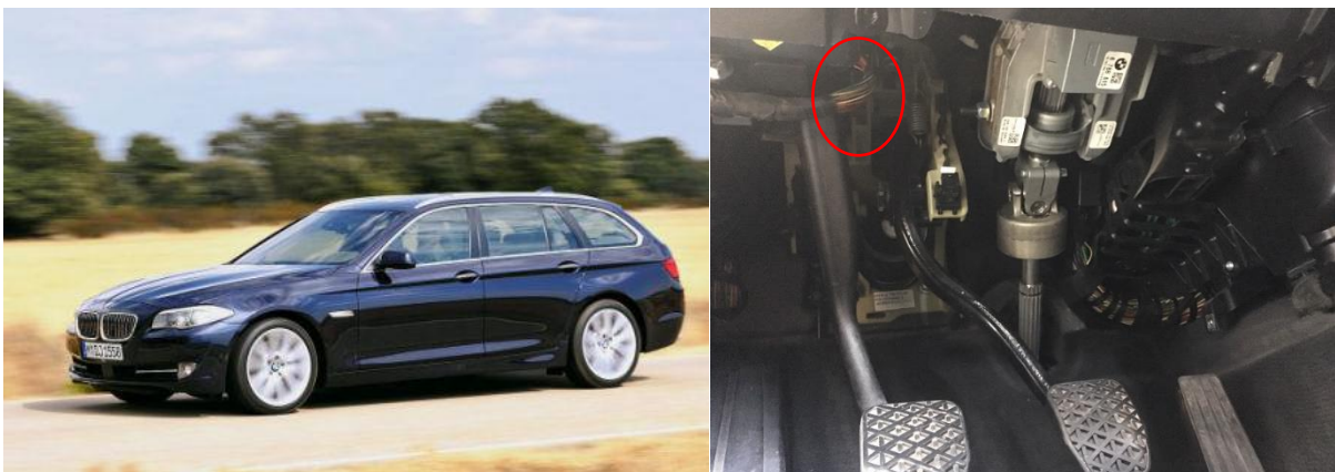
Abbildung 15: BMW 5er Touring (2010) und CAN Abgriff im Fußraum
