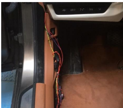
Abbildung 13: herausgelegter Kabelbaum für Messgeräte und Farbcodes
