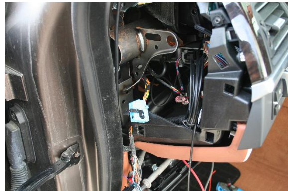
Abbildung 21: Stecker für CAN-Abgriff und GPS- Antenne
