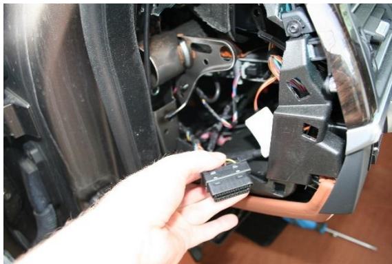
Abbildung 20: Spannungsabgriff am OBD Stecker
