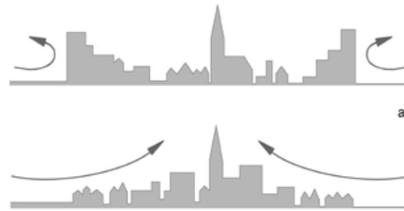
Abb. 39: Zusammenhang zwischen städtebaulicher Dichte und Durchlüftung
