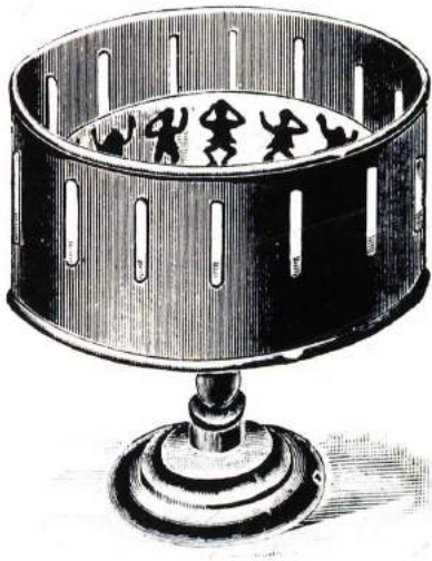
Abb. 40: Wundertrommel des Erfinders W.G.V. Horner 1834 (Lebensrad, "Dädulum", "Zoetrope")
