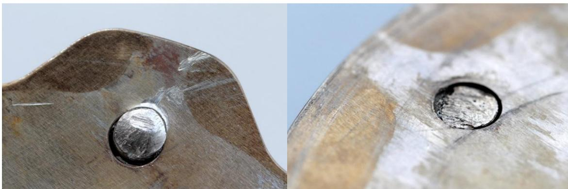
**Abbildung 72: Schwungmasseblech aus 42CrMo4 und Messmassescheibe aus W400 VMR mit Resten der Spannschrauben.**
