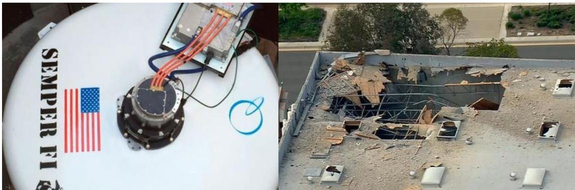
Abbildung 79: Bilder der Explosion in der *Quantum Technologies* Flywheel-Anlage in San Diego, USA [172].
