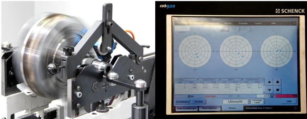
Abbildung 65: VIMS-Berstroter auf Wuchtmaschine Schenck Pasio 50 (links) und „User Interface“ (rechts).
