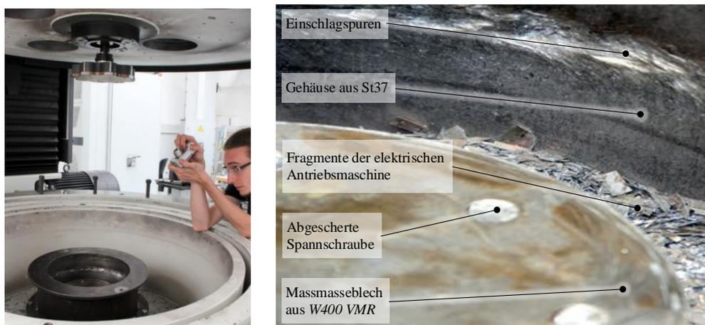
Abbildung 70: Berstrotor nach Eintreten des Versagens bei 45000 UpM.
