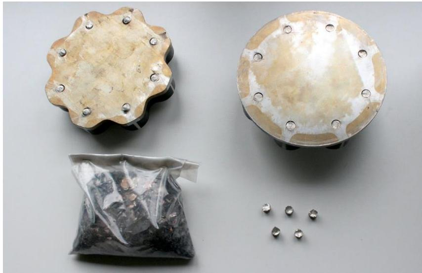
**Abbildung 71: Vom Berstversuch übriggebliebene Rotorteile.**
