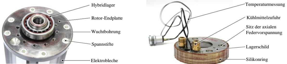
Abbildung 119: CMO-Rotorlagerung und dazugehöriger Lagerschild.
