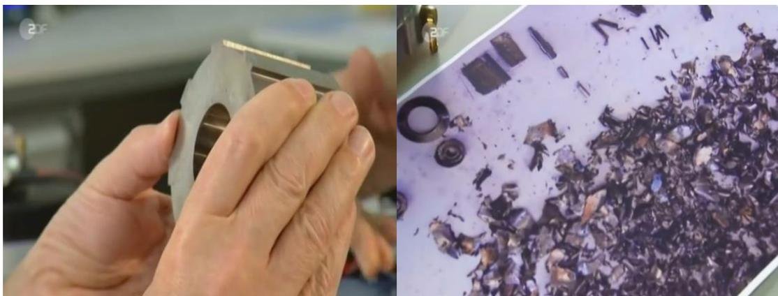
Abbildung 57: Bersttests geblechter Rotoren: Prototyp des *Compact Dynamics FI-Moduls* [161].
