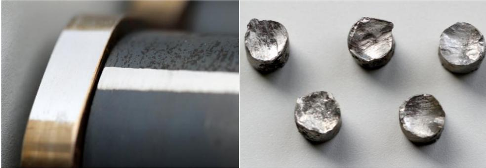
Abbildung 73: Links – Vergleich der fließkraftbedingten Aufweitung der Rotorteile aus  $42CrMo4$  und  $W400 VMR$  nach 45000 UpM. Rechts – Überreste der Spanschrauben, welche auf Höhe des *Vacodur*-Blechstacks abgeschert wurden.
