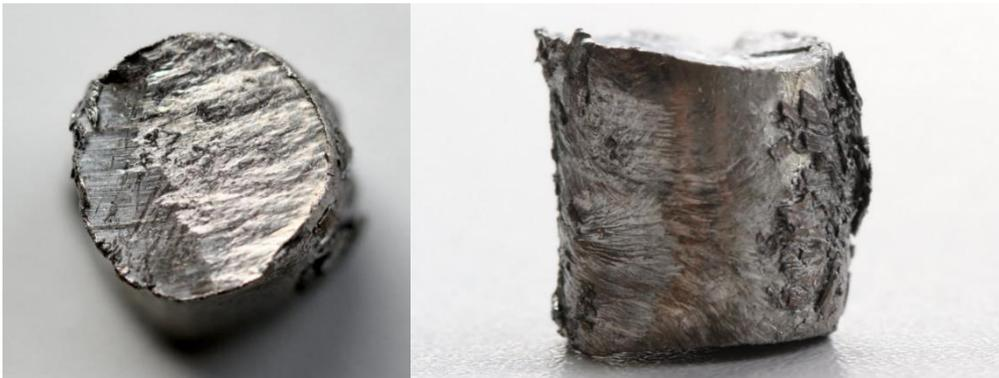
Abbildung 74: Makroaufnahmen einer abgescherten Spanschraube. Links – Draufsicht mit eindeutigen Abscherungen. Rechts – Seitenansicht. Auf der rechten Seite des Bruchstücks sind „aufgebackene“ Fragmente von *Vacodur S Plus* zu erkennen.
