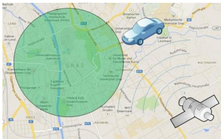
**Abbildung 40:** Funktionsprinzip einer emissionsfreien Zone durch *Geofencing*.
