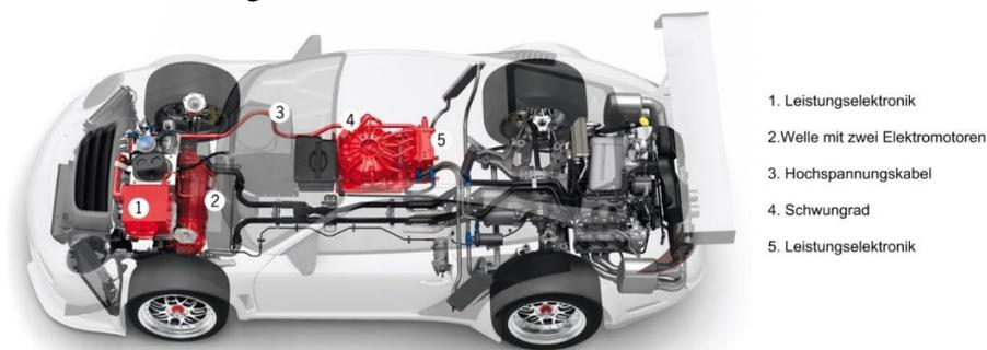
Abbildung 17: Schwungradspeicher im Rennfahrzeug: Schnitt durch den *Porsche GT3 Hybrid* [48].
