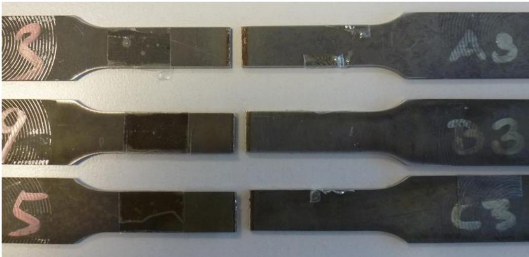
Abbildung 39: Bewertung der Bruchlage nach dem Zugversuch; oben: Bruchlage im Grundwerkstoff; unten: Bruchlage in der Schweißnaht
