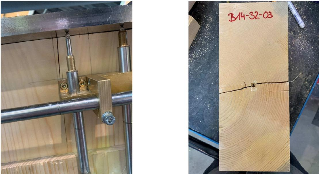
*Abbildung 4-11 Versagen des Prüfkörpers (links: in eingebautem Zustand; rechts: in ausgebautem Zustand)*
