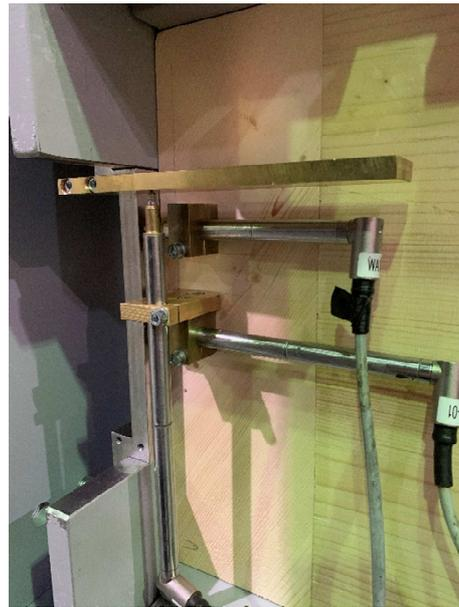
*Abbildung 3-39 Wegmesssystem für die Abscherversuche (links: System mit vier Wegaufnehmern; rechts: System mit sechs Wegaufnehmern)*
