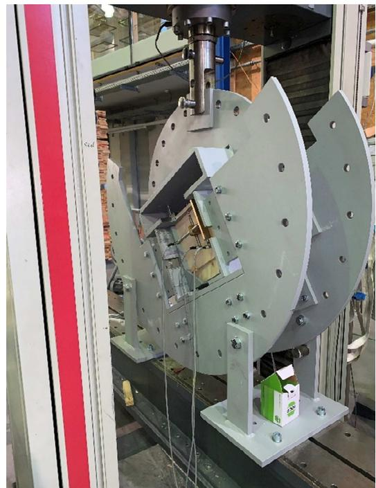
**Abbildung 3-33 Prüfkonfiguration (links: Unterbau mit eingesetztem Prüfgeschirr; rechts: Versuch zur kombinierten Beanspruchung mit eingebautem Wegmesssystem)**
