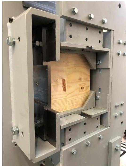
Abbildung 3-34 Detailaufnahme (links: Prüfgeschirr; rechts: Abscherversuch mit eingebautem Prüfgeschirr)
