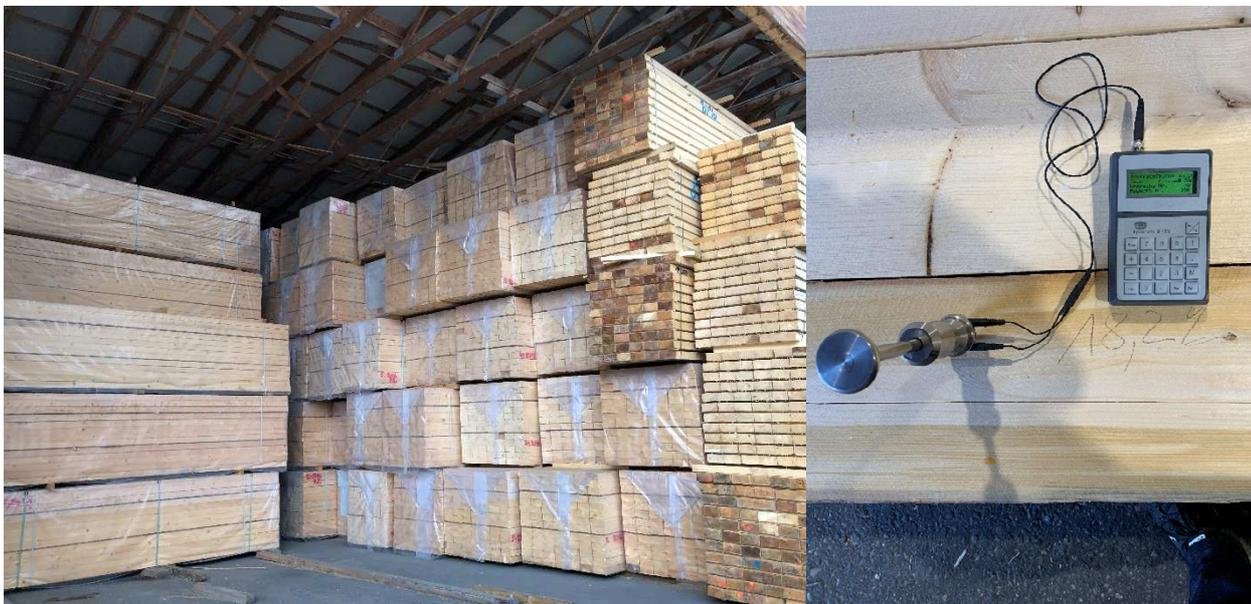
Abbildung 3-9 Sortiervorgang (links: zur Verfügung gestelltes Rohmaterial; rechts: Holzfeuchtemessung des Rohmaterials)
