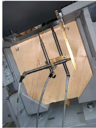
Abbildung 3-8 Belastungsrichtung Druck mit der Faser (links: grafische Darstellung der Belastungsrichtung; rechts: Druck mit der Faser für Prüfkörper B20-(26)-08-225-30-60-30-30-04)
