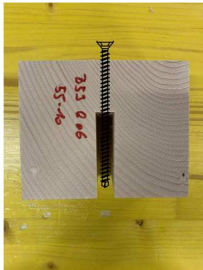
Abbildung 3-6 Darstellung der Bearbeitung der Prüfkörper für Einschraubtiefen von 40 mm
