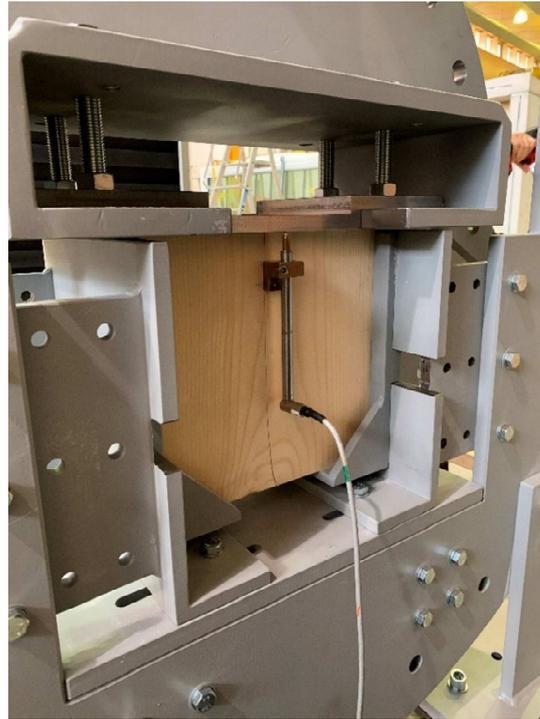
*Abbildung 3-38 Wegmesssystem für die Ausziehversuche*
