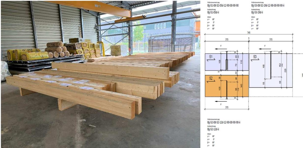
Abbildung 3-13 Einteilung Rohmaterial (links: Einteilung für Grobzuschnitt mit Laufzetteln (sh. ANHANG C); rechts: Planung Prüfkörperzuschnitt)
