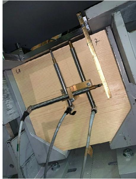
*Abbildung 3-43 Verdrehungen Stahllasche (links: Verdrehung für Prüfkörper B38-22-08-225-30-00-90-07 Nordseite; rechts: Verdrehung für Prüfkörper B38-22-08-225-30-00-90-07 Südseite)*
