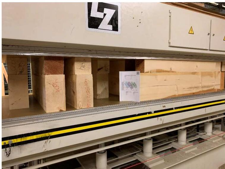
*Abbildung 3-15 Leimung mittels hydraulischer Presse*
