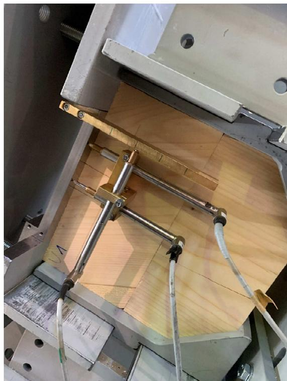
*Abbildung 3-40 Wegmesssystem für die kombinierte Beanspruchung*
