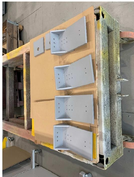
Abbildung 3-35 Detailaufnahme (links: Schraubenbleche; rechts: Probekörperhalterung)
