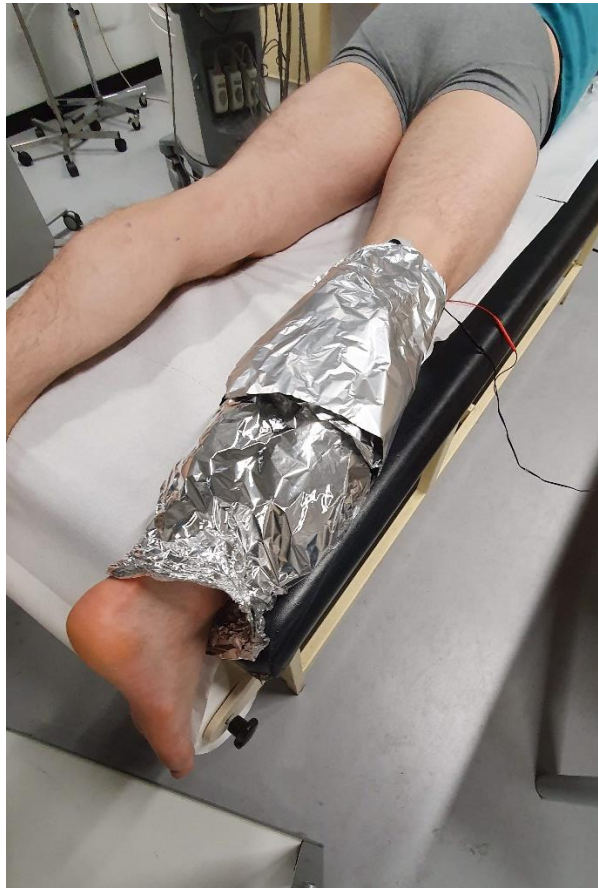
Abb. 31: Adaptierter Messaufbau mit Schirmung der EMG-Elektroden.
