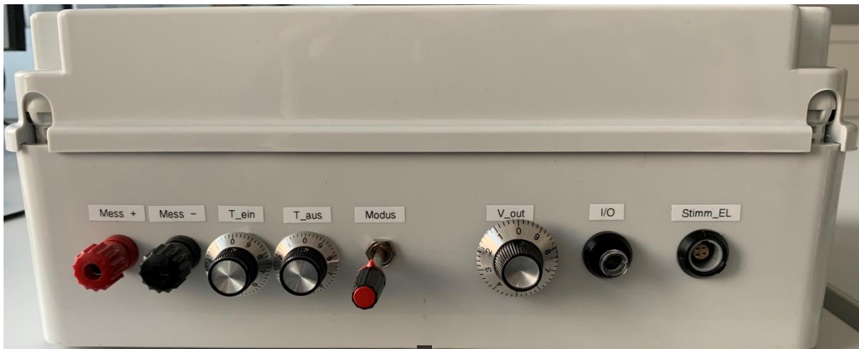
Abb. 26: Vorderseite des Stimulators mit diversen Stellgliedern zur Variation der Stimulationsparameter und Anschlüssen für Stimulationsimpulsmessungen bzw. Stimulationselektroden.
