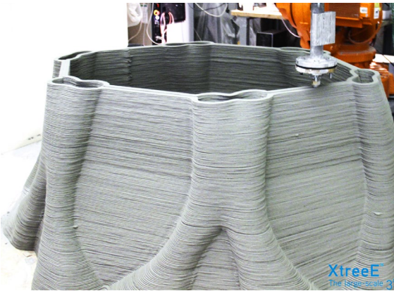
Abb.30: XtreeE 3D gedruckte Stütze, Marseille, 2015
