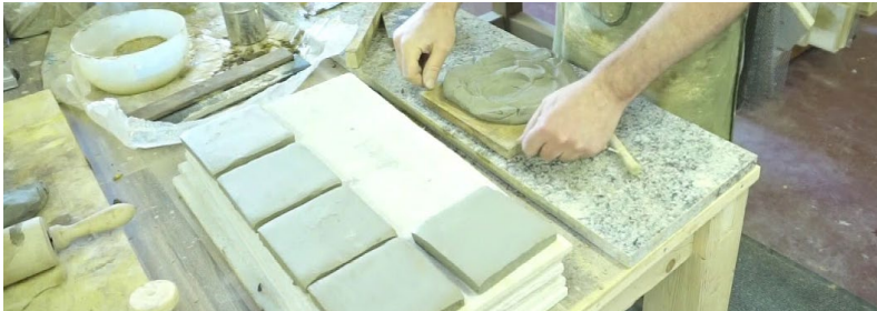
Abb.11: Fliesenherstellung im Schneideverfahren
