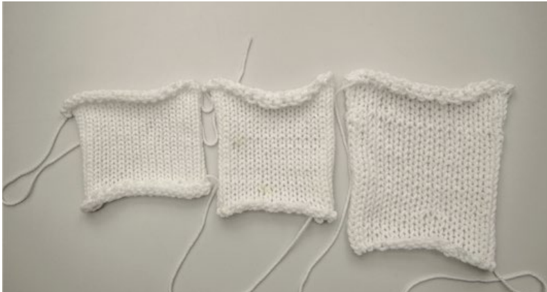
Abb.75: Bei selber Garnlänge entstehen bei unterschiedlicher Garnspannung unterschiedliche Abmessungen
