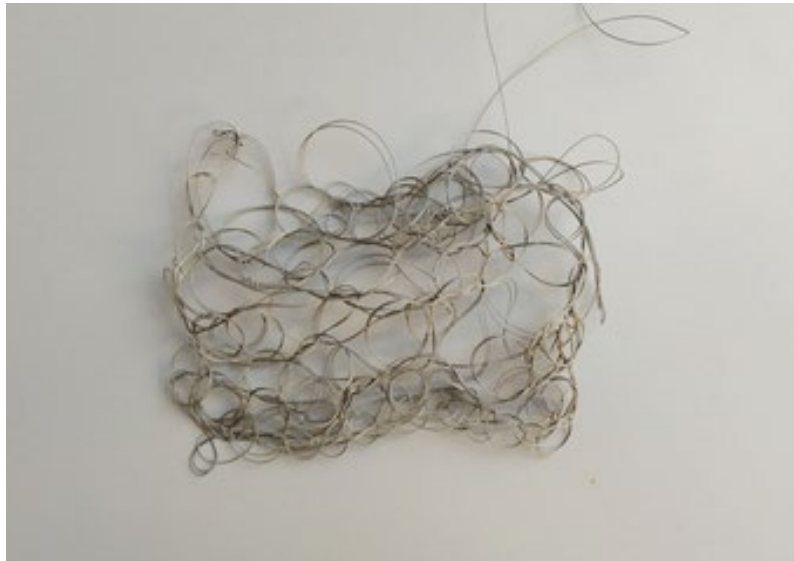
Abb.74: Stahlkordel ist nicht verstrickbar
