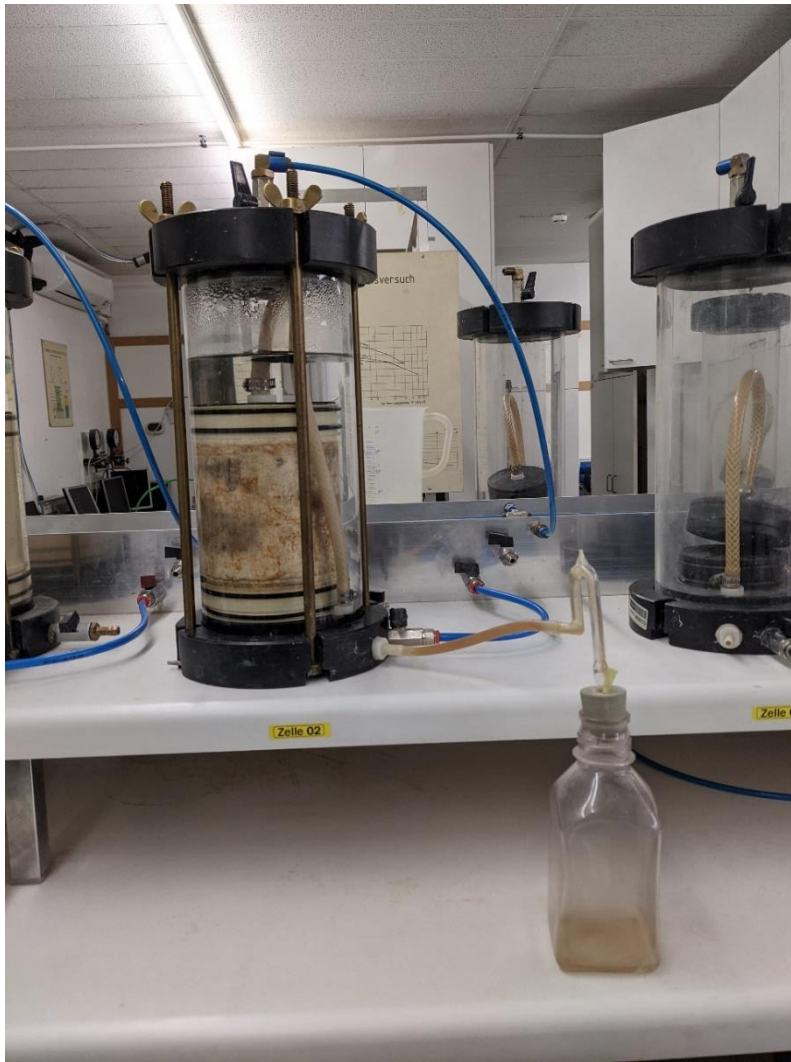
Abbildung 11: Versuchsaufbau zur Durchlässigkeitsbestimmung mittels Triaxialzelle
