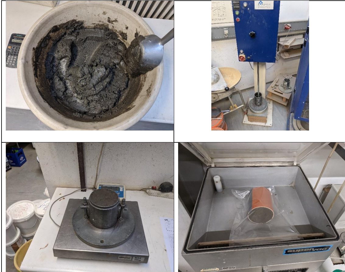
Abbildung 8: Ablauf Proctorversuch mit einschweißen der Probe in Kunststoffbeuteln
