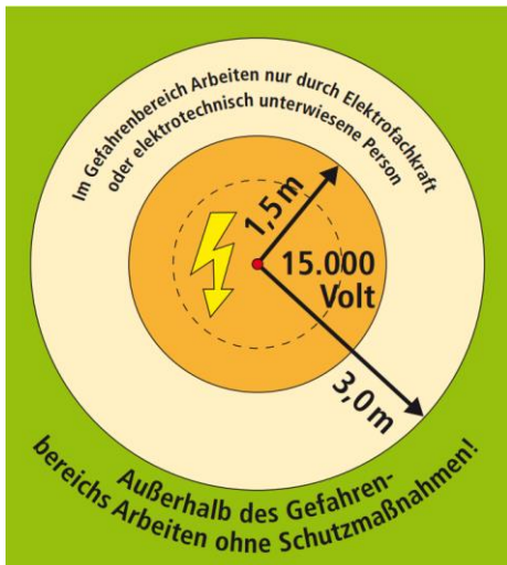
Abbildung 6-2 Gefahrenbereich der Oberleitung 225
