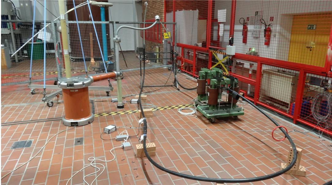
Bild B.7: Prüfaufbau der TE-Messungen bei Wechselspannungsbeanspruchung
