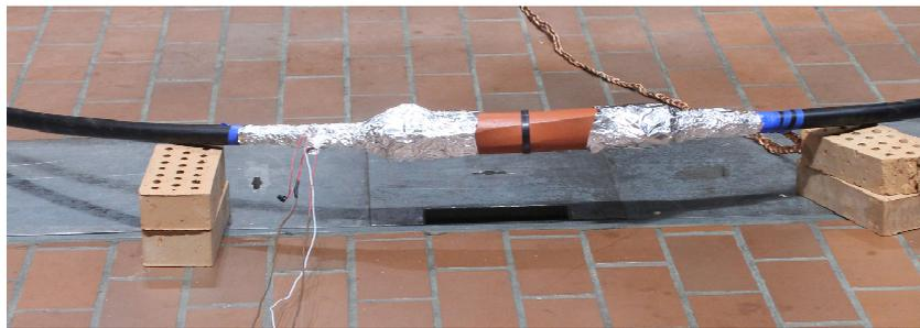
Bild 8.5: Vorbereitung des Kabelprüflings für die DC-Durchschlagsuntersuchungen mit partieller Erwärmung
