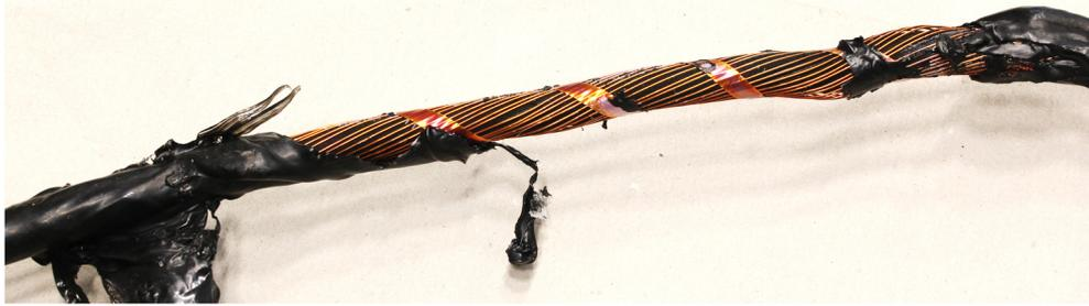
Bild 8.6: Abgeschmolzener Kabelmantel im Bereich des Durchschlags von Kabelprüfling P9 nach thermischem Durchschlag
