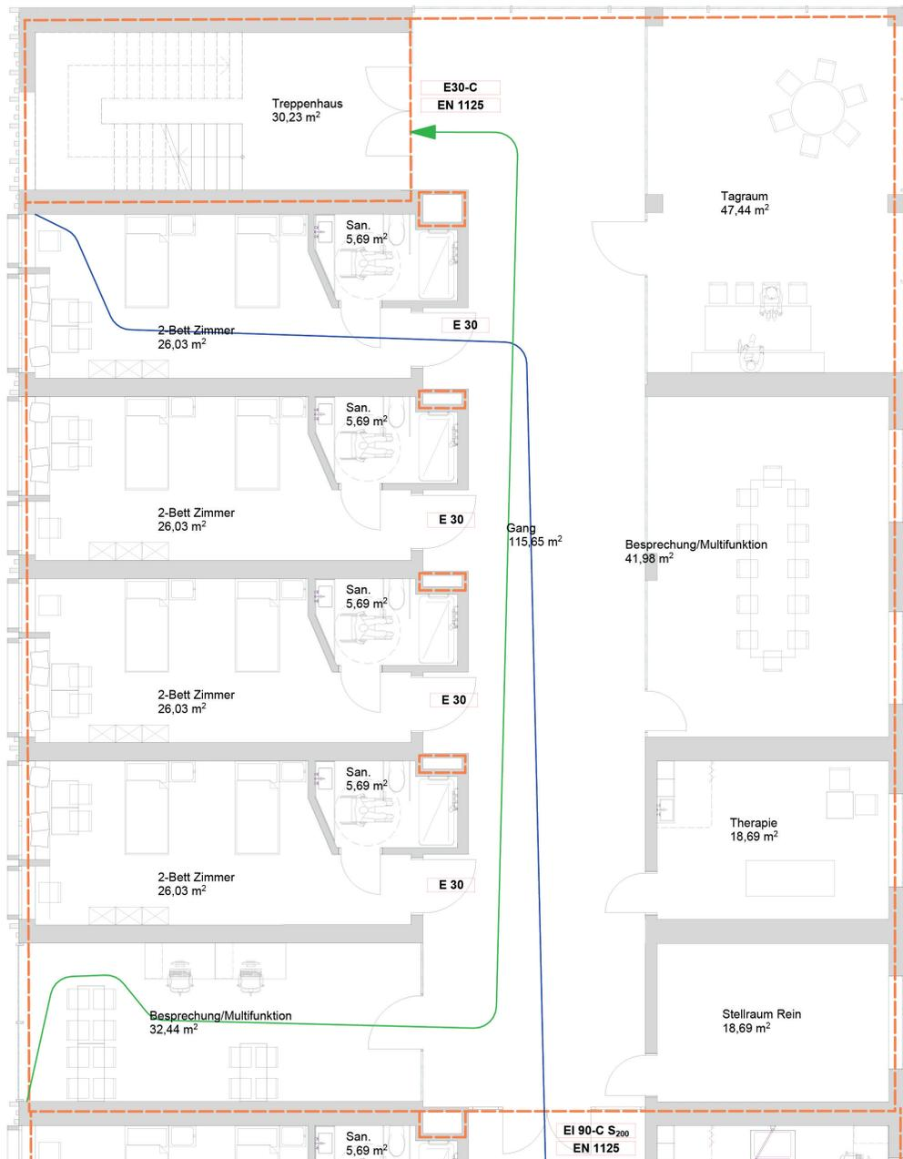
Abb. 52: Brandabschnitte und Fluchtwege Nordflügel Stationstrakt
