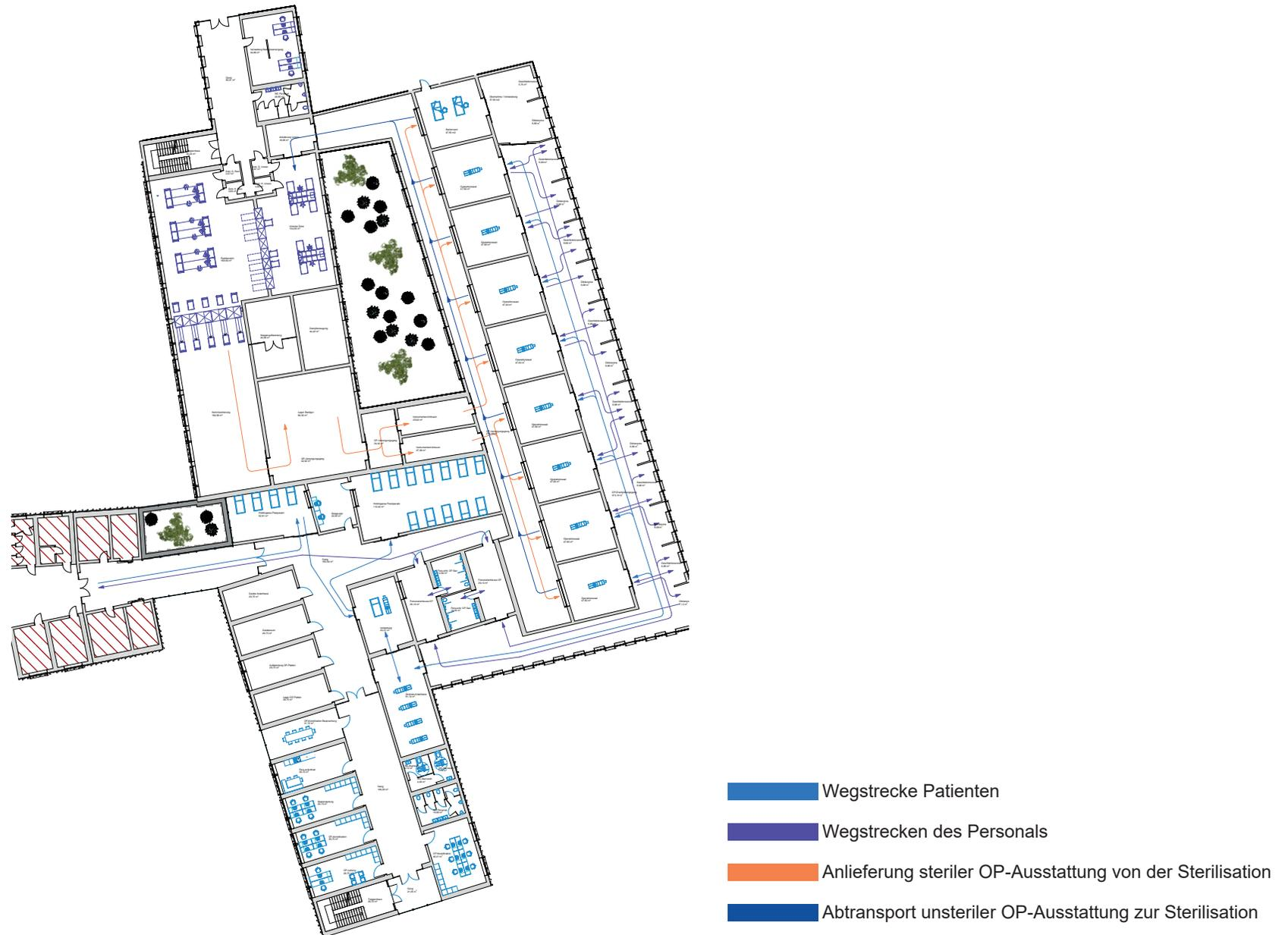
Abb. 44: Bewegungs- und Materialabläufe im Operationstrakt und der Sterilisation
