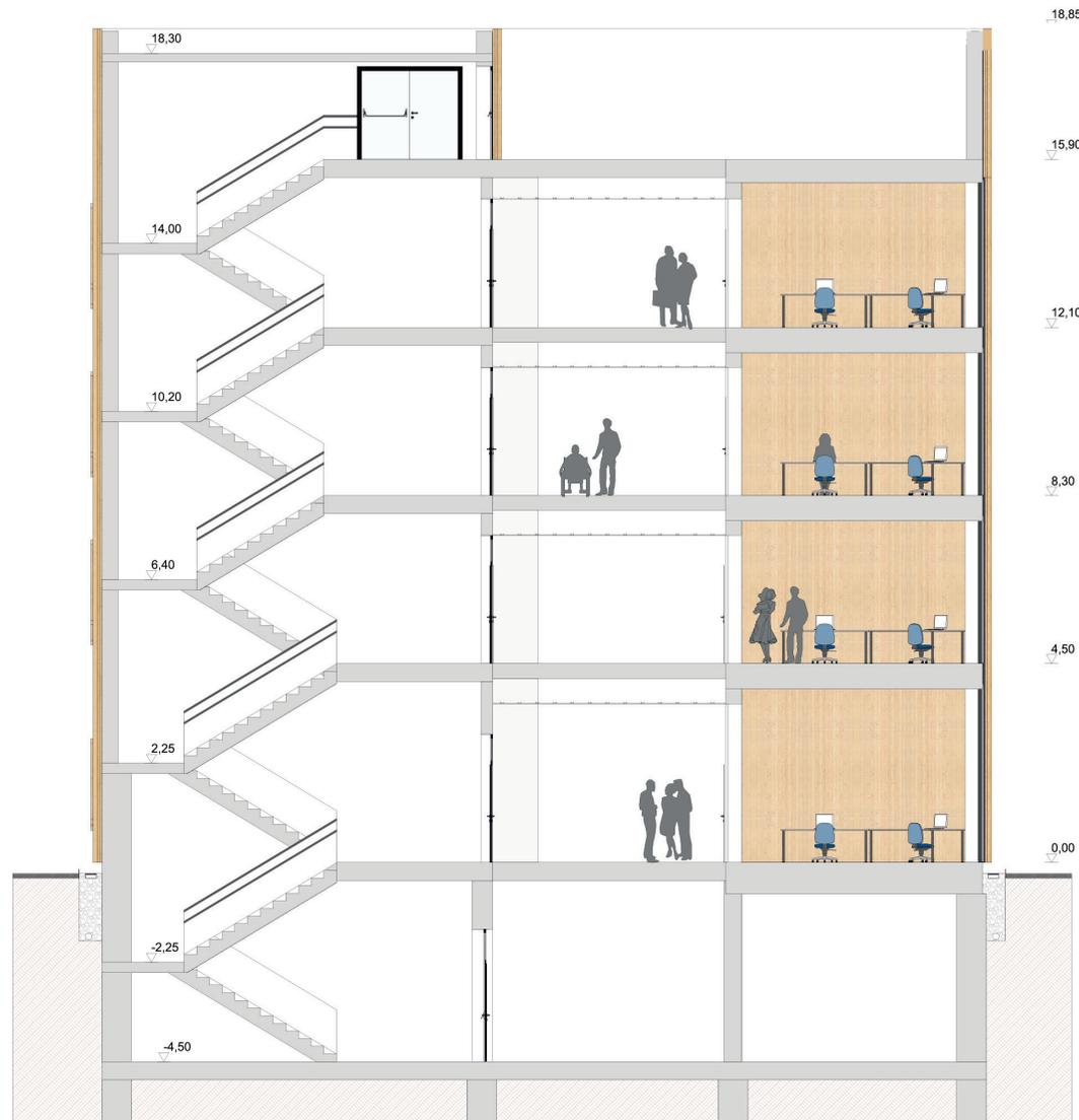
Abb. 39: Schnitt durch ein Treppenhaus
