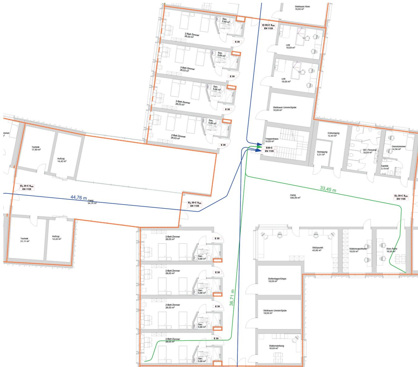
Abb. 50: Zentraler Brandabschnitt Stationstrakt
