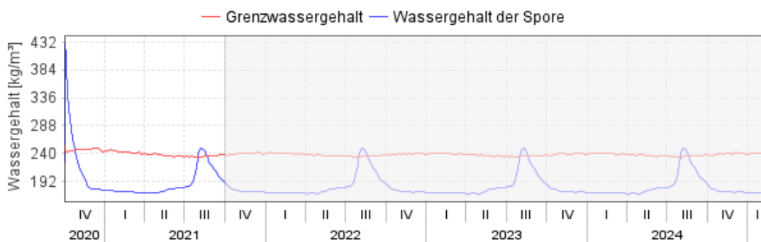
Abbildung 30: Wassergehalt der Spore [kg/m 3 ] über den Berechnungszeitraum und die daraus abgeleitete Wachstumsrate [mm], Beispiel 1
