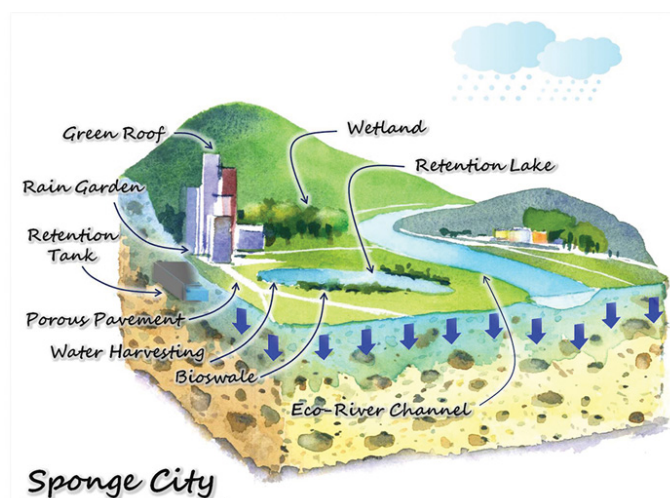
Abbildung 3.2: Schematische Skizze des Prinzips einer Spongecity mit allen wichtigen naturnahen Maßnahmen (Drainage Services Department, 2017)
