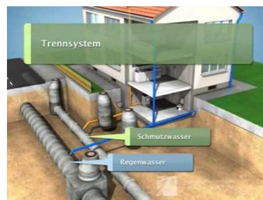
Abbildung 2: Darstellung des Prinzipes des Trennwassersystems anhand eines Hausanschlusses (Landeshauptstadt Düsseldorf, 2020)
