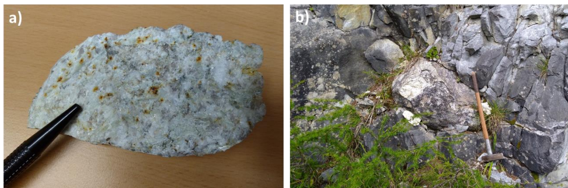
Abb. 12: a) Probe BR0101 beinhaltet hauptsächlich Feldspat, Quarz und Spodumen, b) Pegmatitlinse des BR02 – Aufschlusses in Bretsteinmarmor
