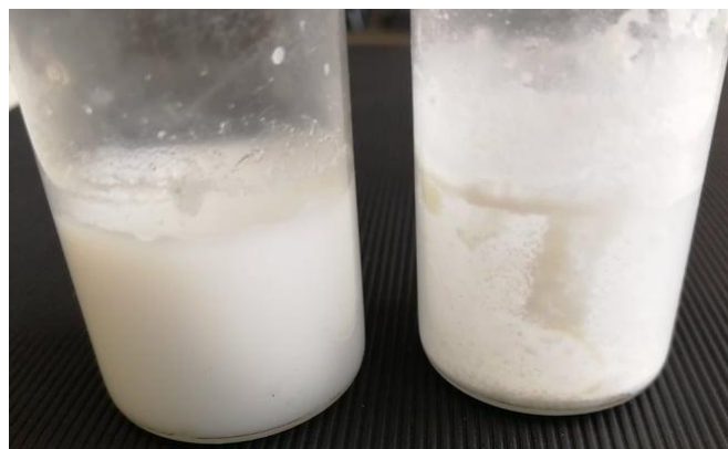
Abbildung 31: Öl-APTES Proben zur Bestimmung der optimalen Konzentration an Alkoxysilan. Links: 200 mg; Rechts: 500 mg.
