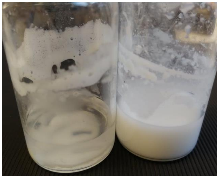
Abbildung 41: Polymerisationsversuchslösungen von DiÖI-AEAPTMS im sauren (links) und basischen Medium (rechts).
