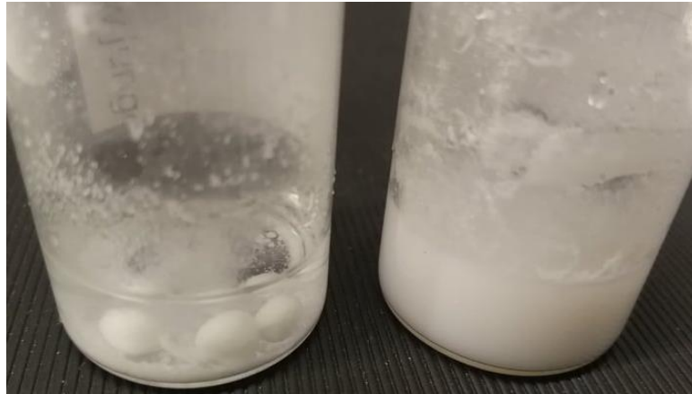
Abbildung 33: Polymerlösung von Öl-APTES bei pH-Wert 0,1 (links) und 11,6 (rechts) nach 7 Tagen.
