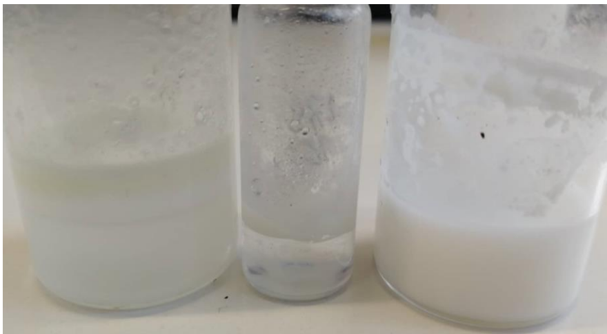
Abbildung 28: Hergestellte ÖL-APTES-Proben. Links: via Ultraschall; Mitte: Vortex; Rechts: Mischung per Magnetprüher.
