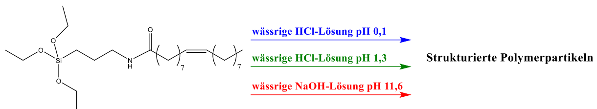
Schema 15: Verfahrensschema der Polymerisation von Öl-APTES bei den pH-Wert-Versuchen
