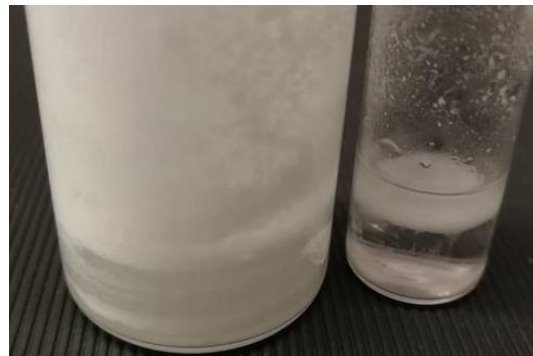
Abbildung 50: SAXS-Proben von Lau-APTES. Links: in wässriger HCl; Rechts: in ätherischer HCl.
