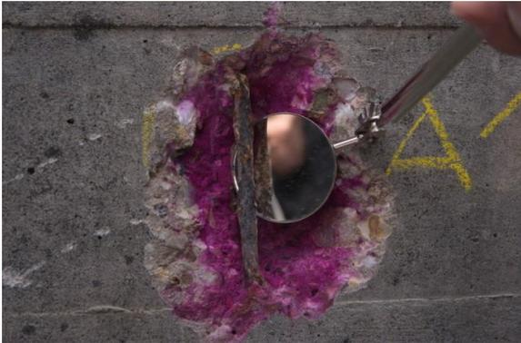
Abbildung 48 Phenolphthalein Test<sup>129</sup>
