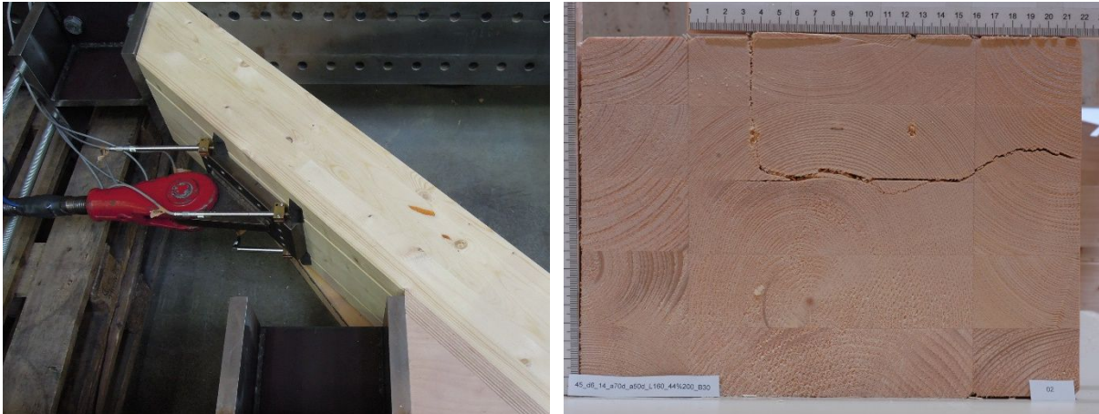
Abbildung 2-33 Blockscherversagen bei einseitigen Queranschlüssen mit geneigt angeordneten Schraubengruppen; rechts: Versuchsaufbau; links: Risse im aufgetrennten Querschnitt; aus [49]
