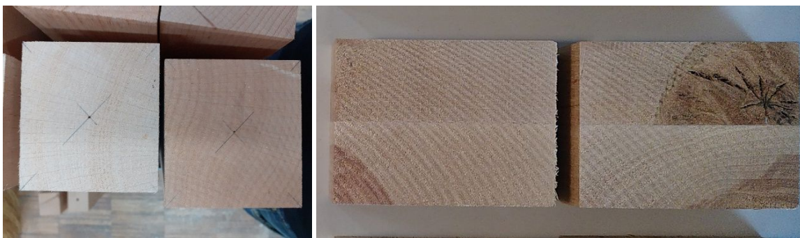
Abbildung 3-1 Exemplarische Querschnitte von Prüfkörpern; links: Prüfkörper aus Buche; rechts: Brettchichtholzträger aus Birke
