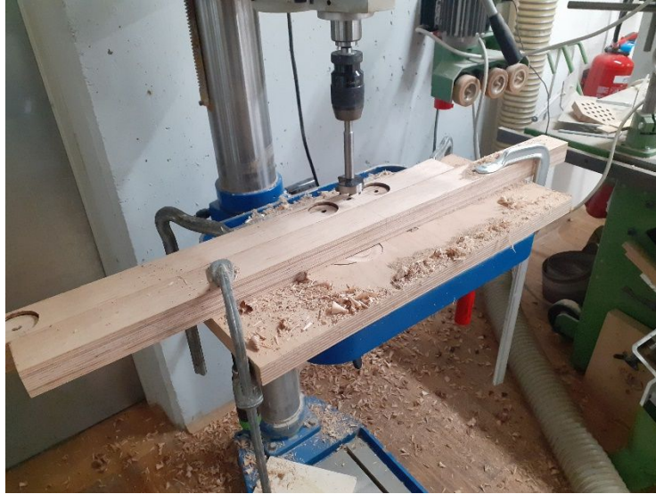
Abbildung 3-10 Herstellung der Versenkungen der Zuglaschen mit Hilfe einer Standbohrmaschine und eines Forstnerbohrers
