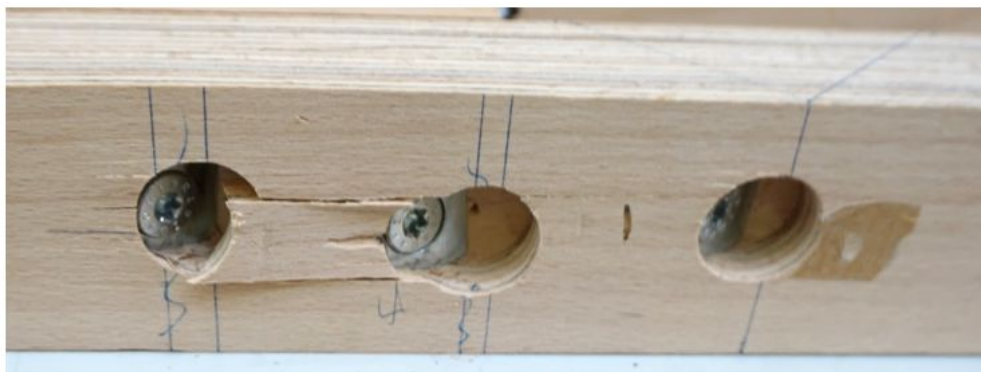
Abbildung 4-30 Kopfdurchziehen in den BauBuche-Q-Laschen mit teilweisen Abscheren zwischen den Senkbohrungen; aus [67]
