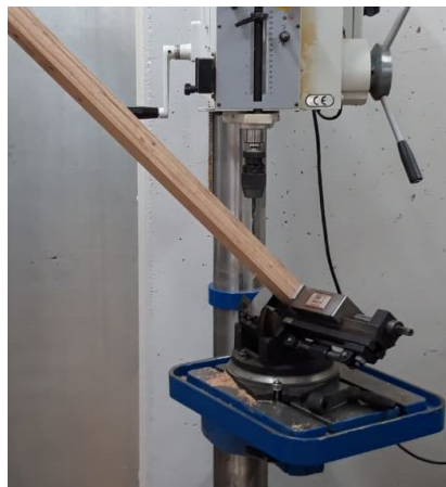
Abbildung 3-11 Herstellung der Bohrungen der Zuglaschen mit Hilfe einer Ständerbohrmaschine und bi-axial einstellbaren Schraubstock aus [67]
