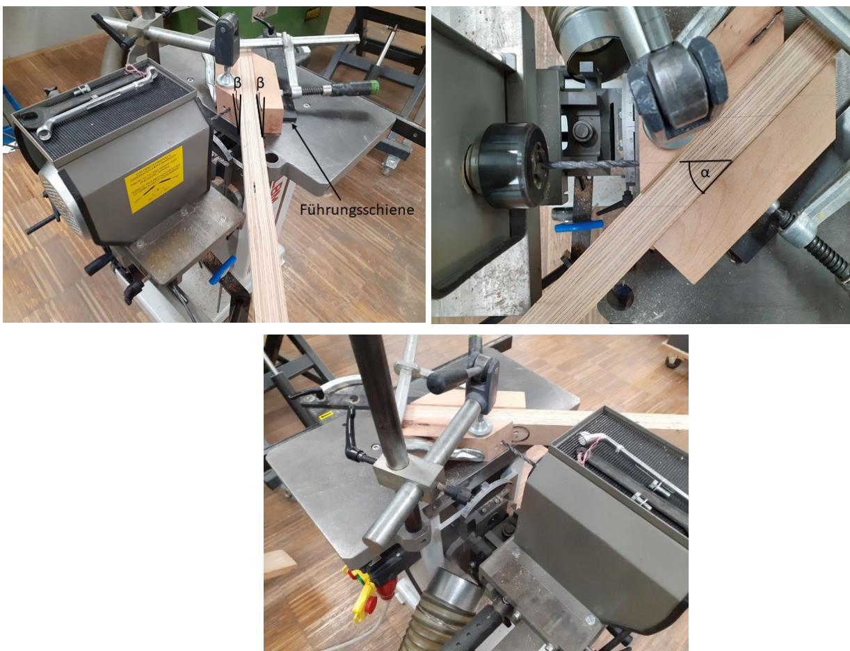
Abbildung 3-9 Herstellung der Vorbohrungen der Zuglaschen mit Hilfe einer Langlochbohrmaschine und Keilen; links oben: Längsansicht mit eingezeichnetem seitlichen Neigungswinkel der Schrauben \beta ; rechts oben: Ansicht von oben mit eingezeichnetem Neigungswinkel der Schrauben in Längsrichtung \alpha ; unten: Seitenansicht
