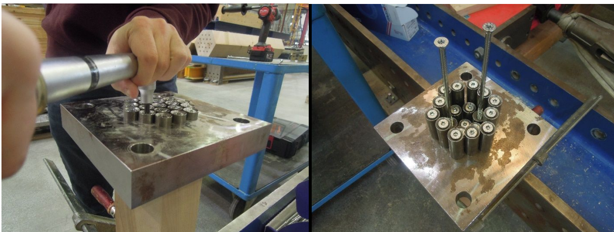
Abbildung 3-19 Links: Anziehen der Schrauben mit einem Drehmomentschlüssel; rechts: an einem Prüfkörper angebrachte Stahlplatte mit Distanzhülsen und eingedrehten Schrauben
