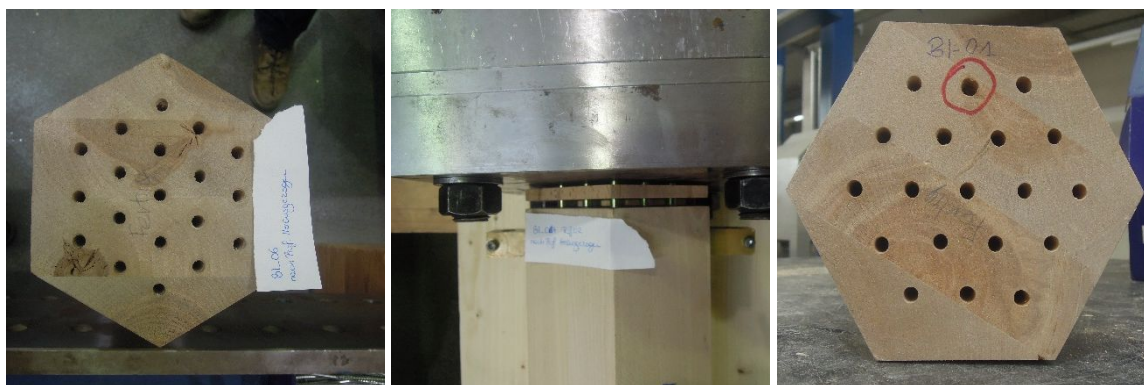
Abbildung 4-8 Versagensbilder der Prüferserie BI_01; links und rechts: Querschnitte von Prüfkörpern mit einem Versagen durch Herausziehen mit rot markierter Stelle des abgebrochenen Bohrers; Mitte: Seitenansicht des Versagensbereiches eines Prüfkörpers mit Versagen durch Herausziehen
