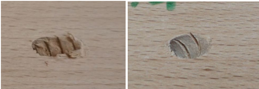
Abbildung 4-27 Detailansicht Schraubenloch; Vorbohrdurchmesser d_{PD} = 8 mm; links: Ausziehversagen; rechts: ohne Versagen
