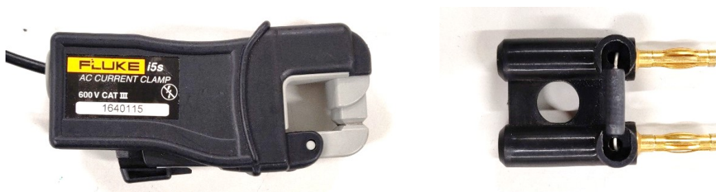
Abbildung 3.9: Wechselstromzange „FLUKE i5s“ (links) und Strommesswiderstand (rechts)
