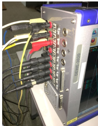
Abbildung 3.11: Messstation 1 in der 20-kV-Anlage mit Messgerät DEWE-3020
