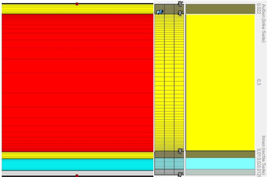
Abbildung 161: Aufbau (oben = außen; Gesamtbreite = 37,5cm) I51 in Delphin (links) und WUFI (rechts)
