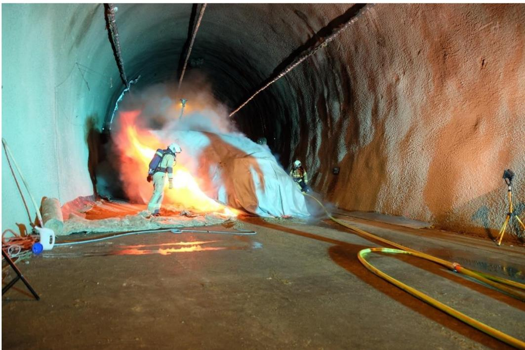
Abbildung 7-37 Einsatz Löschdecke 2. Fahrzeugbrandversuch
