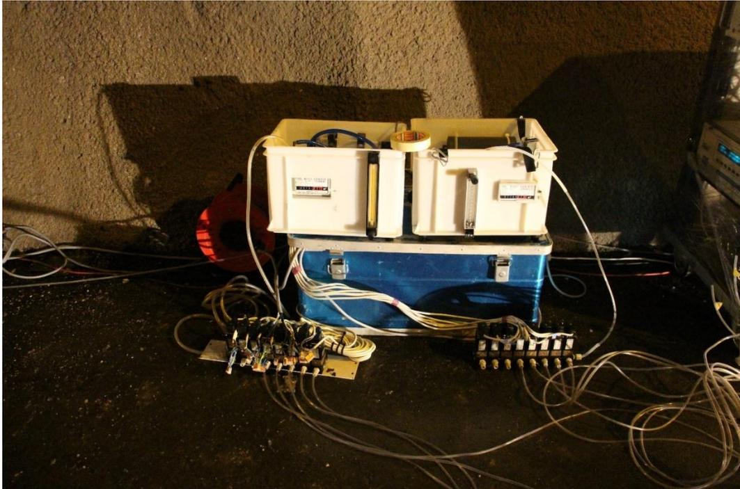
Abbildung 7-30 Pumpen und Magnetschaltventile
