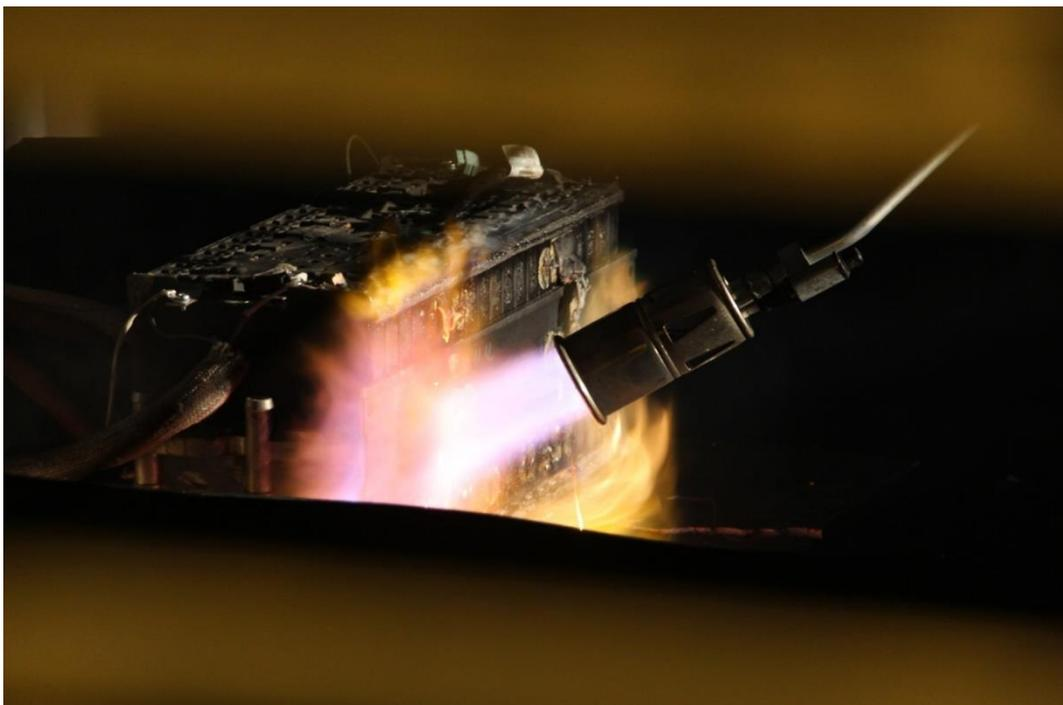
Abbildung 7-3 Exemplarische Darstellung der Entzündung eines Moduls
