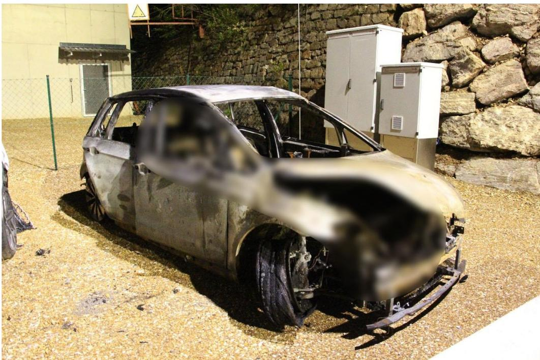
Abbildung 7-38 Versuchsträger nach dem 2. Fahrzeugbrandversuch
