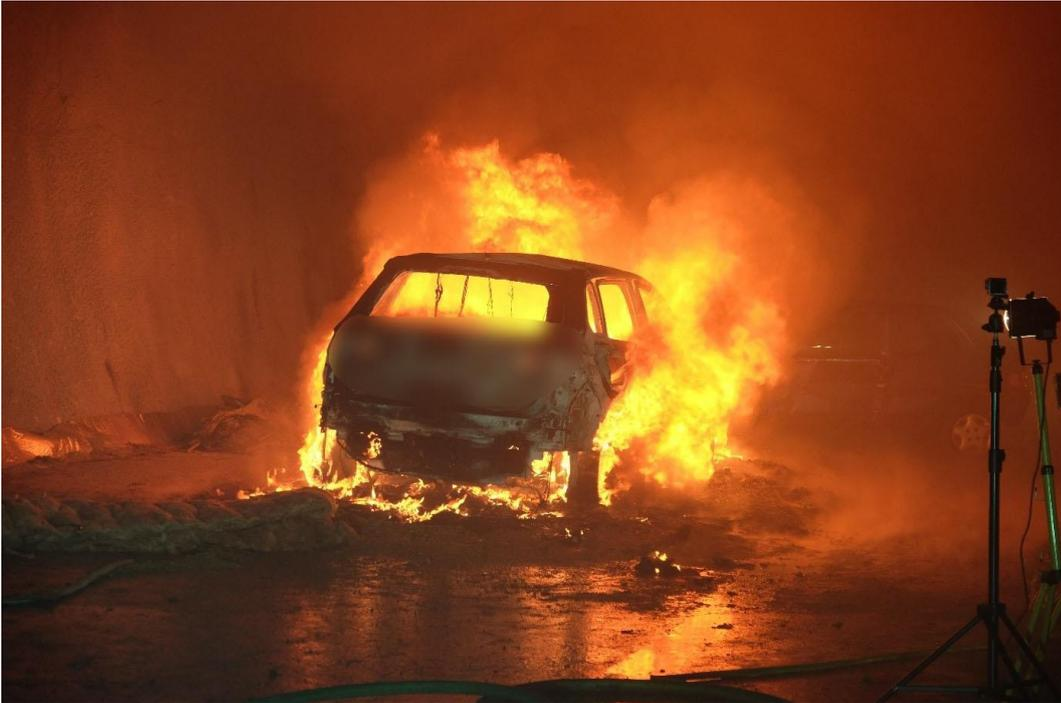
Abbildung 7-46 Brandverhalten 5. Fahrzeugbrandversuch
