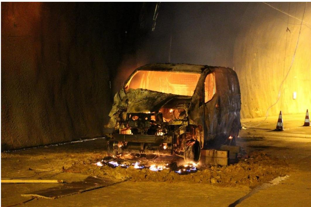
Abbildung 7-32 Versuchsträger nach dem 1. Fahrzeugbrandversuch
