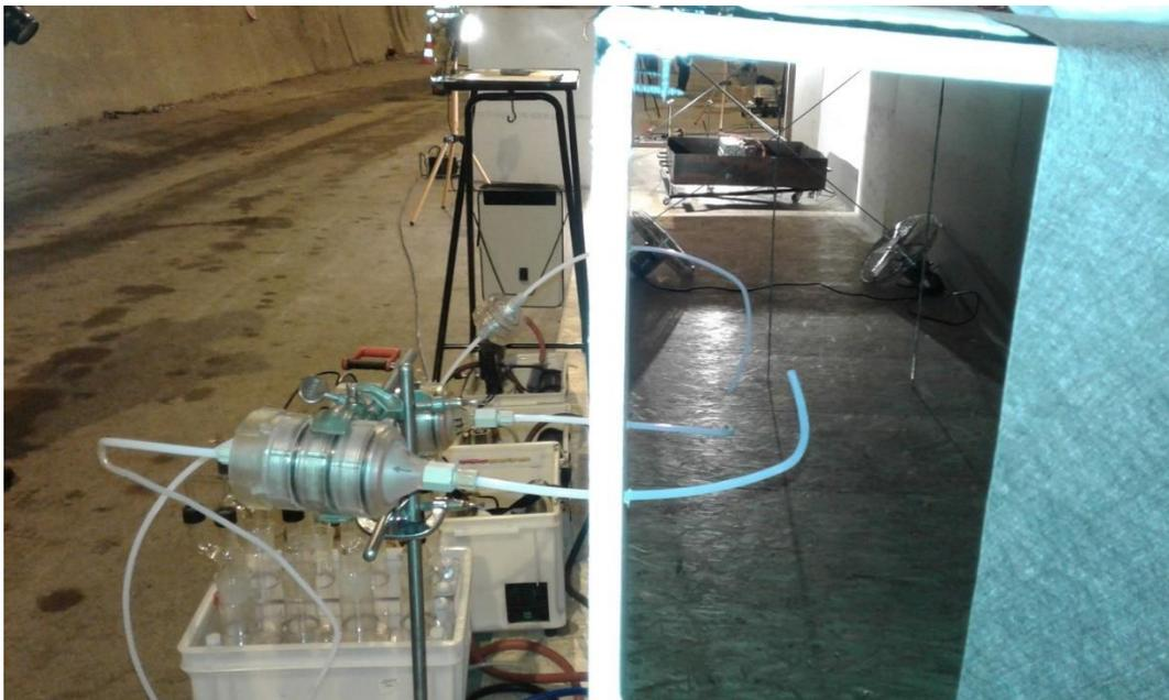
Abbildung 7-5 Einleitung der Teflonschläuche im Detail
