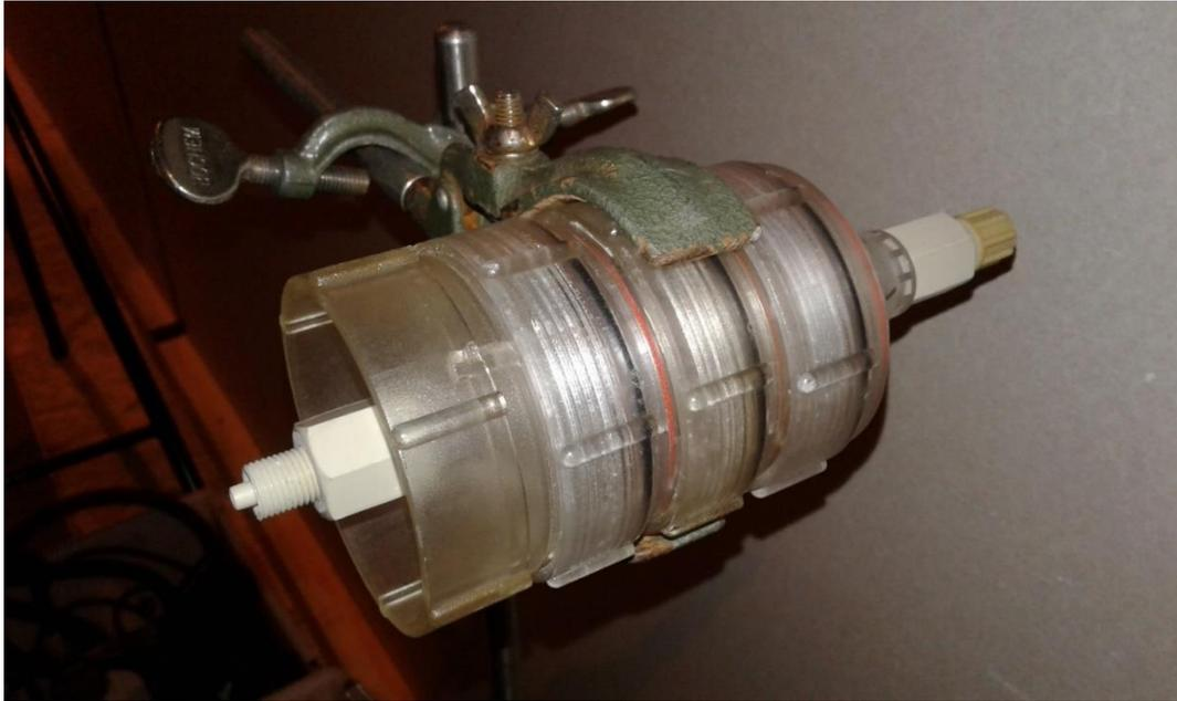
Abbildung 7-6 Exemplarische Darstellung eines Filterstacks
