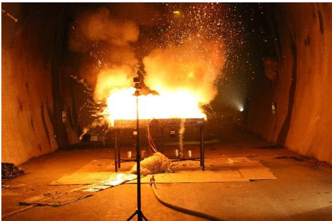
Abbildung 7-23 Brandverhalten 2. Versuch Batterypacks Typ B
