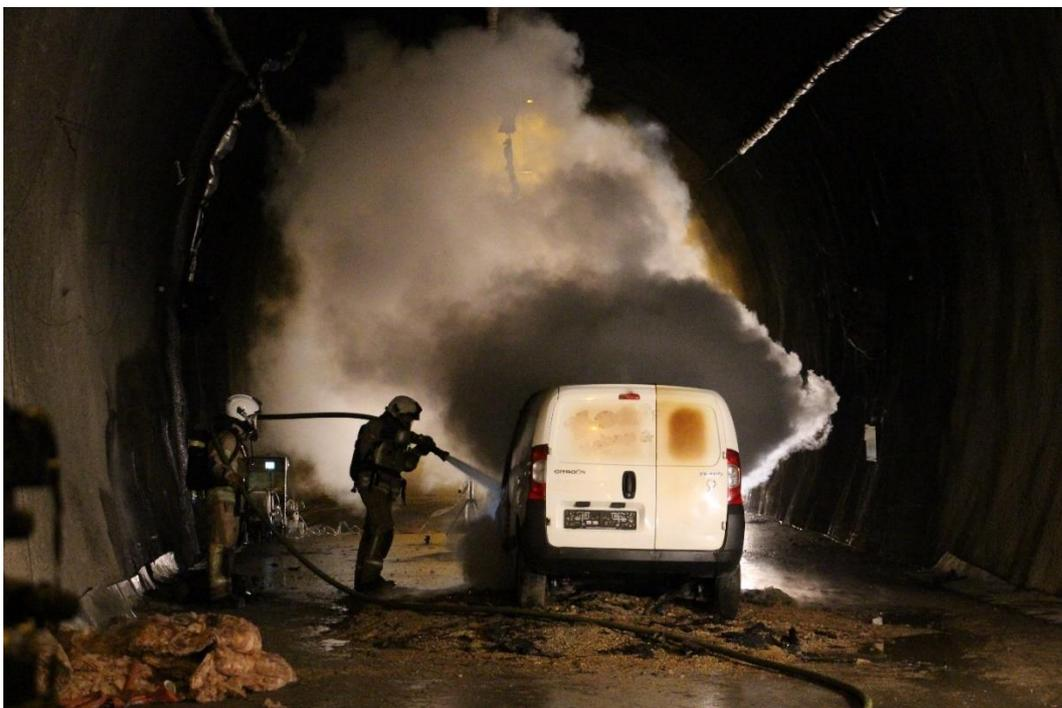
Abbildung 7-44 Versuchsträger nach dem 4. Fahrzeugbrandversuch
