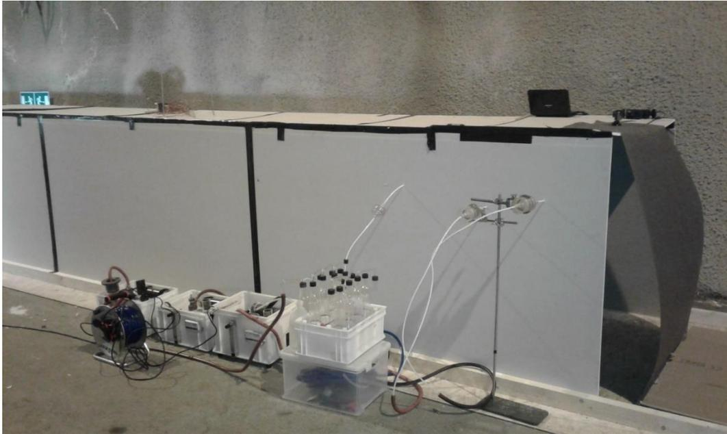
Abbildung 7-4 Anordnung der Gasesstechnik am Testtunnel
