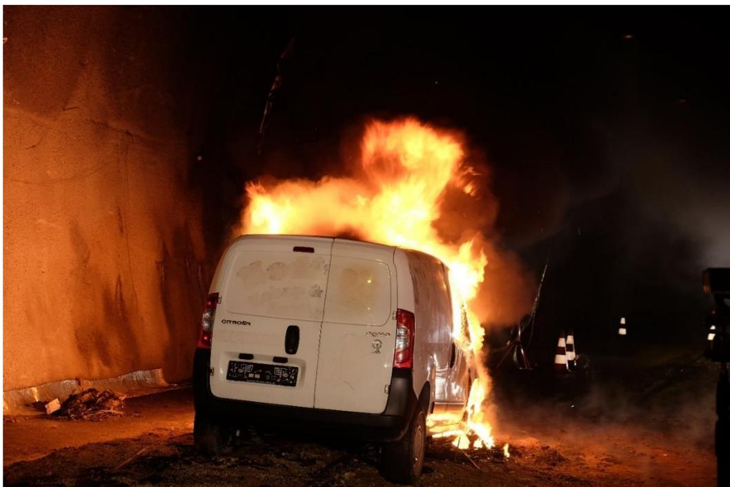
Abbildung 7-43 Brandverhalten 4. Fahrzeugbrandversuch
