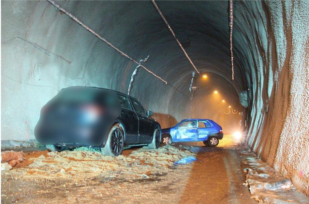
Abbildung 7-45 Versuchsträger und nebenstehender „Unfallgegner“ des 5. Fahrzeugbrandversuchs
