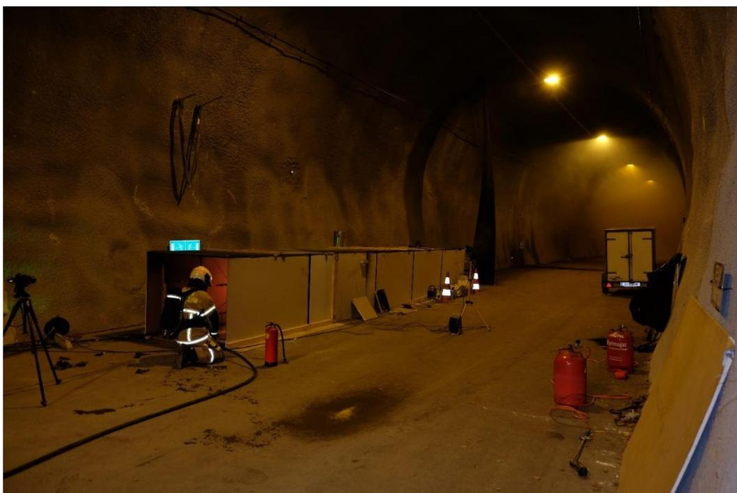
Abbildung 7-1 Testtunnel zur Durchführung der Brandversuche mit einzelnen Modulen
