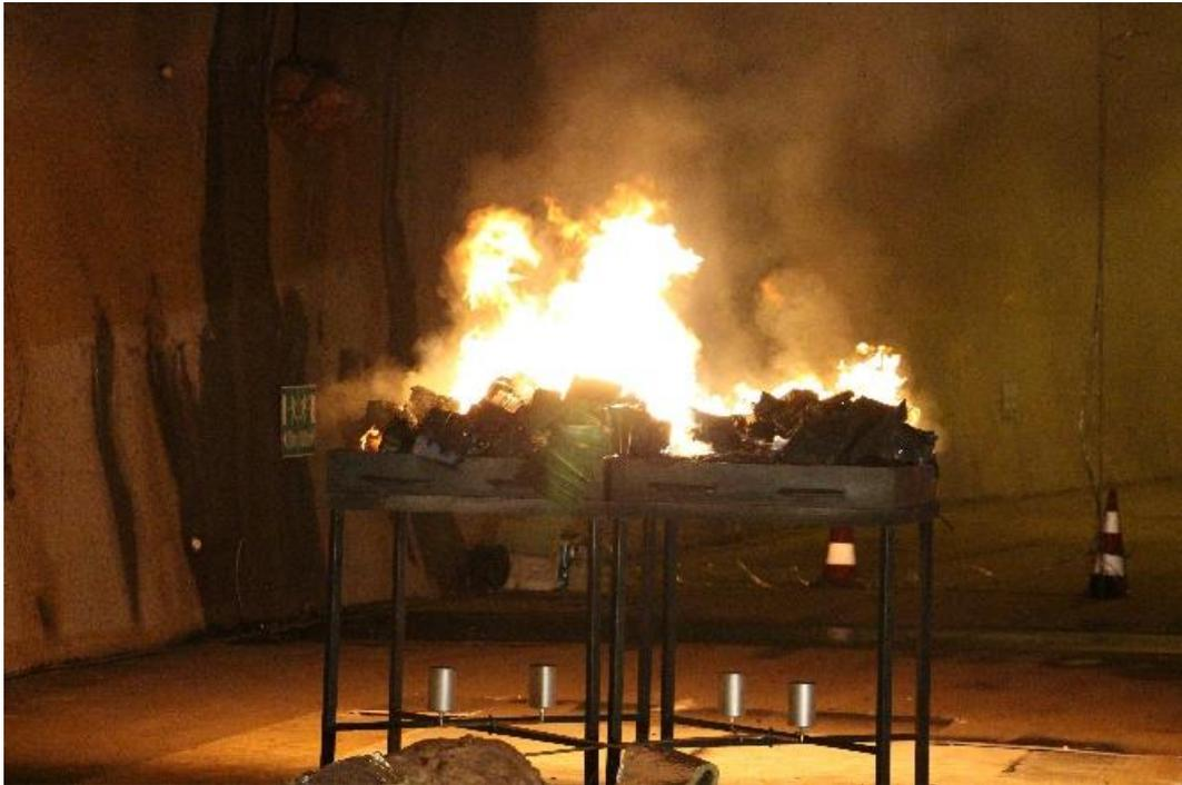
Abbildung 7-22 Brandverhalten 1. Versuch Batterypacks Typ C
