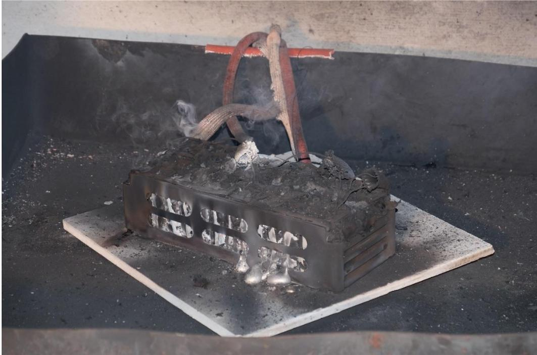
Abbildung 7-9 Exemplarische Darstellung eines abgebrannten Moduls
