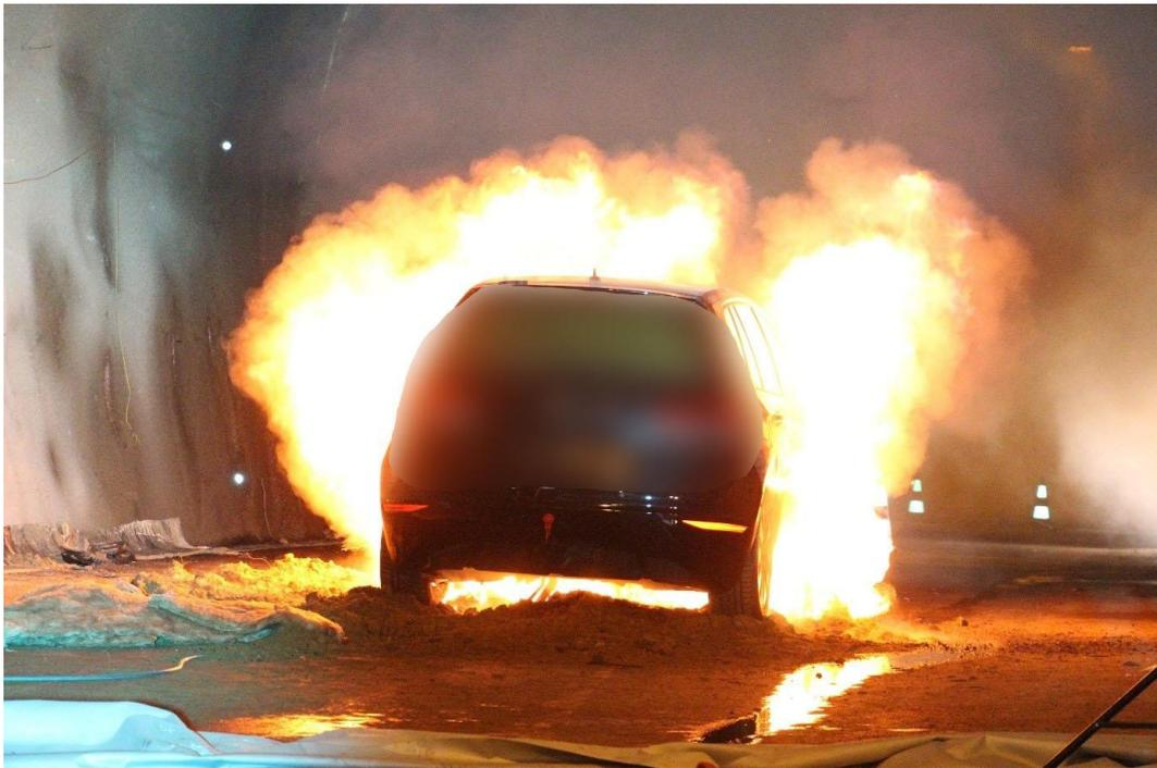
Abbildung 7-36 Brandverhalten 2. Fahrzeugbrandversuch
