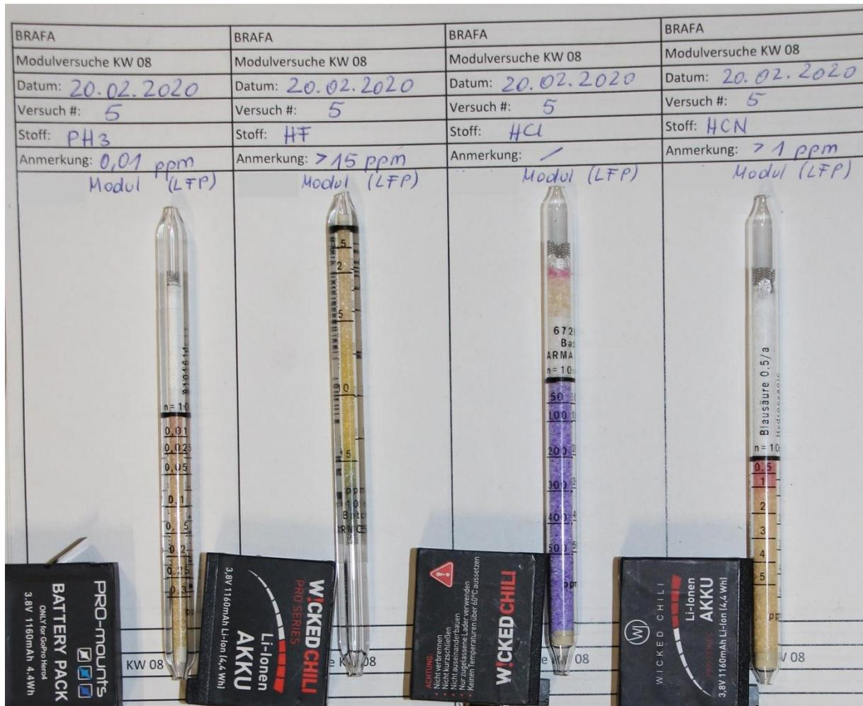
Abbildung 7-12 Exemplarische Darstellung verfärbter Dräger Röhren
