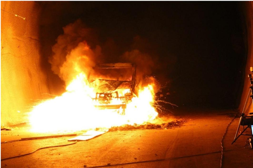
Abbildung 7-31 Brandverhalten 1. Fahrzeugbrandversuch
