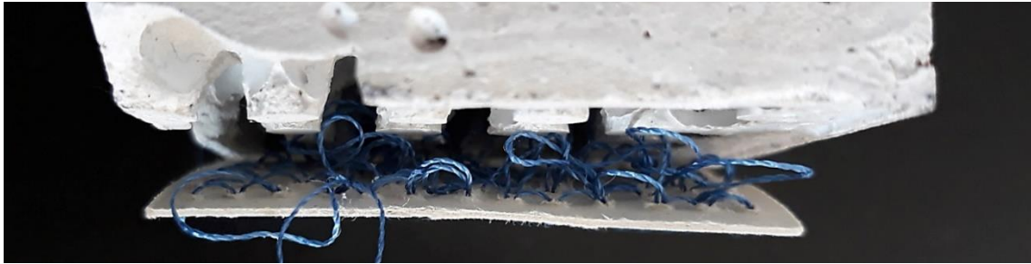
Abb. 132: Versuchskörper 2 unter Querlast resultierend aus der Versuchs-Schlaufenkomponente mit einer Schlaufenhöhe von 5 mm
