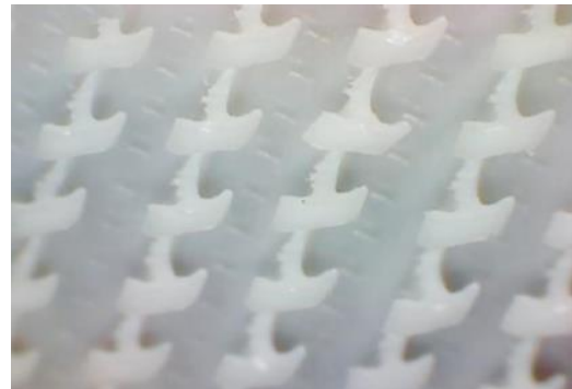
Abb. 45: Haken-Klettkomponente mit Y-förmigen Klettelementen, Krüger 2013, 11
