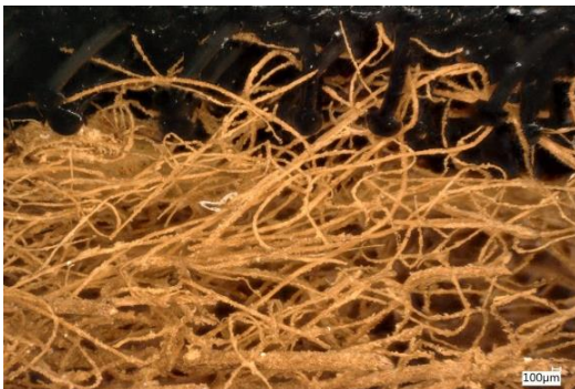
Abb. 39: Mikroskopische Detailaufnahme der Faserstruktur der Palme Livistona chinensis im Verbund mit dem Klettprodukt Pressotex® 75161, Florian Mittermayr, Institut für Materialprüfung und Baustofftechnologie, TU Graz
