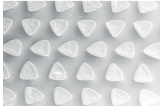
Abb. 53: Pilzkopf-Klett Komponente mit dreieckigen Klettelementen, Krüger 2013, 19
