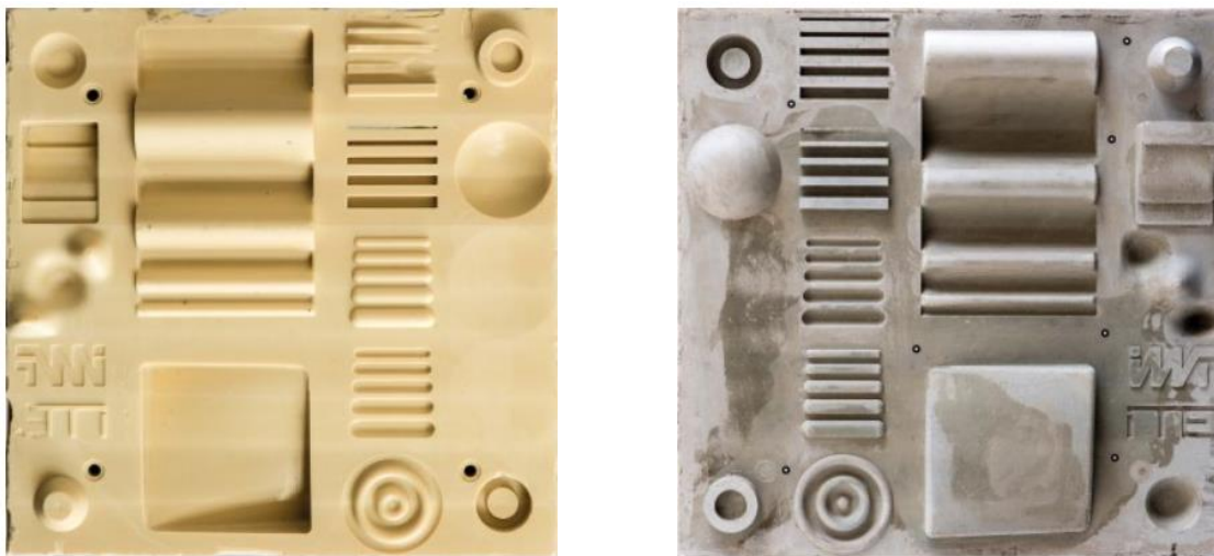
Abb. 84: Wachs Schalung nach dem Ablösen des UHPC-Betonkörpers (li) mit UHPC-Abguss (re), Mainka u.a. 2016, 790
