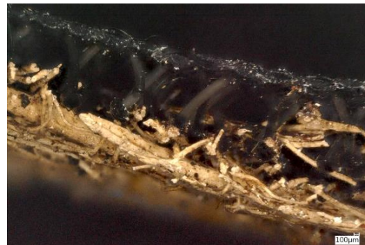
Abb. 40: Mikroskopische Detailaufnahme der Faserstruktur der Palme Cocos nucifera im Verbund mit dem Klettprodukt Pressotex® 75161, Florian Mittermayr, Institut für Materialprüfung und Baustofftechnologie, TU Graz
