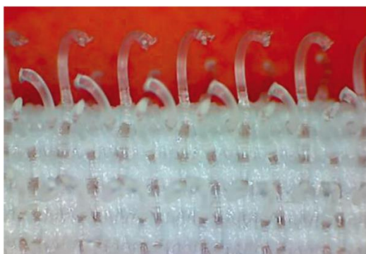
Abb. 42: Haken-Klettkomponente mit parabelförmigen Klettelementen, Krüger 2013, 12
