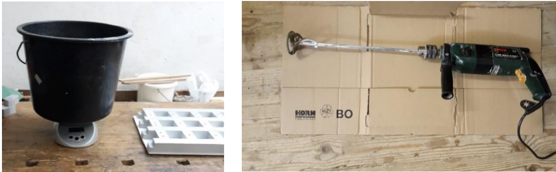
Abb. 139: Mischkübel und Schalungsstruktur aus extrudiertem Polystyrol (li), Bohrmaschine mit Rührkorb (re)
