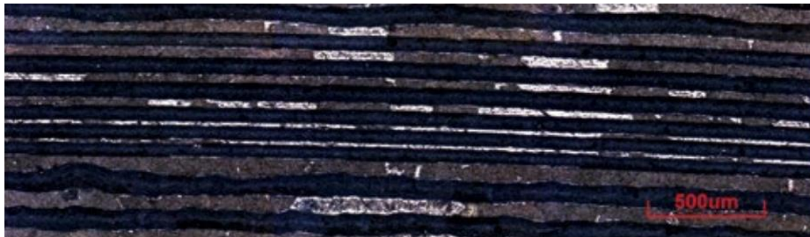
Abb. 24: Konfokalmikroskopische Aufnahme der Stereorille der UHPC-Schallplatte, Fontana 2016, 38
