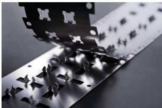
Abb. 47: Metaklett-Klettverbindung bestehend aus den Komponenten Flamingo und Lochblech, Höhe u.a. 2009, 44
