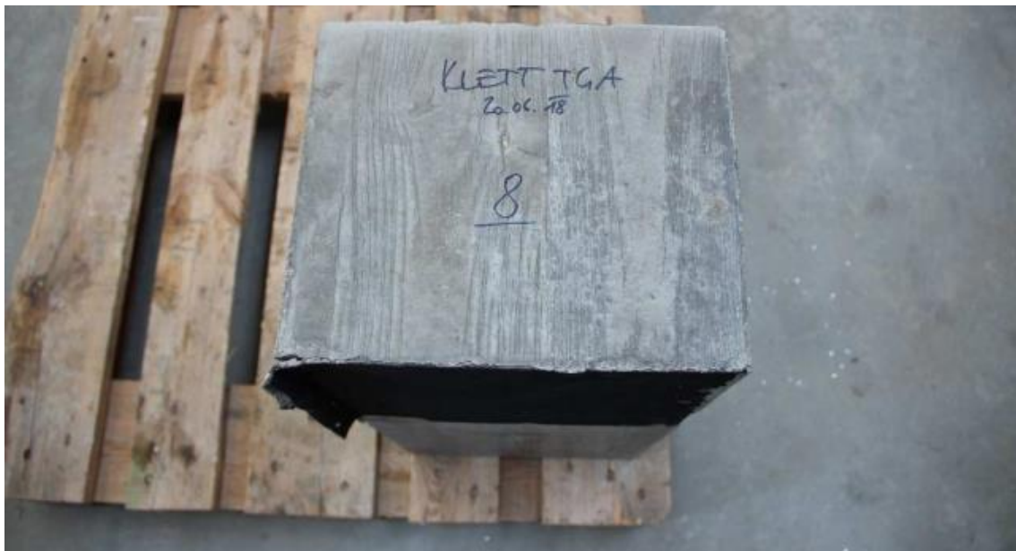
Abb. 14: Versuchsergebnis der Herstellung einer Schlaufenfläche auf Beton durch Einlegen in die Schalung, Freytag u.a. 2018, 48
