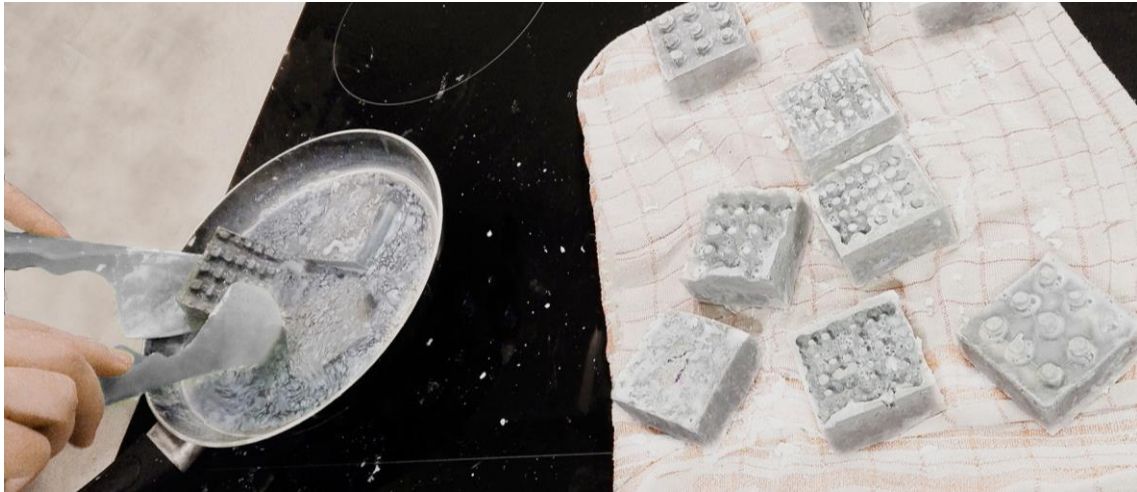
Abb. 141: Entformung der Wachskörper durch 90° C heißes Wasser
