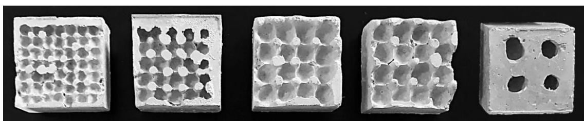
Abb. 128: Versuchskörper nach Entformung der Wachskörper v. l. n. r. 1, 2, 3, 4, 5
