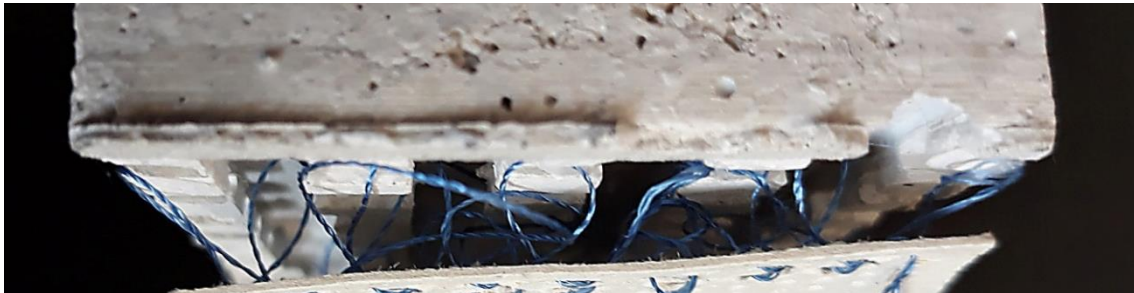
Abb. 101: Versuchskörper 3 unter Querlast resultierend aus der Versuchs-Schlaufenkomponente mit einer Schlaufenhöhe von 10 mm
