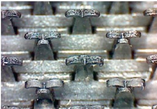
Abb. 44: Haken-Klettkomponente mit palmartigen Klettelementen, Krüger 2013, 13
