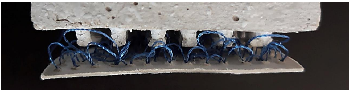
Abb. 112: Versuchskörper 1 unter Querlast resultierend aus der Versuchs-Schlaufenkomponente mit einer Schlaufenhöhe von 5 mm
