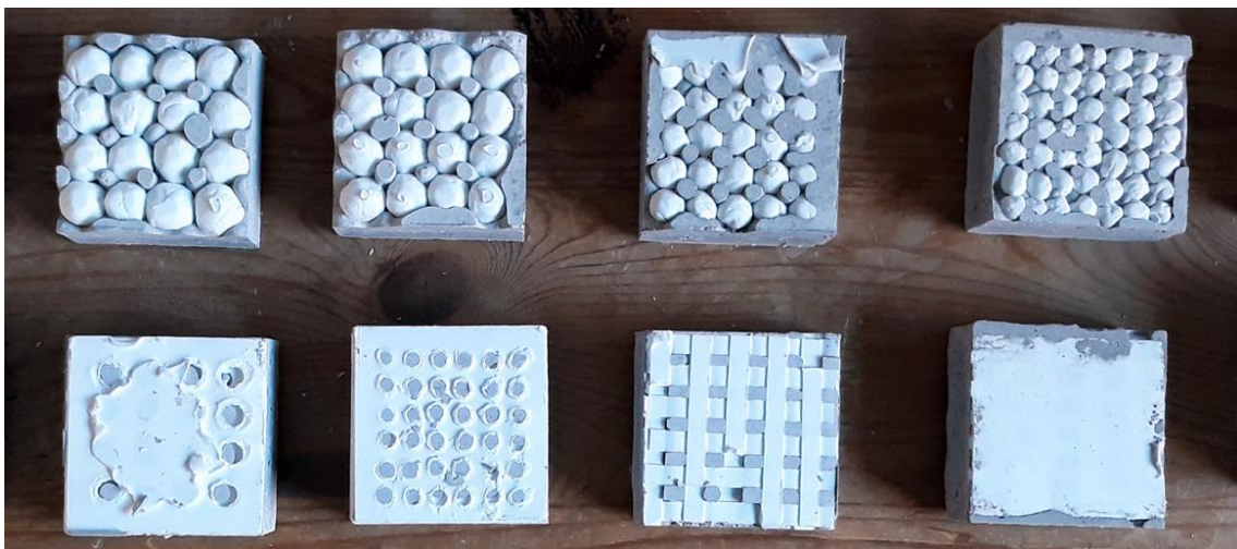
Abb. 140: Ausgeschaltete Versuchskörper im Verbund mit der Wachsschalung
