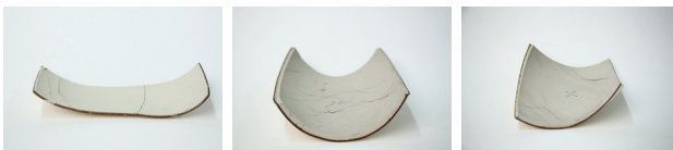
Abb. 5.3 Verformung durch Trocknung - Weitere Versuche
