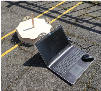
Abb. 3.7 Prototyp 1 - Testlauf für die Sonnenverfolgung über zwei Stunden
