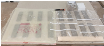
Abb. 3.19 Abgedeckte Trocknung - Gegen Risse und Verformung
