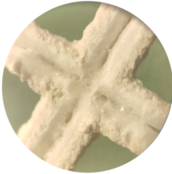
Abb. 3.26 Gesinterte und ausgelöste Struktur in 60-facher Vergrößerung
