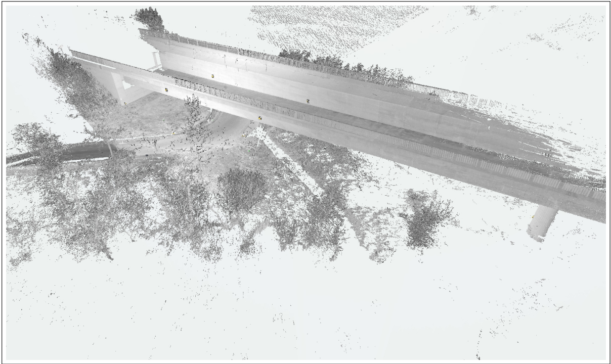
Abbildung 4.6: Ansicht aus der östlichen Perspektive auf die Punktwolke in Faro Scene. Durch Eingabe eines Hz- und V-Winkelwert konnte ein Kegelbereich definiert und gescannt werden. Durch die Aufnahme der näheren Umgebung wurde die Datenmenge sehr groß.
