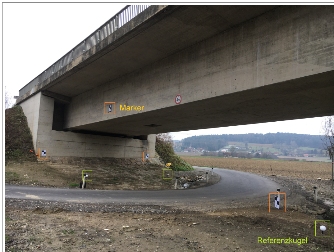
Abbildung 4.4: Ansicht auf den südöstlichen Scanbereich. Die Zielmarken (Orange markiert) wurden am Objekt und an den Straßenpfosten befestigt. Die Referenzkugeln (Gelb markiert), für eine Verknüpfung der beiden Punktwolken, wurden gut verteilt am Boden zwischen den Aufnahmen Standpunkten positioniert.
