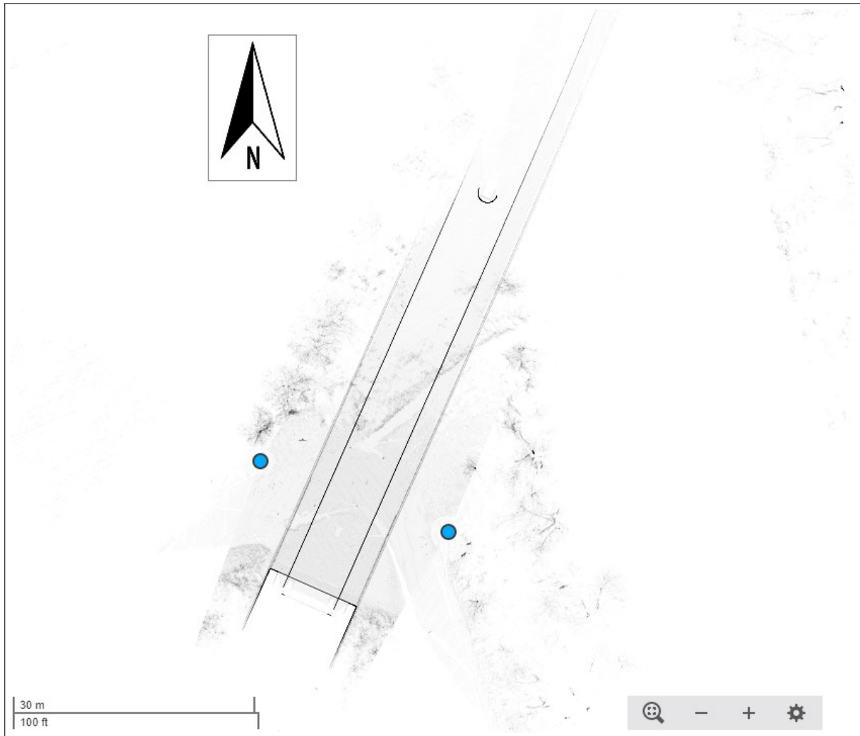
Abbildung 4.8: Die Übersichtskarte ist eine Draufsicht des Projektgebietes. Die Karte wurde als Bild in Graustufen dargestellt. Die blauen kreisförmigen Markierungen repräsentieren die beiden Faro Focus 3D X330 Standpunkte.
