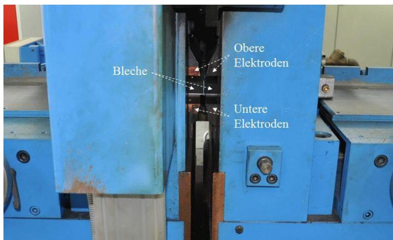
Abbildung 3-2: Kernstück der IDEAL AS100/STS Schweißanlage, die für PS- und ABS-Schweißungen eingesetzt werden kann. Das Bild wurde nach einem konduktiven PS-Schweißversuch aufgenommen.
