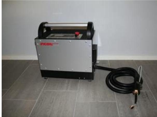
Abbildung 4-26: Nadelinduktor für die Wärmenachbehandlung längsnahtgeschweißter Rohre, die mit induktiven HF-Schweißprozess hergestellt wurden. [voestalpine Stahl GmbH]
