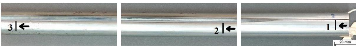
Abbildung 4-23: Makroskopische Aufnahmen vom S460HC Baustahlrohr, der mit dem induktiven HF-Schweißverfahren geschweißt wurde. Positionen 1, 2 und 3 sind die Schnittebenen für die Schliffherstellung. Pfeile beschreiben die Blickrichtung.
