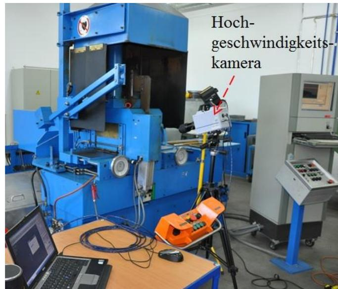
Abbildung 3-7: Hochgeschwindigkeitskamera der Fa. Kodak mit der Modellnummer 4549 vor der IDEAL AS100/STS Schweißanlage.
