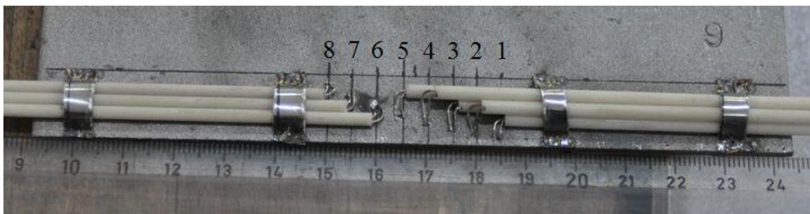
Abbildung 3-6: Position der angeschweißten Thermoelemente am S355J2+N Stahlblech zur Messung der Temperatur-Zeit-Verläufe während dem konduktiven PS-Schweißversuch.
