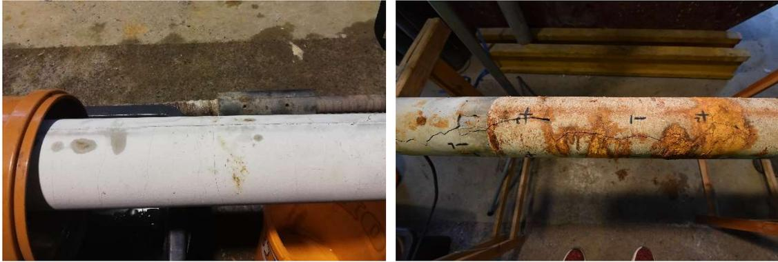
Abb. 55: Links: Querrisse beim Spannen; Rechts: Längsriss nach dem Ausbau
