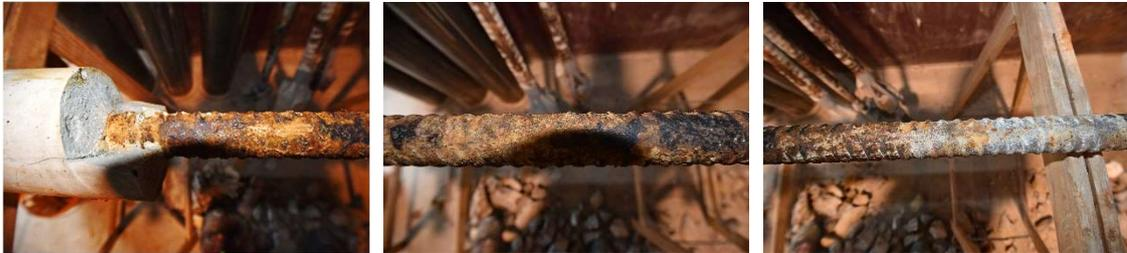
Abb. 53: Links: Unteres Ende mit verbleibenden Betonkörper; Mitte: Mitte Stab mit Korrosionsschäden; Rechts: Oberes Stabende
