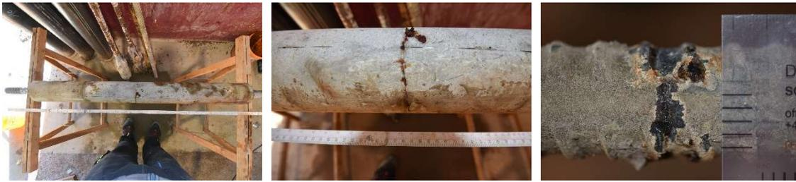
Abb. 50: Links: Versuchskörper mit Meterstab; Mitte: Querriss B mit Korrosionsablagerung; Rechts: Korrosion am Bewehrungsstab
