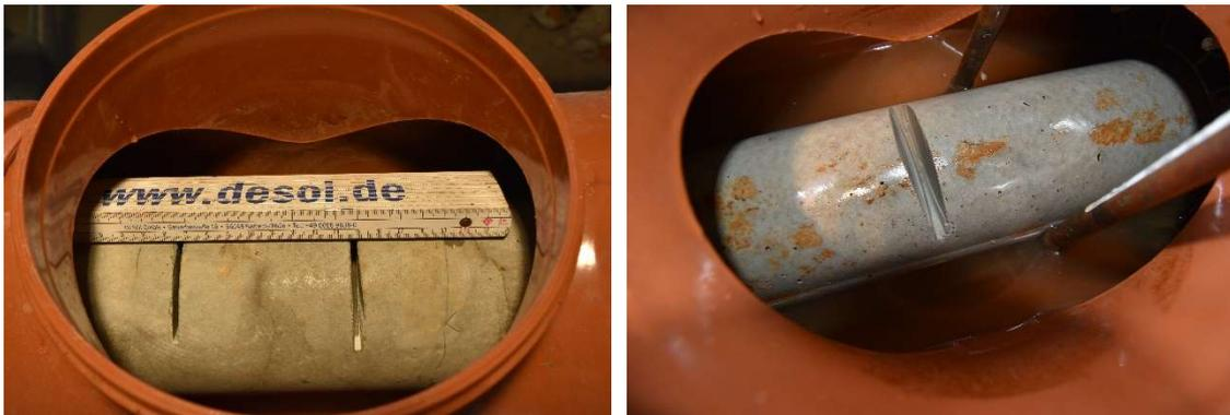
Abb. 38: Künstliche Schädigungen an der Zementsteinüberdeckung; Links: DAT\_VK\_02 – zwei parallele Schnitte; Rechts: DAT\_VK\_03 – keilartiger Einschnitt
