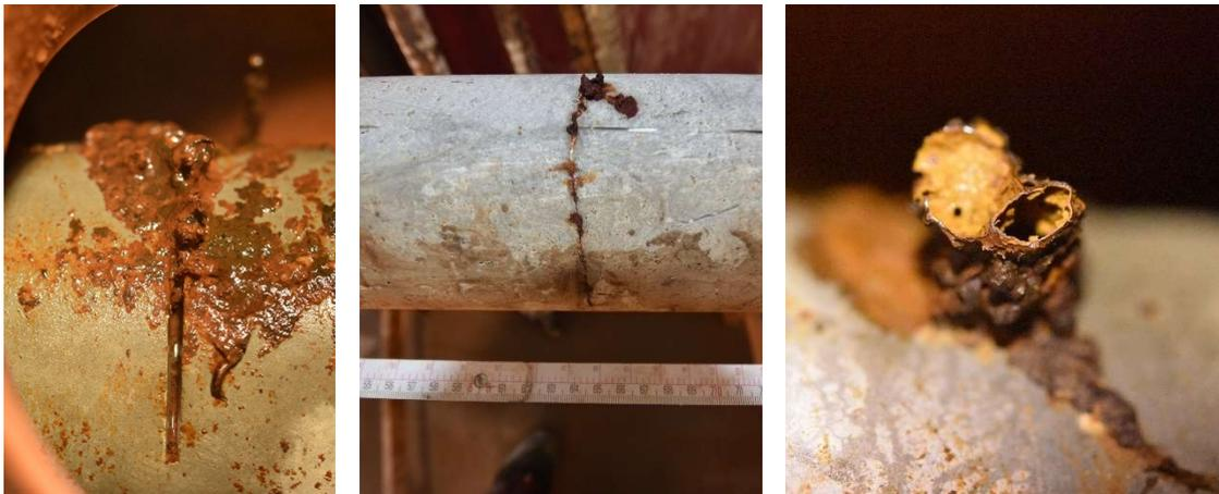
Abb. 56: Beispiele für Korrosionsprodukte
