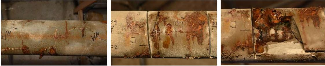
Abb. 45: Links: Rissbild des Versuchskörpers, Mitte: Längsriss B1, Rechts: Korrosion durch Längsriss B1
