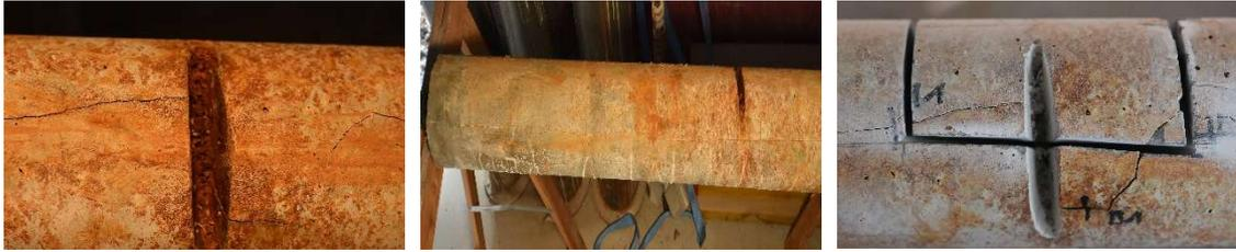
Abb. 47: Links: Ablagerungen im Bereich des Einschnittes, Mitte: DAT\_VK\_03 nach der Korrosion, Rechts: Einschnitt während des Freilegens
