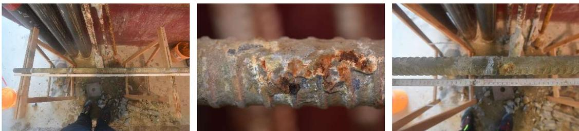
Abb. 49: Links: Versuchskörper mit Meterstab, Mitte: Korrosion mittig im Stab, Rechts: Einfluss Abstandhalter
