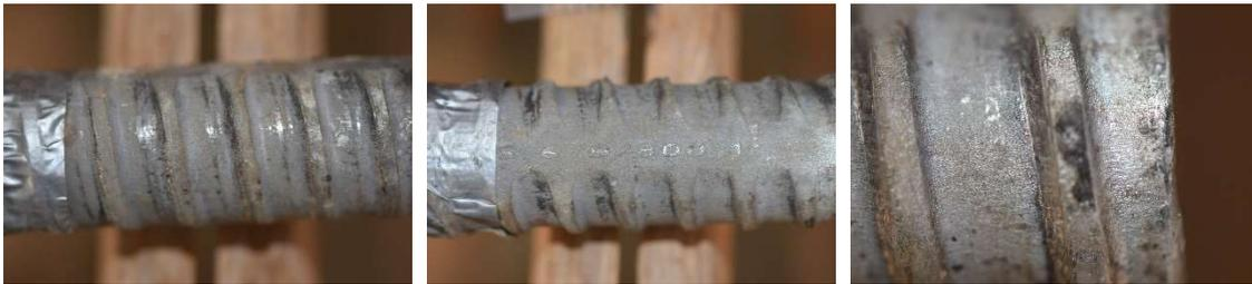
Abb. 51: Beschädigung der Verzinkung im Bereich der Muffe
