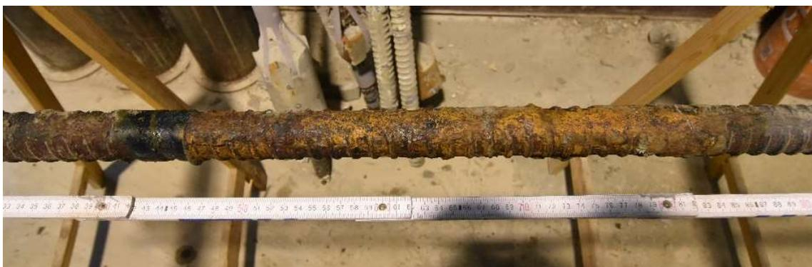
Abb. 54: Korrosion über die gesamte Länge der Korrosionswanne
