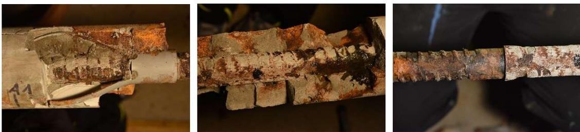
Abb. 44: Links: Korrosion und Rissbild im Bereich eines Abstandhalters, Mitte: Korrosion durch Einlagerung des Elektrolytes in den Versuchskörper, Rechts: Korrosionserscheinungen in der Auflagefläche des Abstandhalters
