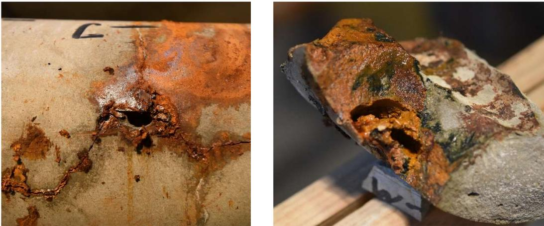
Abb. 58: Beispiele für Korrosionsprodukte in Luftporen bzw. Verdichtungsnestern
