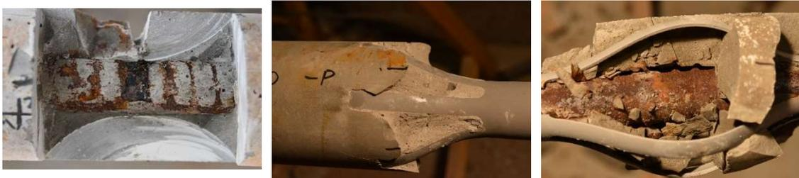
Abb. 48: Links: Korrosion im Bereich der Schwächung, Mitte: Rissbild beim oberen Abstandhalter, Rechts: unterer Abstandhalter
