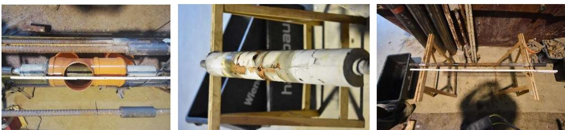
Abb. 52: Links: Zweiter Korrosionsabschnitt; Mitte: DAT\_VK\_06 nach dem Ausbau; Rechts: Freigelegter Bewehrungsstab
