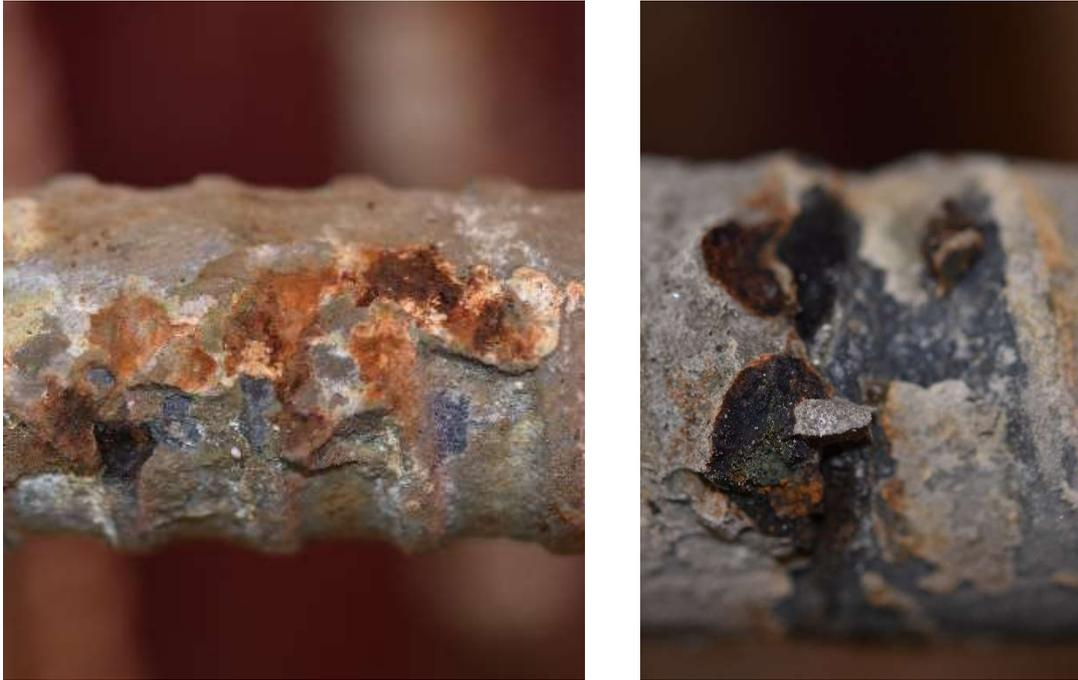
Abb. 57 Lochfraßkorrosion bei DAT\_VK\_04
