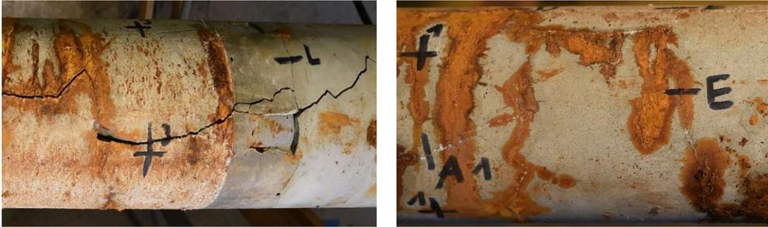
Abb. 39: Links: Riss entstanden während dem Entspannen; Rechts: Risse welche während dem Spannen entstanden sind und daher auch Korrosionsablagerungen aufwiesen
