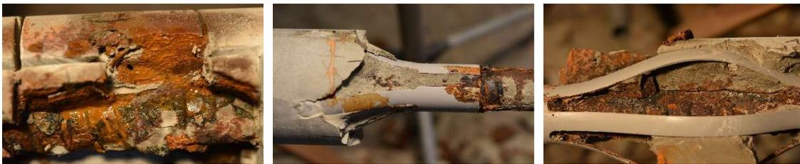
Abb. 46: Links: Einfluss der Querschnittsschwächung auf die Korrosion, Mitte: Oberer Abstandhalter, Rechts: Unterer Abstandhalter
