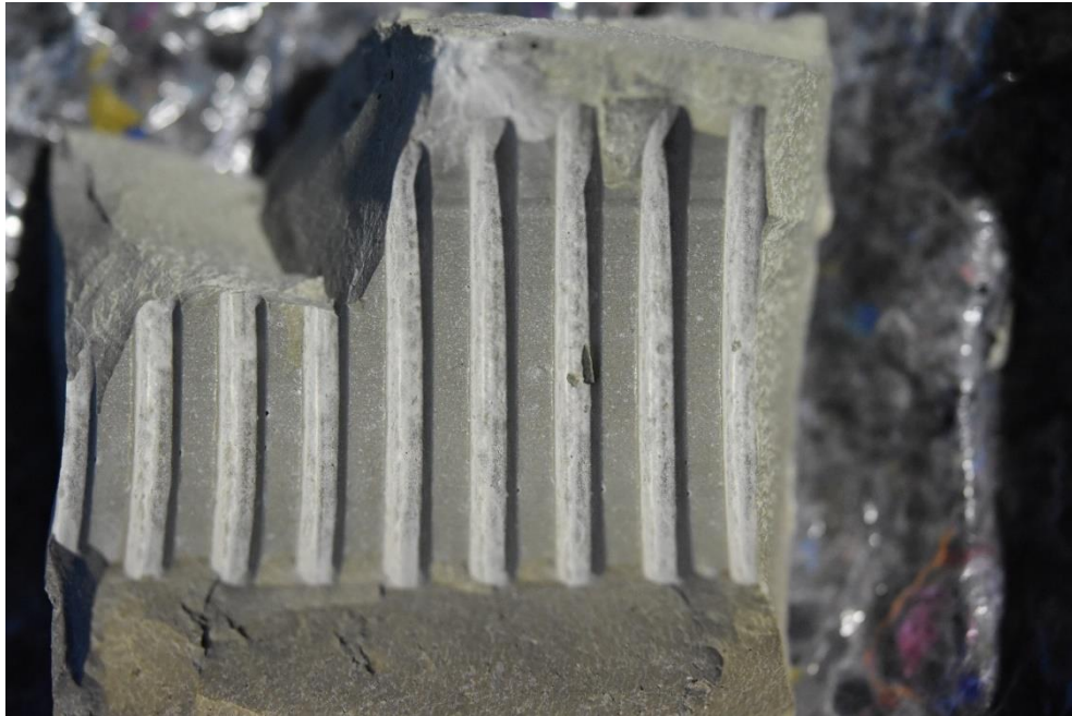
Abb. 30: Bruchstück des äußeren Verpresskörpers mit Verbundrippen
