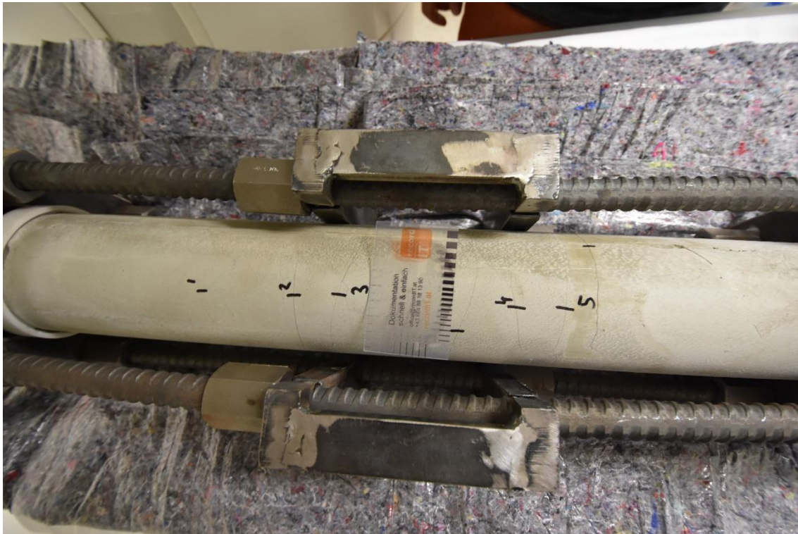
Abb. 24: Rissbild in V2_DAT_DCP_01 mit 100\% * F_{\max}
