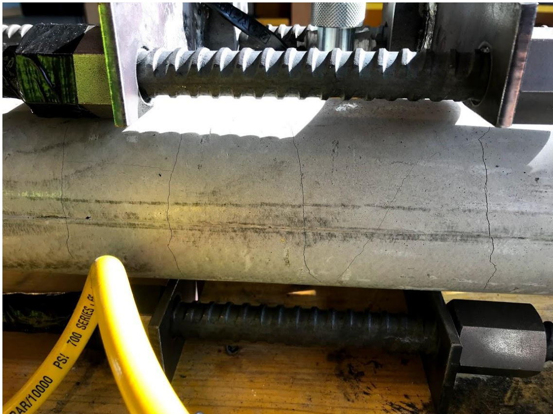
Abb. 21: Voruntersuchung – Rissentwicklung unter 50\% \cdot F_{\max}
