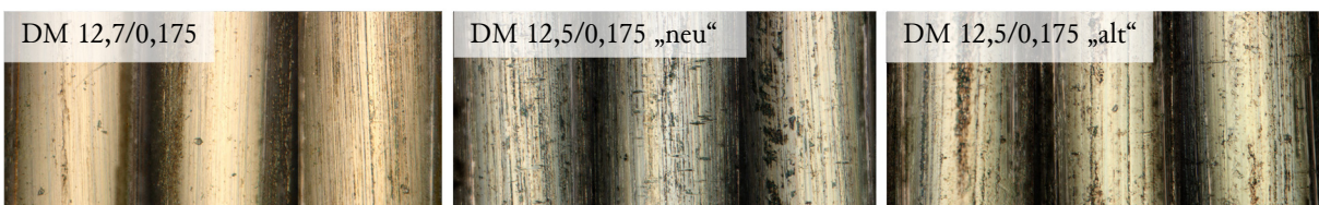
Abbildung 3.2 – Stahlfasern unter dem Mikroskop (x2000)
