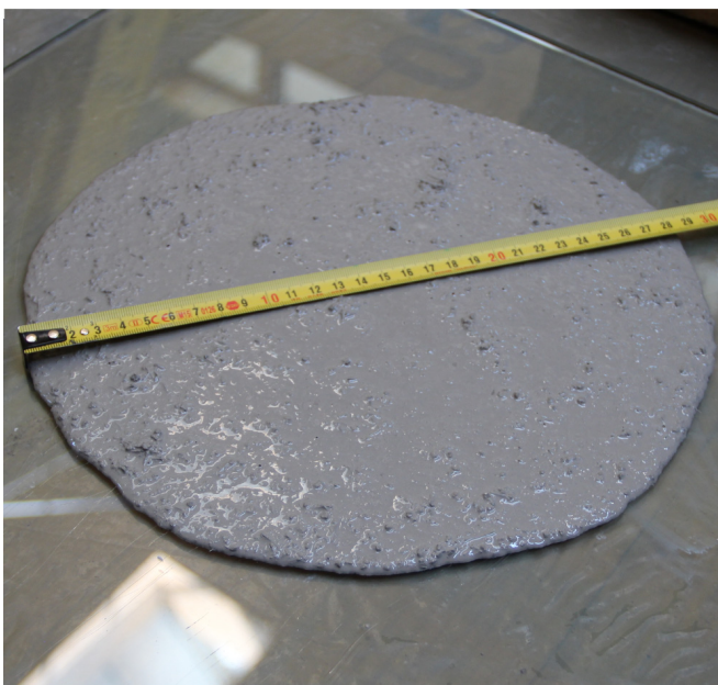
Abbildung 5.13 – Fließmaß auf trockener Glasplatte, Charge 1 (links) und Charge 2 (rechts)
