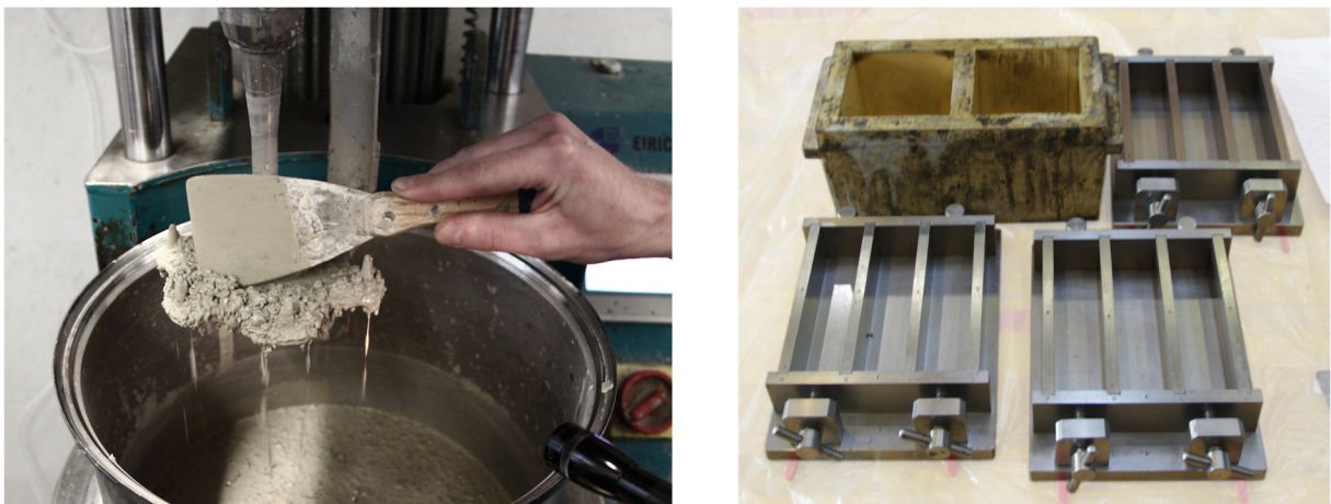
Abbildung 3.4 – Eirich – Mischer mit Stiftwirbler (links), eingesetzte Betonformen (rechts)
