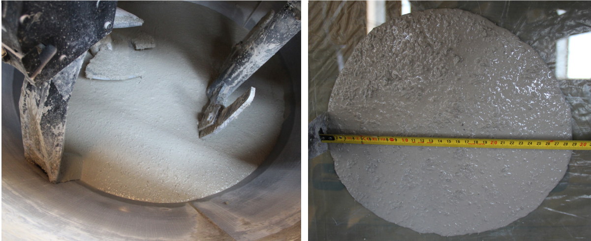
Abbildung 4.29 – Blick in den Mischer (links), Fließmaß auf trockener Glasplatte (rechts)
