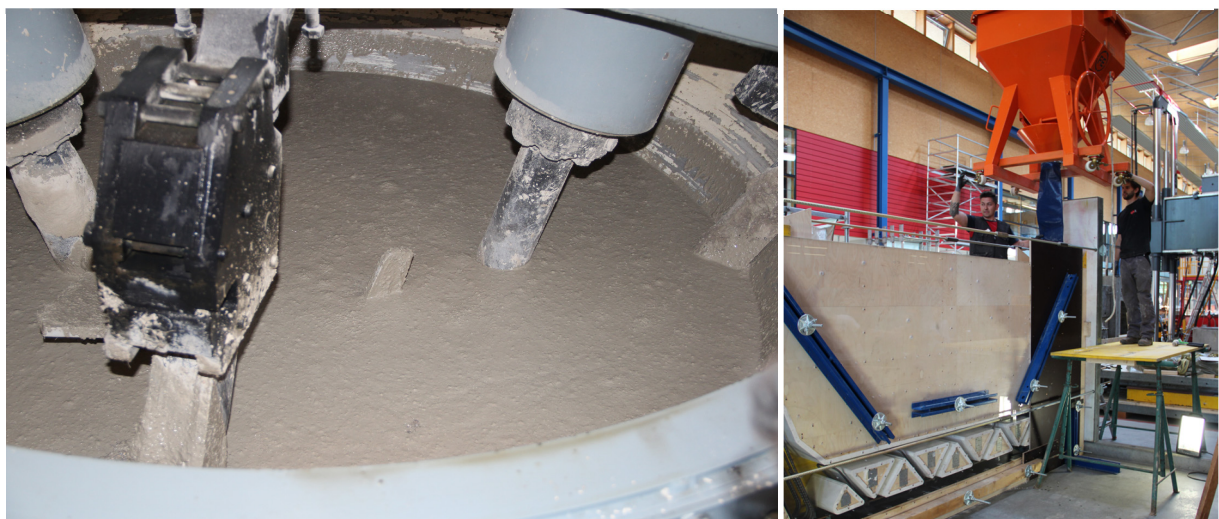
Abbildung 5.5 – Mischung im SKAKO-Mischer (links), Einfüllen des UHPCs in die Schalung (rechts)
