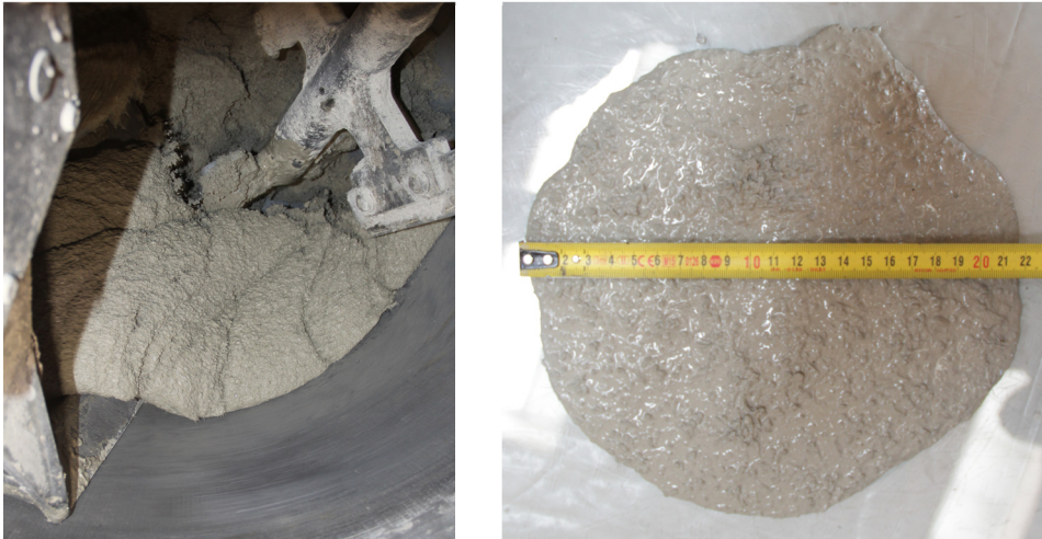
Abbildung 4.40 – Blick in den Mischer (links), Fließmaß auf trockener Glasplatte (rechts)
