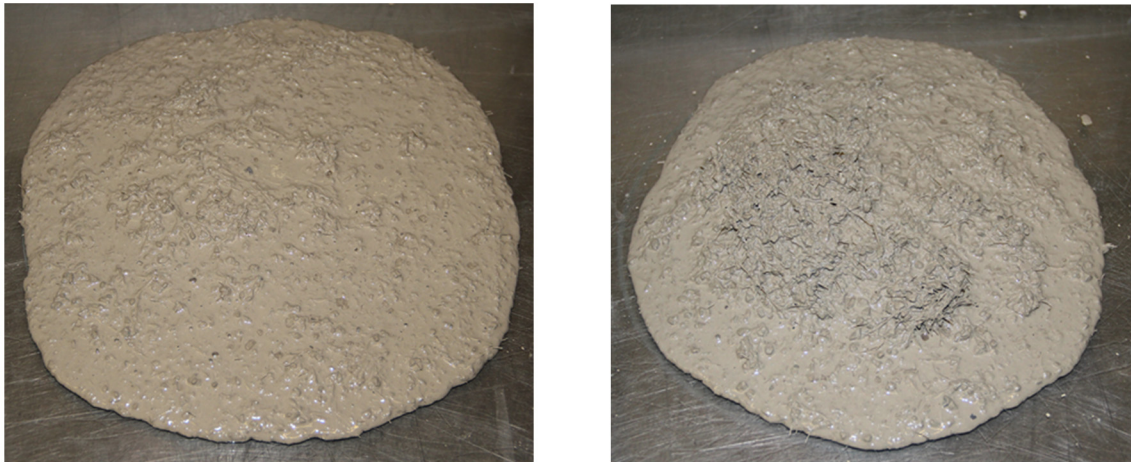
Abbildung 3.12 – Fließmaß auf trockener Glasplatte, Rezeptur 9 (links) und Rezeptur 9 mit 1,75 Vol-% Fasern (rechts)
