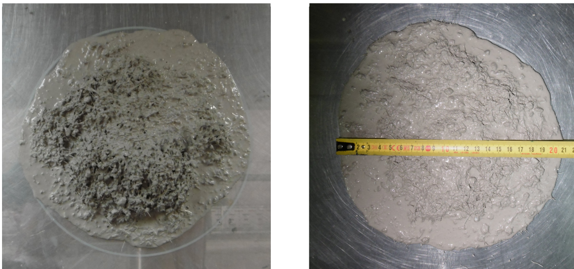
Abbildung 3.10 – Fließmaß auf trockener Glasplatte, Rezeptur 7 (links) und Rezeptur 8 (rechts)
