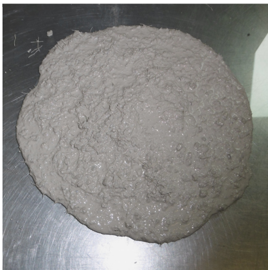
Abbildung 3.6 – Fließmaß auf trockener Glasplatte, Rezeptur 1 (links) und Rezeptur 2 (rechts)
