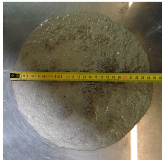
Abbildung 3.11 – Fließmaß auf trockener Glasplatte, Rezeptur 9 (links) und Rezeptur 9 mit Mischpause (rechts)
