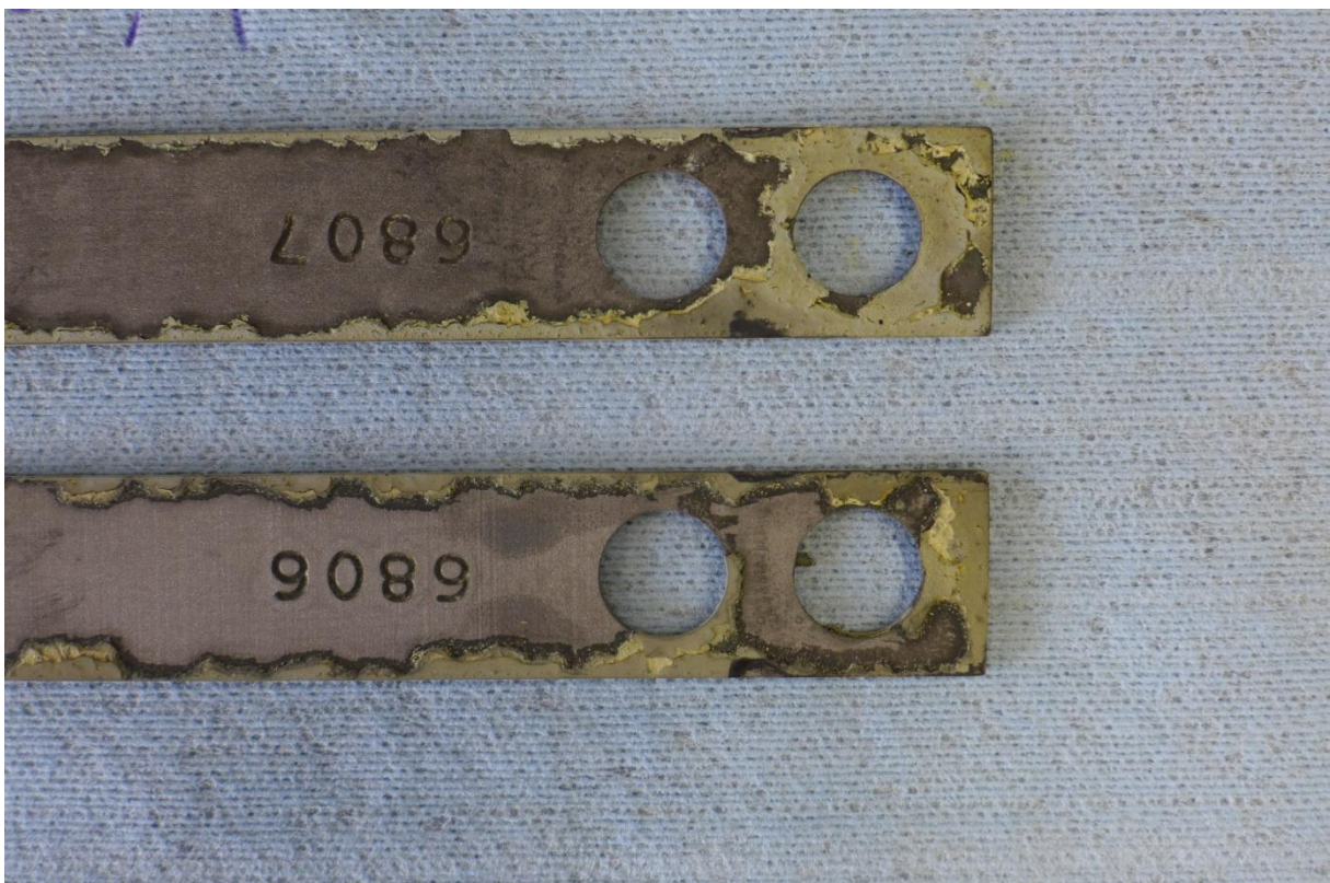
Abbildung 46: Zn-Ni Proben bei pH3 unter 50 °C nach Korrosionstest im Autoklaven.
