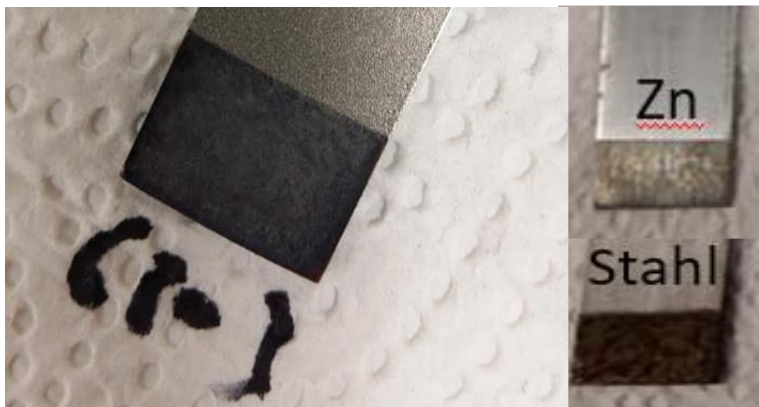
Abbildung 20: Zn-Ni beschichtete Probe 6803 sowie Zn und Stahlprobe nach Polarisation .
