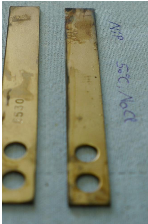
Abbildung 59: Ni-P unter 50 °C in 3% NaCl nach Korrosionstest.
