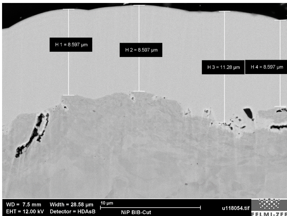
Abbildung 49: REM: Querschliffaufnahme der Ni-P beschichteten Probe 6539.
