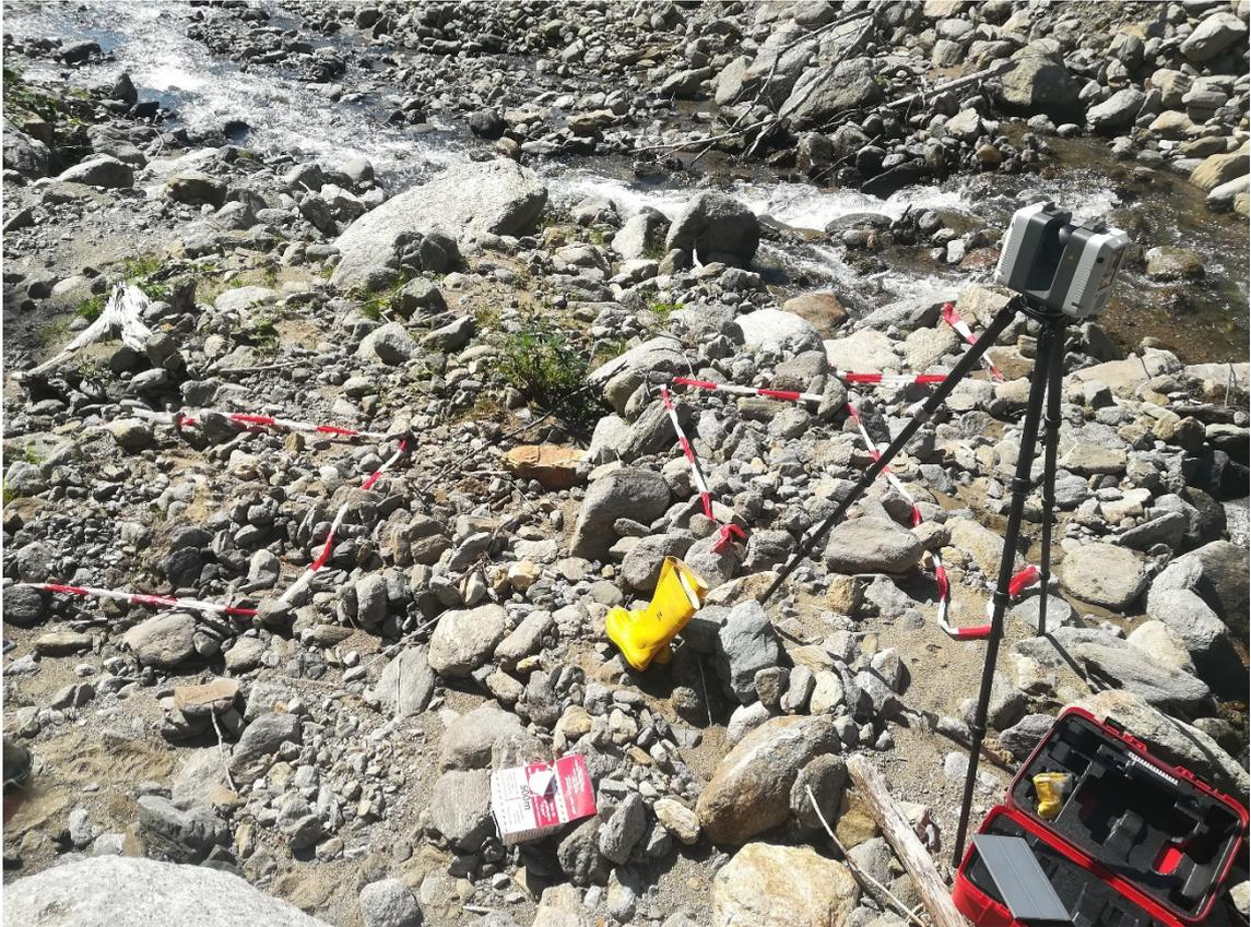
Abbildung 20: Messung Oberwölz: Leica Laserscanner, und im Hintergrund Bereich für Auswertung mittels Basegrain
