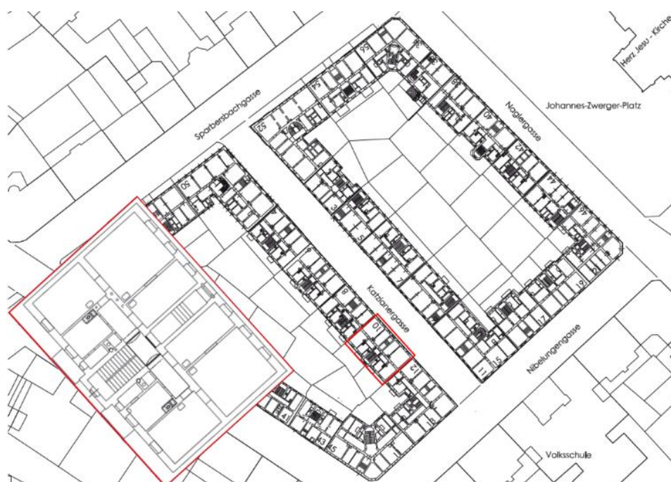
Abbildung 2-15 typischer Grundriss eines Grazer Gründerzeitblockes [5]
