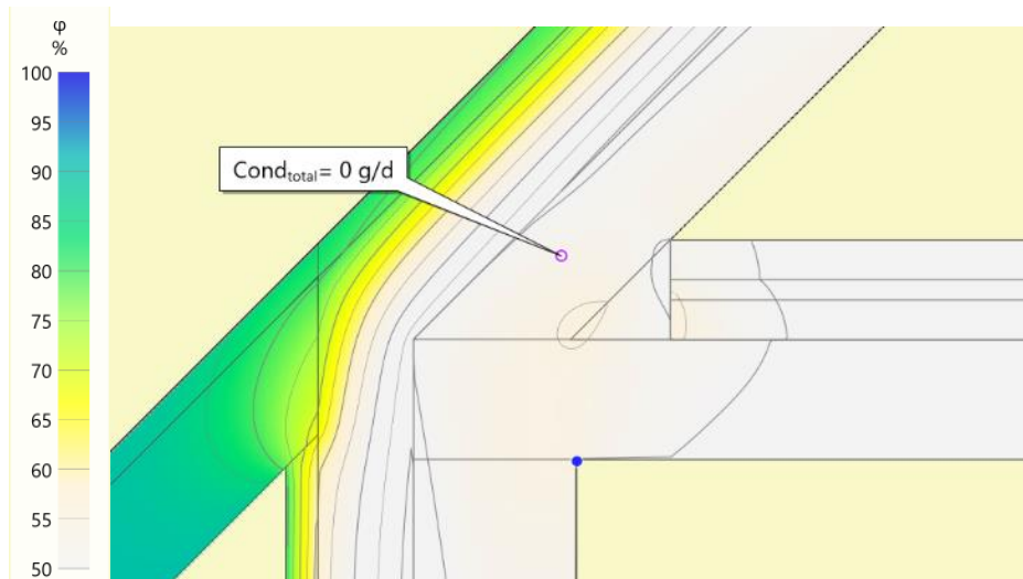
Abbildung 6-31 Kondensat im Bauteil - DetailB
