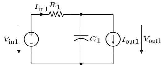
Figure 2.1: SubCircuit-Model: simple RC-circuit.
