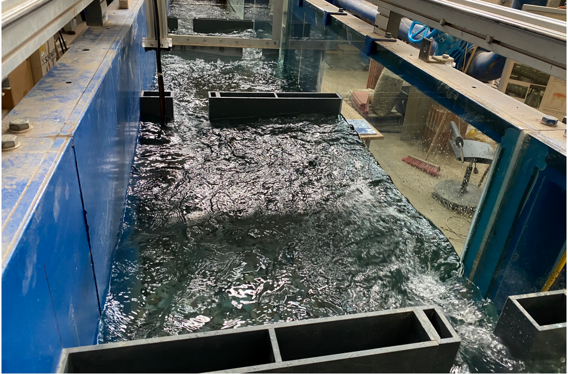
Abbildung 31: Betrieb TB Modell mit Bemessungsdotation (33 l/s)
