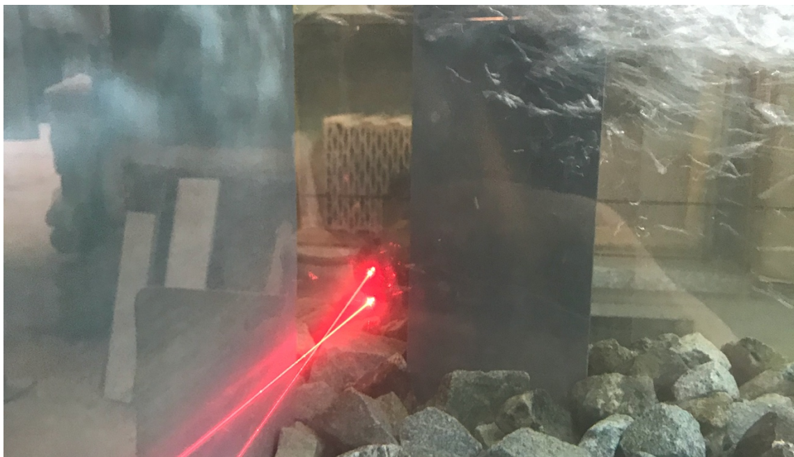
Abbildung 37: Geschwindigkeitsmessung mittels LDA-Methode
