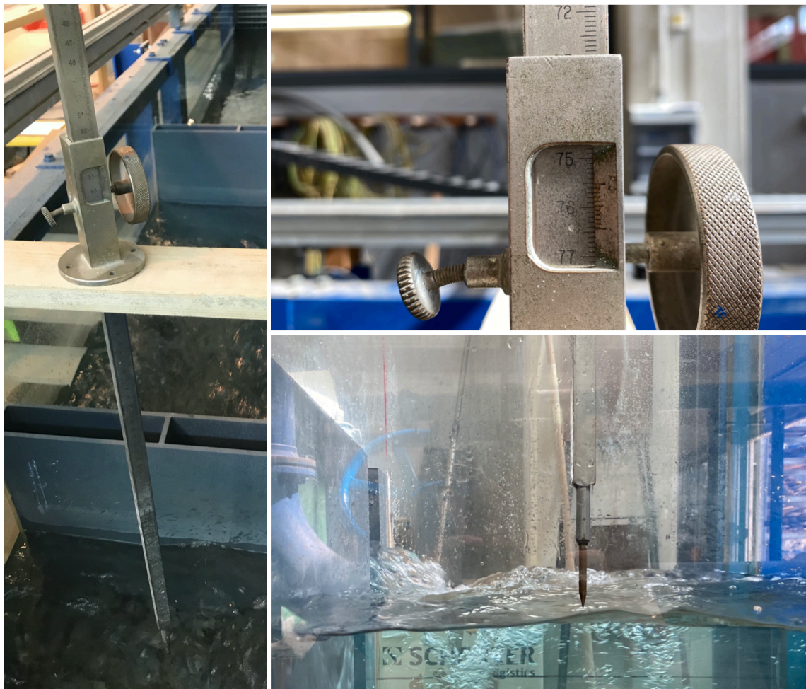
Abbildung 33: Begleitende Kontrollen mittels Stechpegelmessungen
