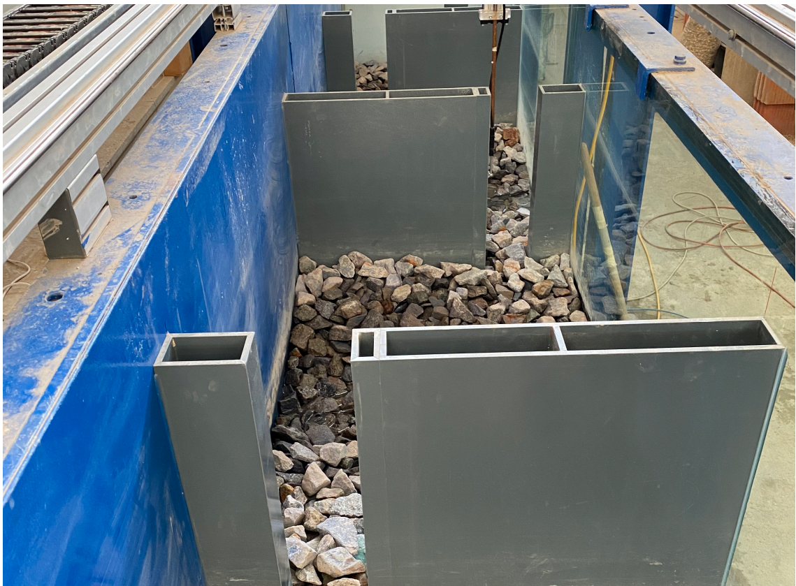
Abbildung 27: Modellaufbau Technischer Beckenpass im Glasgerinne
