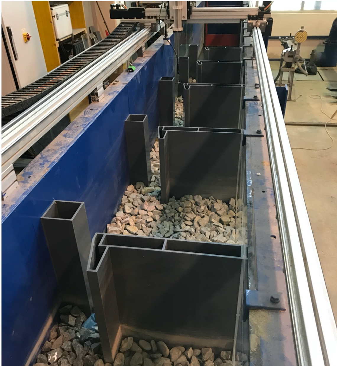
Abbildung 20: Modellaufbau Vertical Slot Schlitzpass im Glasgerinne
