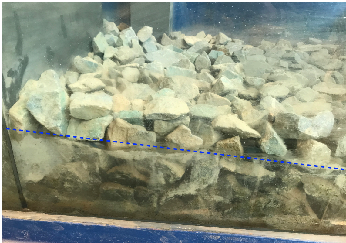
Abbildung 23: Sohlsubstrat VS mit Abdichtungsfolie (blaue Strichlinie)
