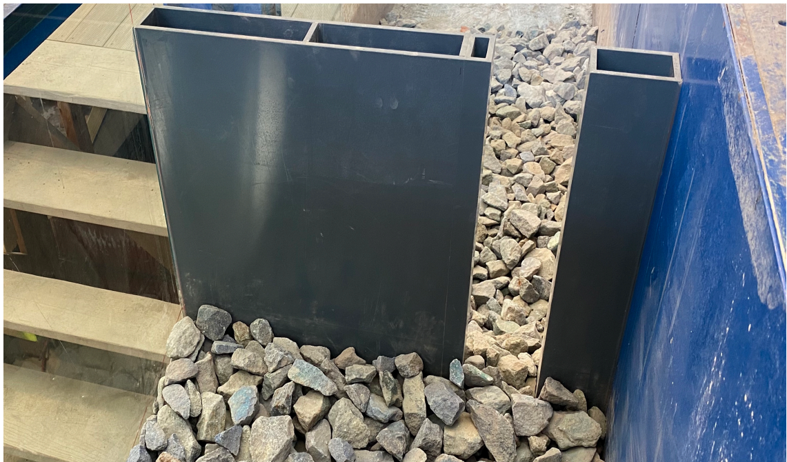
Abbildung 28: Trennwand im Technischen Beckenpass Modellaufbau
