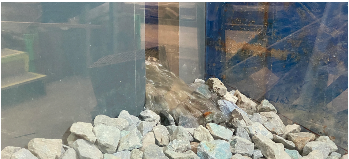
Abbildung 32: Beckenübergang TB während Füllvorgang
