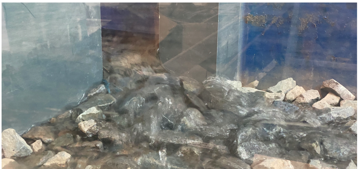
Abbildung 25: Beckenübergang VS während Füllvorgang
