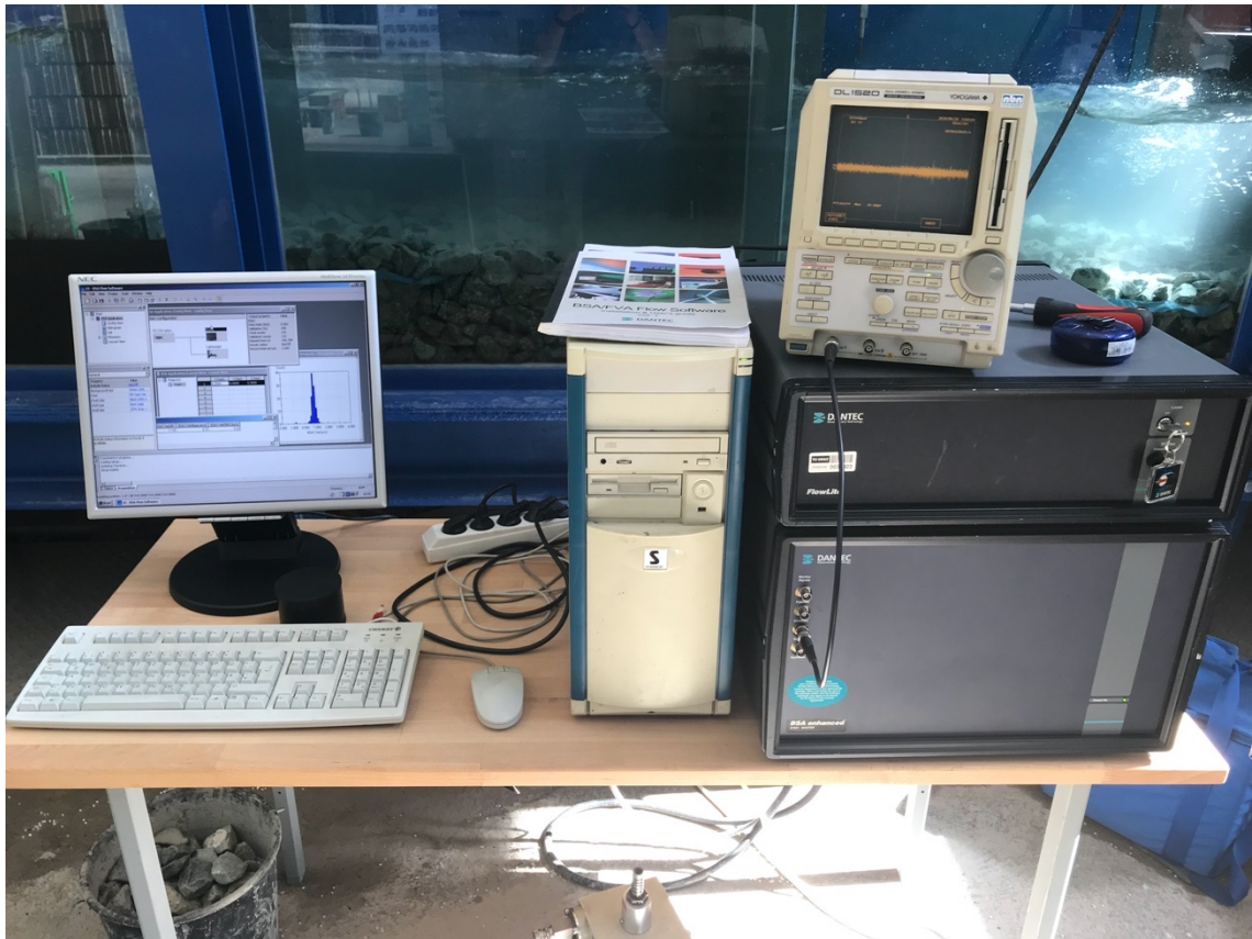
Abbildung 36: Laser Doppler Anemometry (LDA) Messinstrumente
