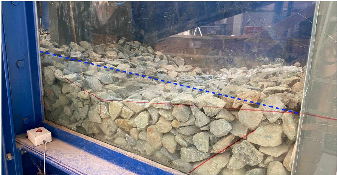
Abbildung 30: Sohlsubstrat TB mit fiktivem Einheitsgefälle (blaue Strichlinie)
