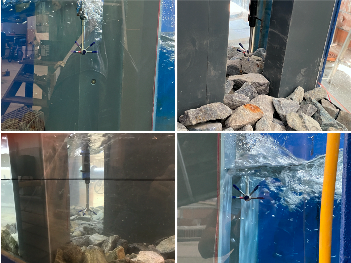
Abbildung 52: Durchführung der Messungen mit Vectrino-Sonden
