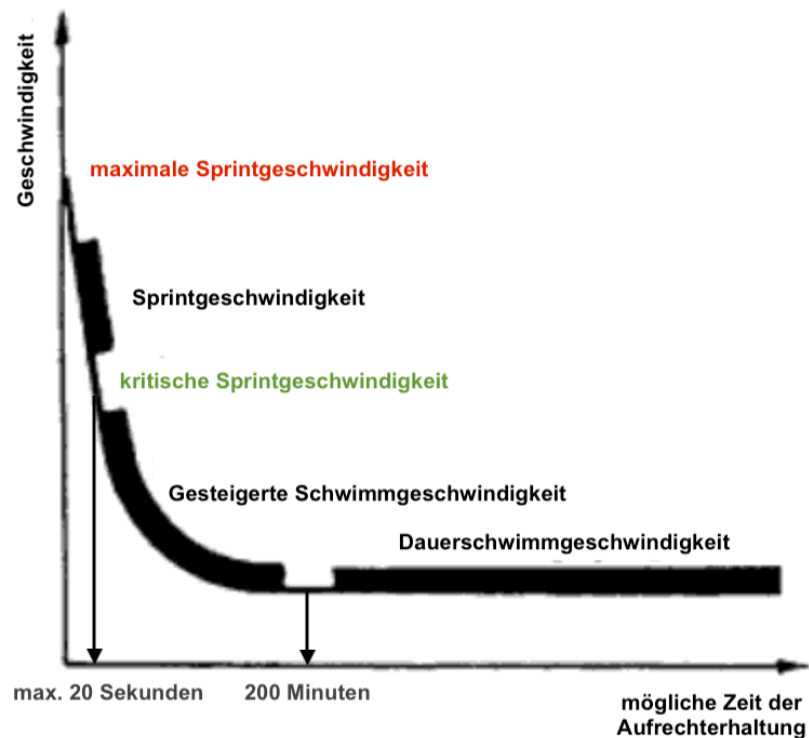
Abbildung 1: Schwimmleistungen von Fischen (Pavlov 1989, verändert)
