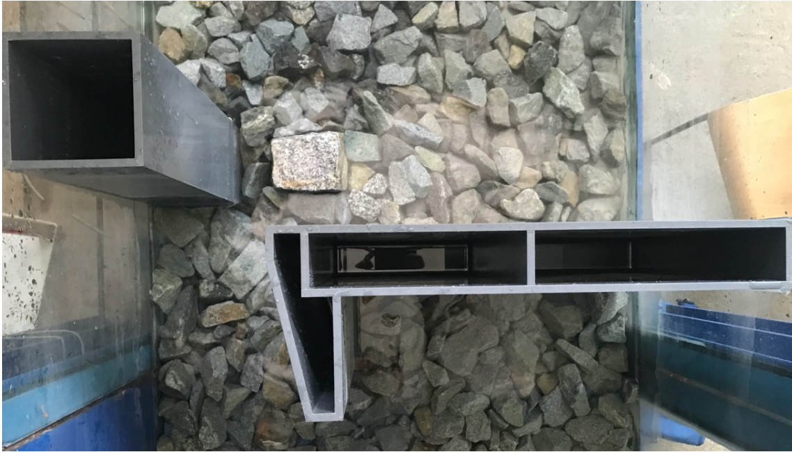
Abbildung 21: Trennwand im Vertical Slot Modellaufbau
