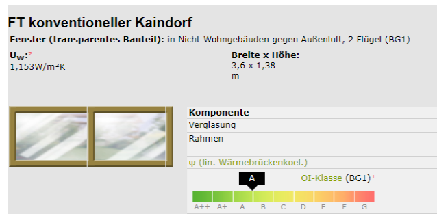
Abbildung 3.49: konventionelles zweiteiliges Fensterelement mit einem offenbarem Flügel, Kaindorf
