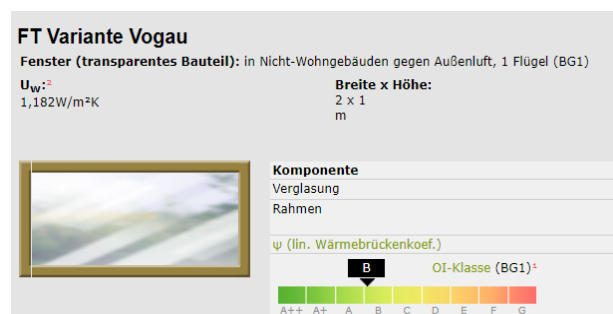
Abbildung 3.59: variantes einteiliges Fensterelement mit einem offenbarem Flügel , Vogau
