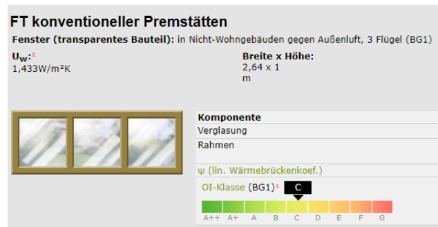
Abbildung 3.53: konventionelles dreiteiliges Fensterelement mit einem offenbarem Flügel mittig, Premstätten
