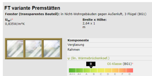
Abbildung 3.54: alternatives dreiteiliges Fensterelement mit einem offenbarem Flügel mittig, Premstätten
