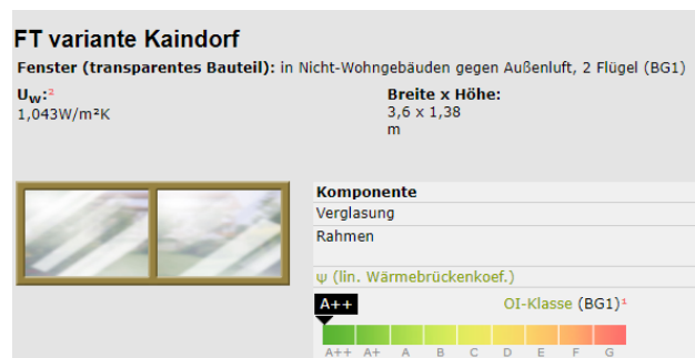
Abbildung 3.50: alternatives zweiteiliges Fensterelement mit einem offenbarem Flügel, Kaindorf
