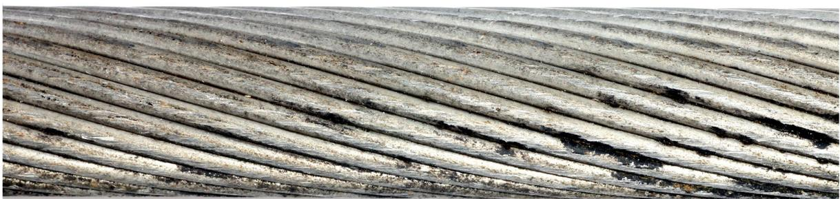
Bild A.2: Stark gealtertes Leiterseil ( $d = 29$  mm)
