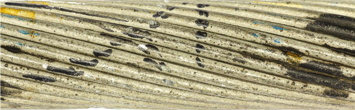
Bild A.3: Stark gealtertes Leiterseil ( $d = 36$  mm)
