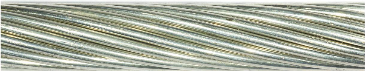
Bild A.4: Blankes, unbehandeltes Leiterseil ( $d = 22$  mm)
