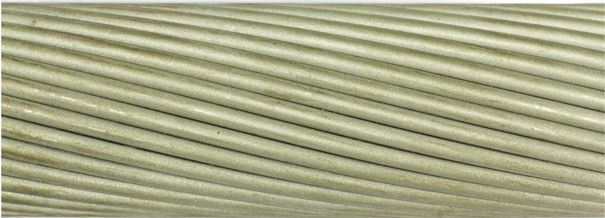
Bild A.7: Glasperlgestrahltes Leiterseil ( $d = 50$  mm)
