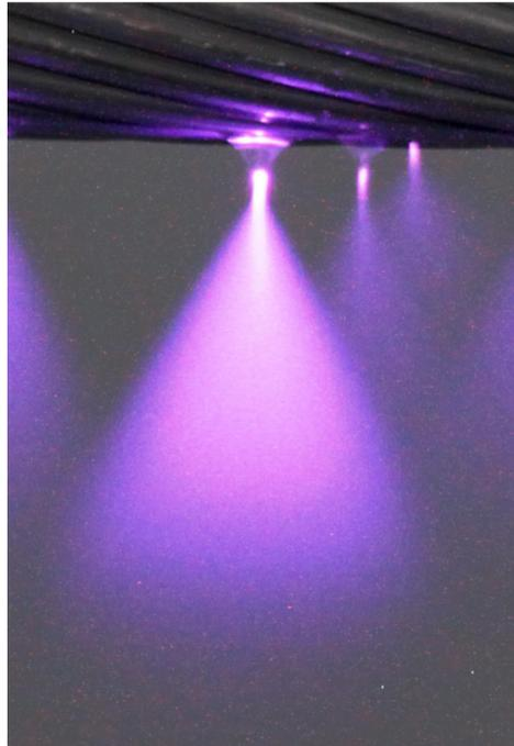
Bild 3.9: Entladung an einem verformten Wassertropfen
