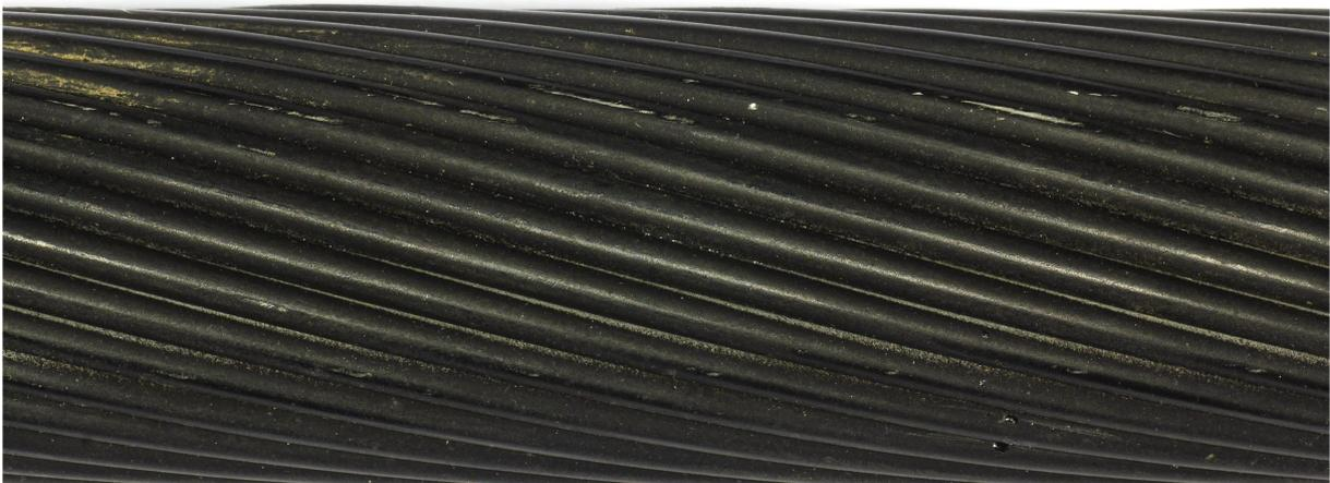
Bild A.8: Leiterseil mit hydrophiler Farbbeschichtung ( $d = 50$  mm)
