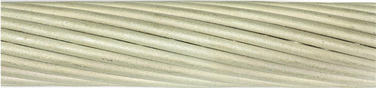
Bild A.6: Glasperlgestrahltes Leiterseil ( $d = 27$  mm)
