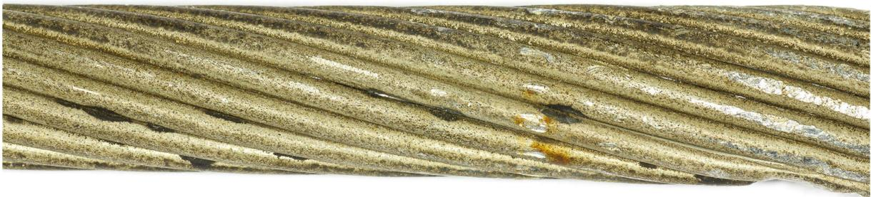
Bild A.1: Stark gealtertes Leiterseil ( $d = 22$  mm)
