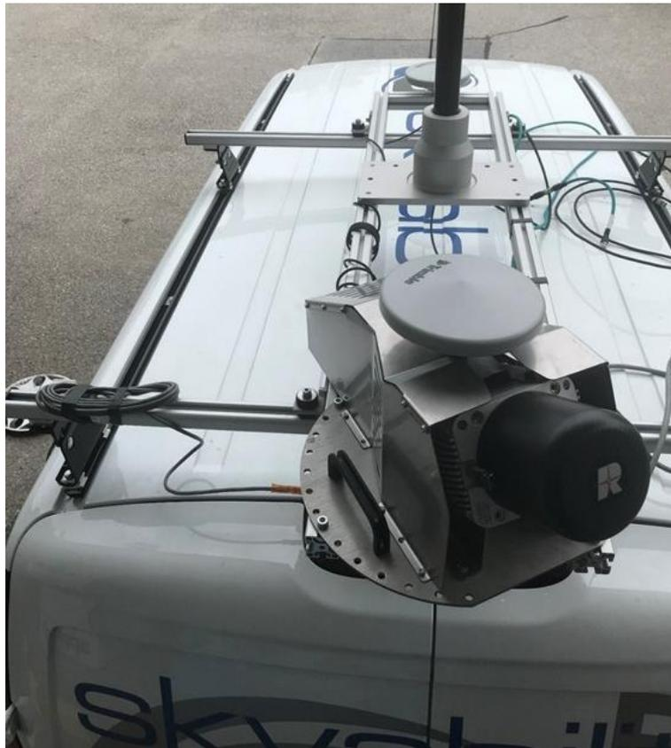
**Abbildung 13** - Einrichtung der Plattform beim Riegl MMS Aufnahme (Foto: Skyability)
