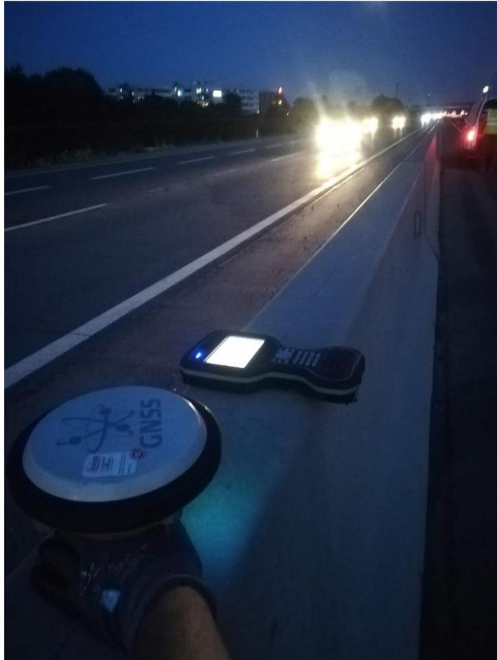
**Abbildung 10** - Überprüfung der bestehenden Vermarkung
