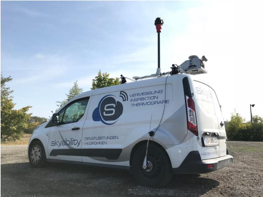
**Abbildung 12** - Riegl VUX-SYS MLS Installation auf dem Skyability-Fahrzeug (Foto: Skyability)
