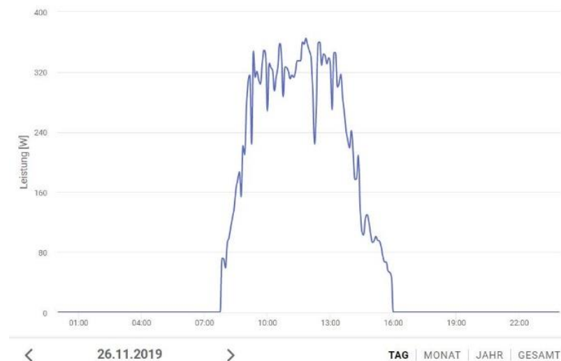
Abbildung 5.2: Tagesgang einer Photovoltaikanlage im November bei trübem Wetter [79]
